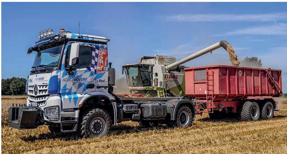
9. kép. Mercedes-Benz Arocs 2051 AK 4x4 „Agro-Muver” nyergesvontató mezőgazdasági pótkocsival (forrás:www.paul-nutzfahrzeuge.de)
