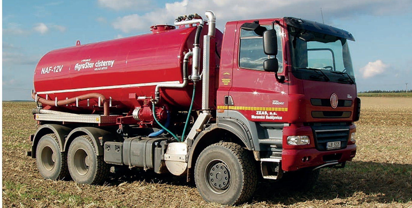
4. kép. TATRA Phoenix 6x6 Agro-Track mezőgazdasági teherautó higrágyatartály csere felépítménnyel (forrás: www.tatratracks.com )
