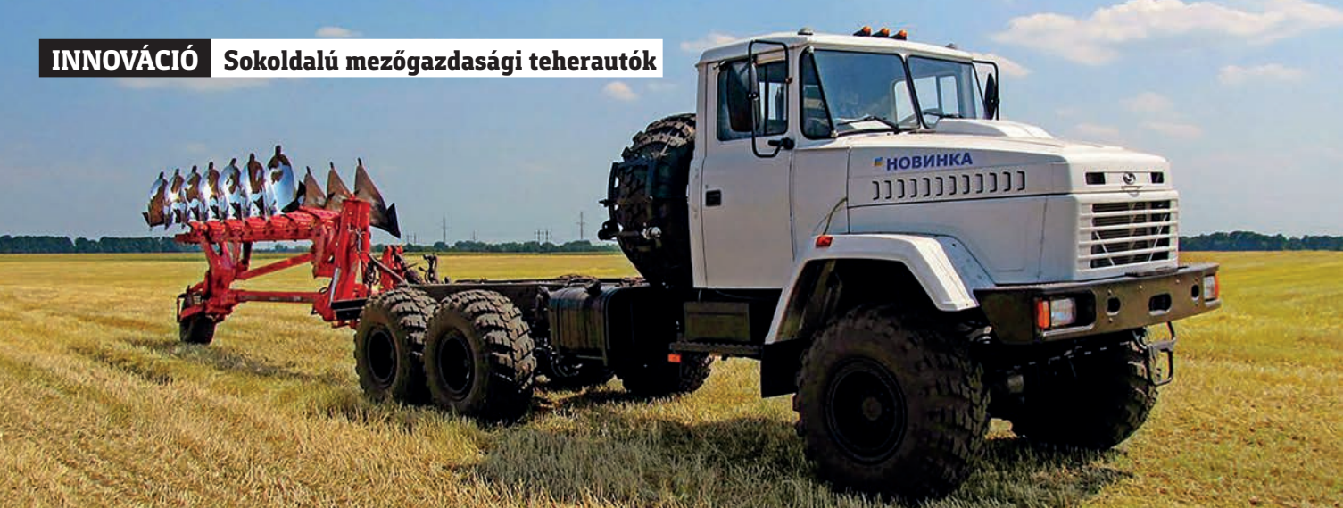
6. kép. Kraz MEZ-330 AUTOTRAKTOR félig függesztett Hektor 1000 váltva forgató 7 fejes ekével (forrás: https://tsn.ua/ru/auto/news/ukrayina/ )
