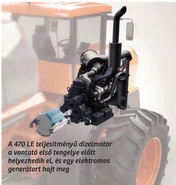
Az elektromos generátor négy független (inverter által vezérelt) elektromos motort táplál, amelyek egyenként egy-egy kereket hajtanak meg
