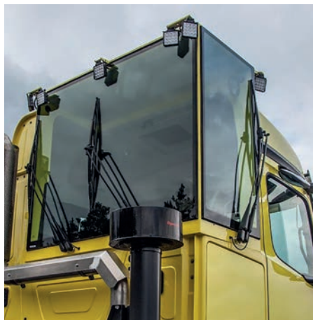
12. kép. MB Arocs panorámás hátsó kilátást biztosító vezetőfülkével (forrás: www.paul-nutzfahrzeuge.de )
