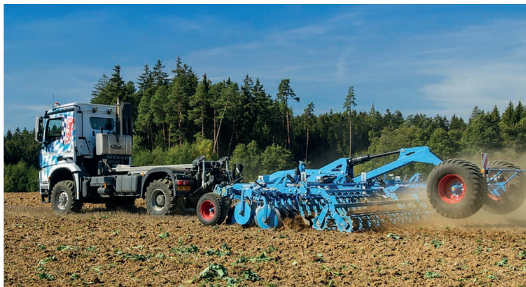
11. kép. Mercedes-Benz Arocs 2051 AK 4x4 „Agro-Muver” nyergesvontató Lemken Rubin kompakt tárcásboronával (forrás:www.paul-nutzfahrzeuge.de)
