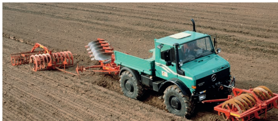
2. kép Unimog U 2100 talajművelő munkagépekkel felszerelve (forrás: https://media.daimler.com/ )
