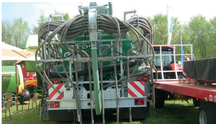
6. kép. Venturi-csöves feltöltési rendszerű tartálykocsi, lengőcsöves adapterrel
