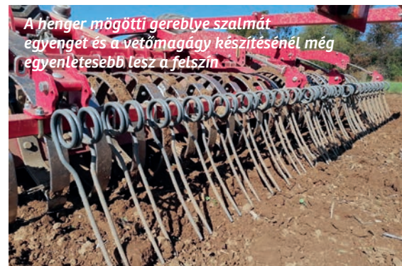
A SteelFlex henger mélyre tömörít, aprít és teríti a földet
