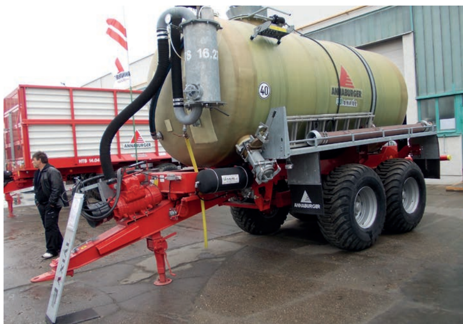
7. kép. A műanyagtartályok a korróziónak való ellenállás mellett az önsúlyt is csökkentik, vagyis nagyobb a hasznos teherbírás
