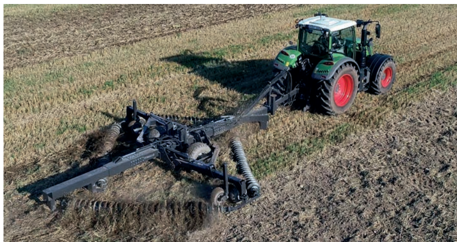
A Fliegl láncos-tárcsás borona egyedülálló módon segíti a gyökérmaradványok talajból történő teljes kiforgatását
