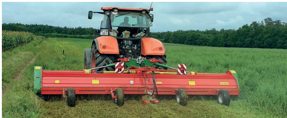
A KG 6000 szárzúzó a nagy munkaszélességgel jelentősen lerövidíti a zúzásra fordítandó időt
