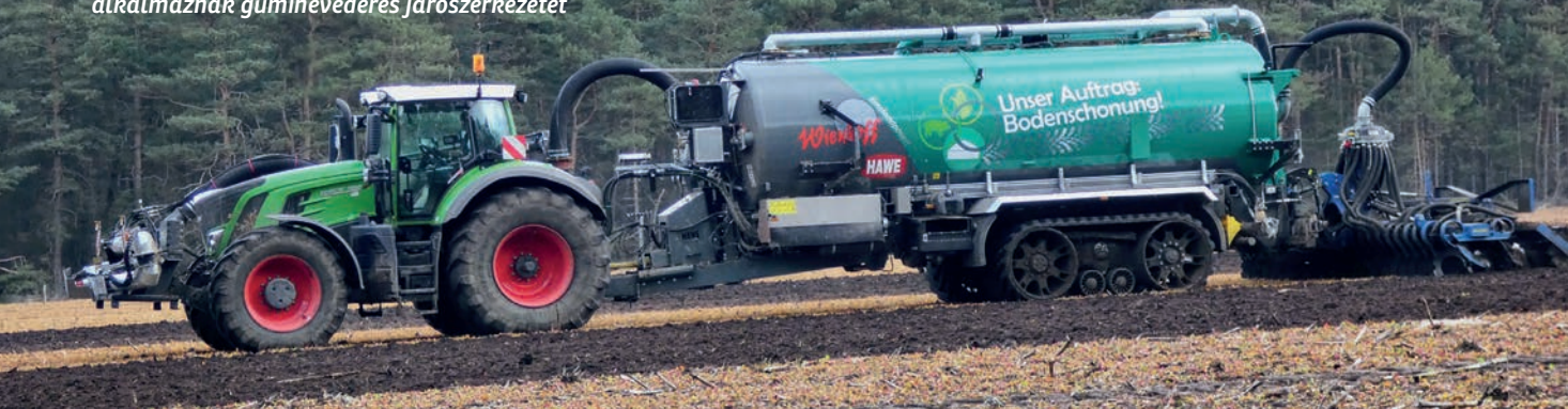
3. kép. A talajterhelés csökkentésére a tartálykocsikon is alkalmaznak gumihevederes járószerkezetet
