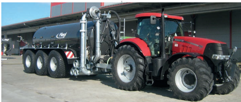
8. kép. Különböző feltöltő vagy áttöltő csövezéssel és kiegészítőkkal szerelt traktoros szerelvény
