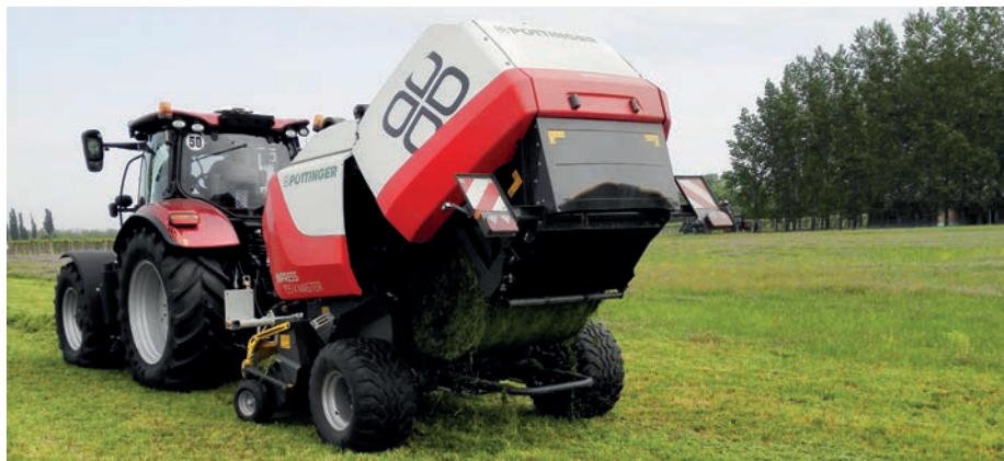
Fűszenázsbála készítése változó kamrás bálázóval
