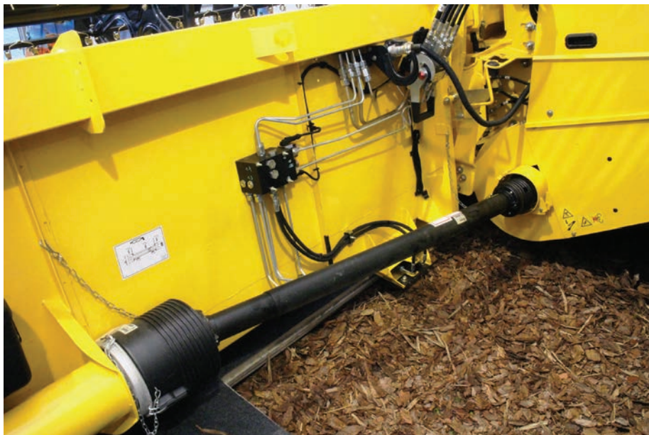
11. kép. Kombájn vágóasztalán a progresszív zsírkenés elosztásának szerelvényei (fotó: Varga V.)
