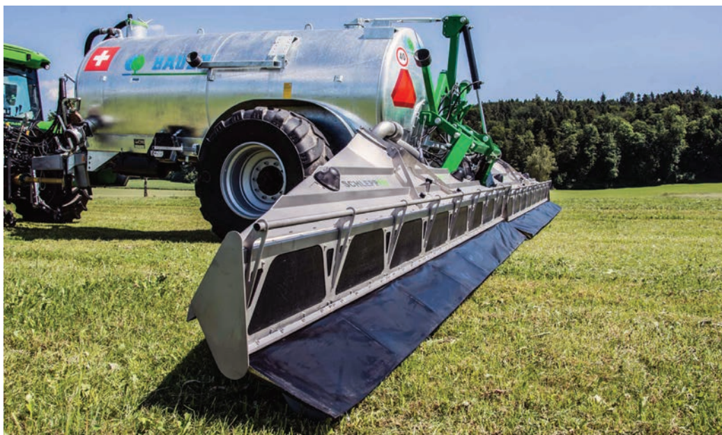
A svájci Brunner cég a Schleppfix hígtrágya-kijuttatója egy rendkívül egyszerű megoldást mutat be (fotó: https://www.schleppfix.ch/ )
