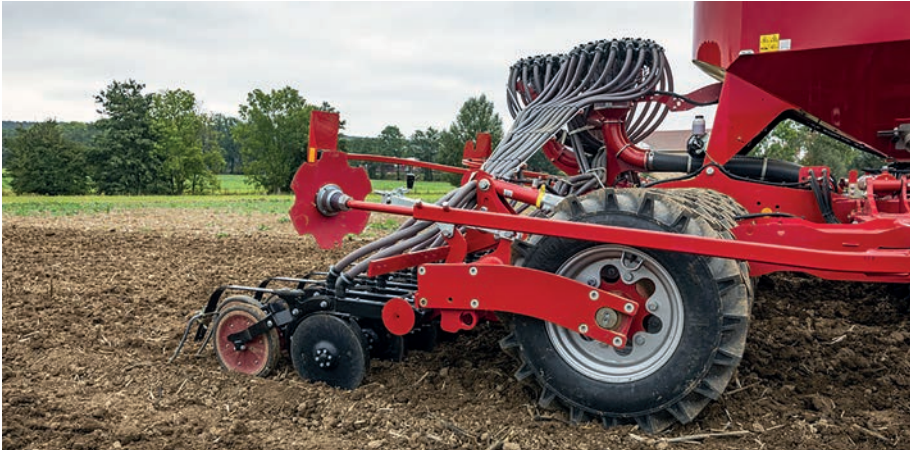
6. kép. Pronto – RowControl soronkénti lezárás – vetőmag spórlás
