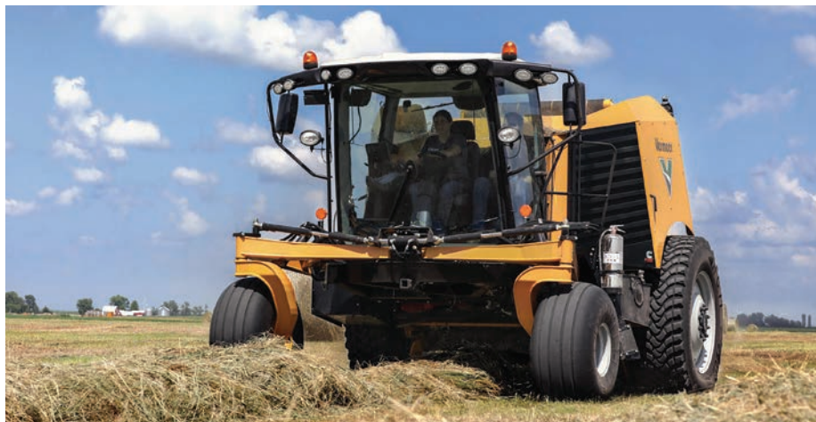
A mellső kerekek „A” alakú, független felfüggesztéssel követik a talajt
