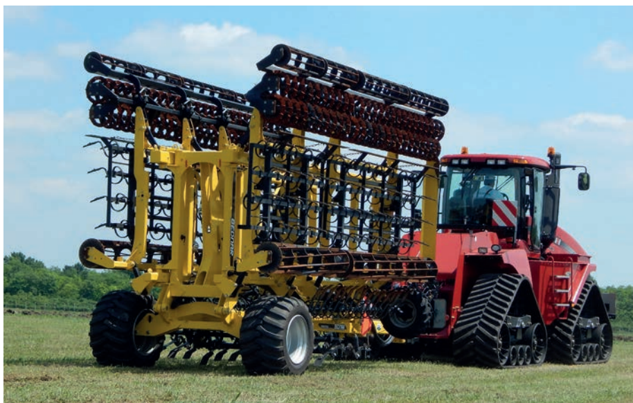
3. kép. Kombinált magágykészítő összecusukható vázkerettel
