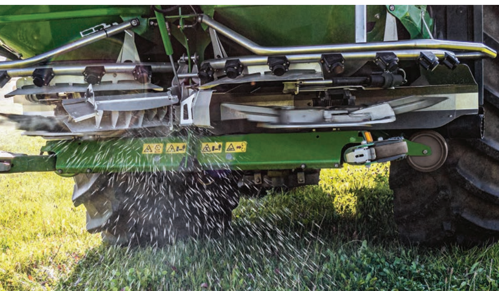
Az Amazone BorderTS határszóró ernyő aktivált állapotban (fotó: https://amazone.hu/ )
