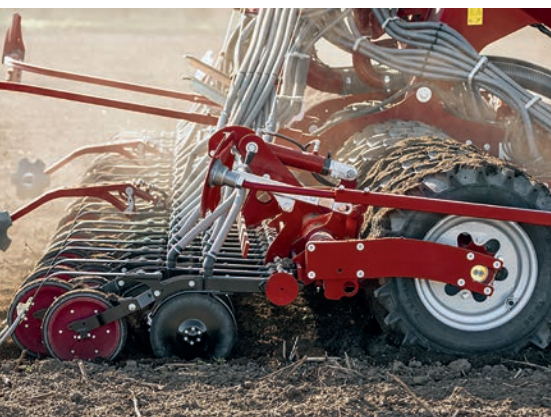
2. kép. TurboDisc III – Legújabb generációjú vetőcsoroszlya
