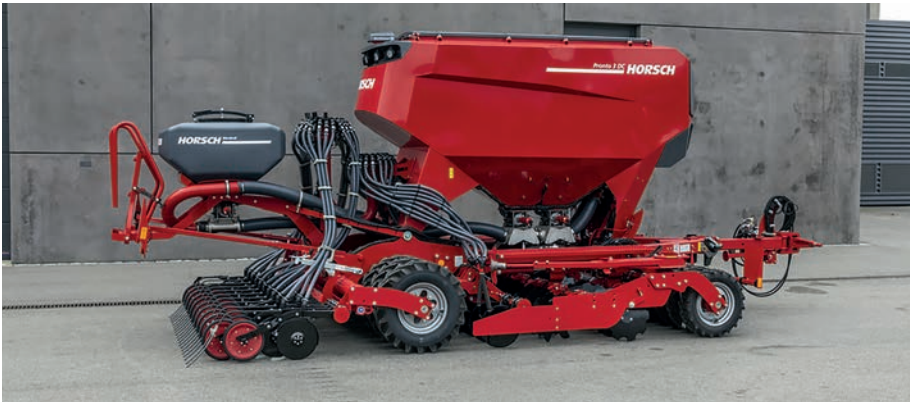
5. kép. Pronto 3 és 4 DC tartályrendszere, PPF plusz MiniDrill
