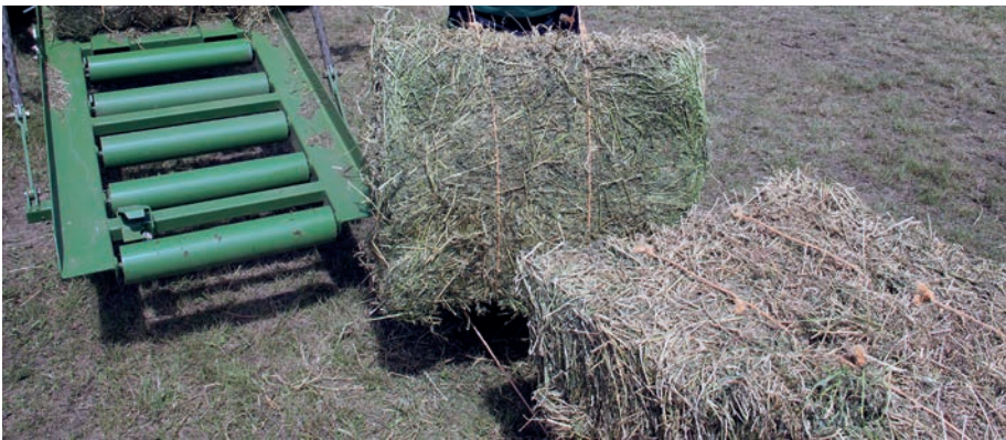
Egyes szögletes nagybálázó-konstrukciók egyetlen bálába köthetnek több, kisebb méretű hasábbálát
