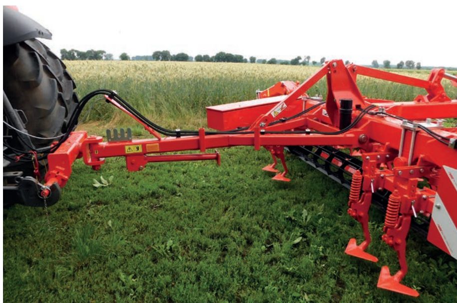
8. kép. A nyomlazítók fontos kiegészítői a kombinátoroknak
