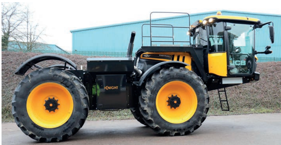
A fülke előre helyezésével lehetőség nyílt nagyobb átmérőjű kerek alkalmazására, így a hasmagasság növelésére (fotó: http://www.knight-ltd.co.uk/ )
