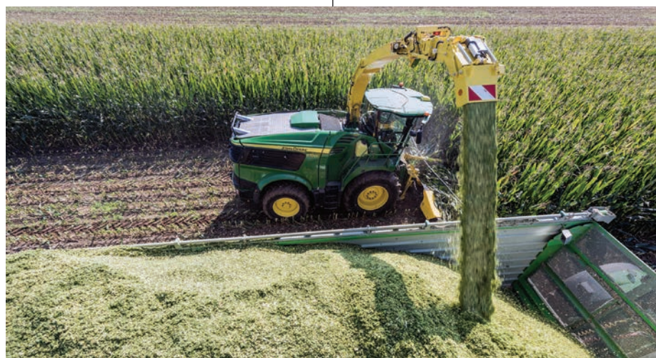
Az Active Fill Control automatán pozicionálja az ürítőtornyot a szállítójárműhöz
