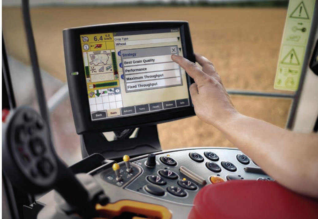
Négy automatikus beállítási mód választható ki az optimális munka érdekében
