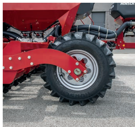
3. kép. Pronto 6 DC mellső és hátsó tömörítőkerekek megnövelt átmérővel
