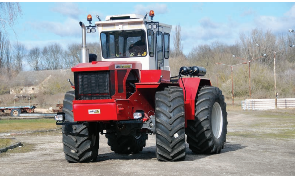
A beépített kormányzott első híddal lehetővé válik két traktorkormányzási koncepció
