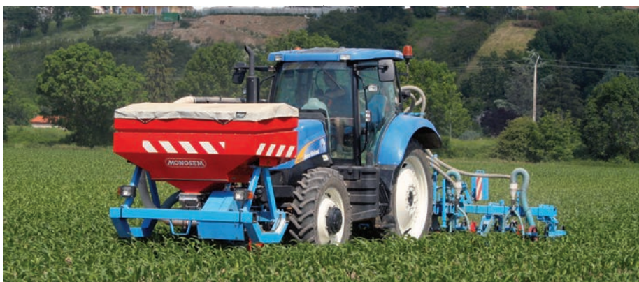
A Monosem sorközművelés és a műtrágya sorok közé történő bedolgozásának kombinációját kínálja (fotó: https://www.schleppfix.ch/ )
