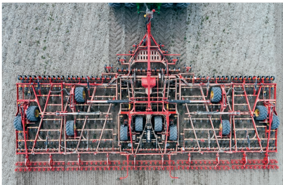
A 12-14 m munkaszélességben kapható NZ-Extreme közúton 3,5x4 méterre összecsuksva szállítható
