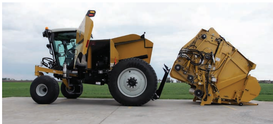
Néhány perc alatt lekapcsolható a bálakamra a kényelmes karbantartáshoz
