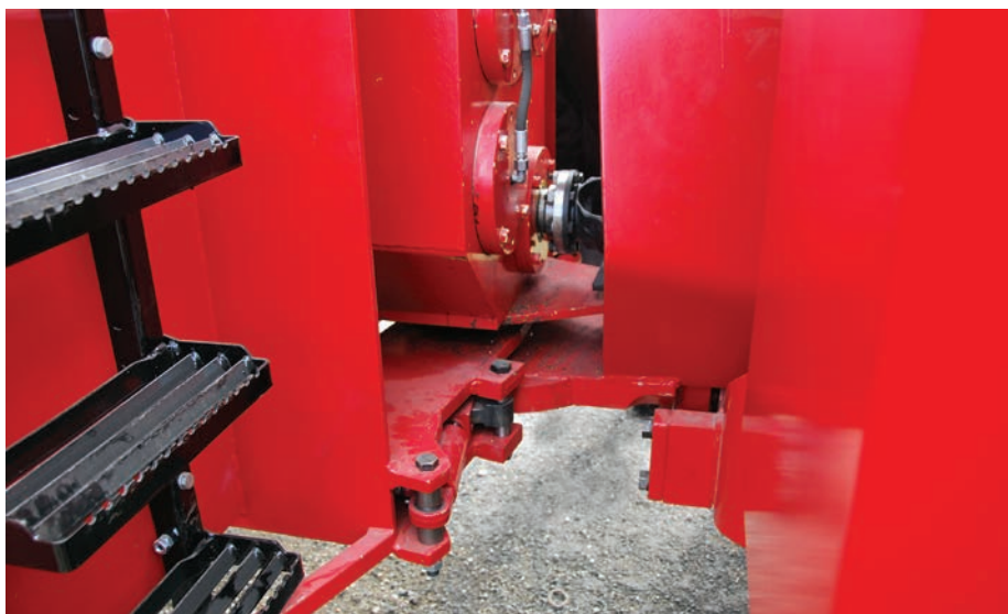
Speciális reteszeléssel rögzítjük a traktor első és hátsó traktusát
