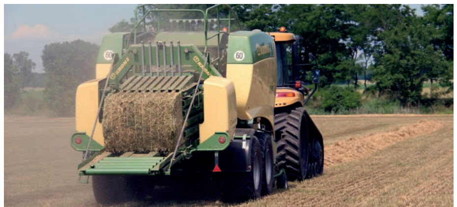
Nagynyomású szögletes nagybálázó lucernaszéna-bálázásban
