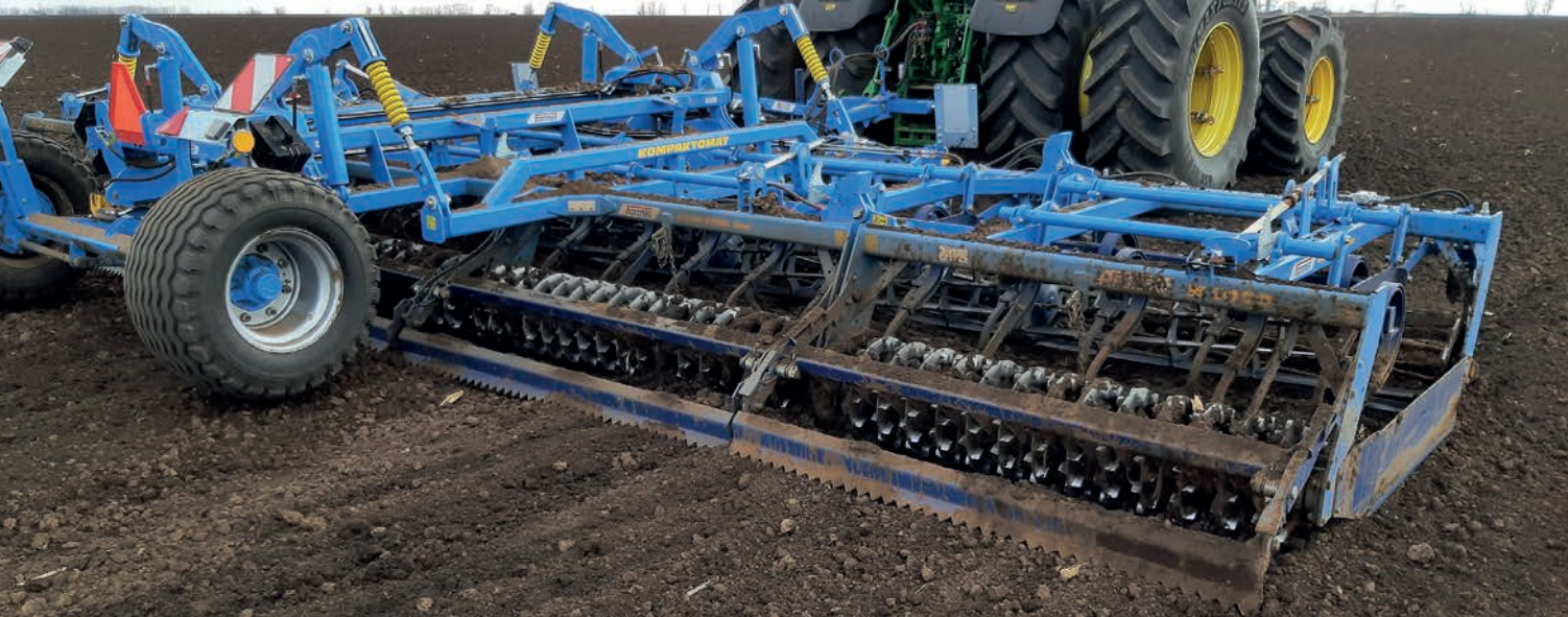
5. kép. A kapák munkáját sima vagy fűrészfogas lemezből kialakított simítók egyengetik
