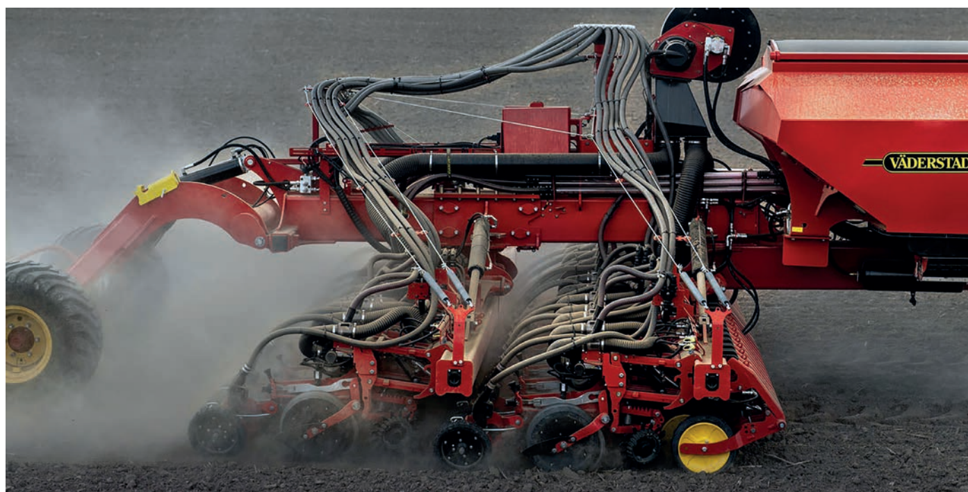
A Proceed egy szemenkénti vetőgép, ami gabonát is ugyanolyan jó minőségben veti, mint a hagyományos széles sortávú növényeket
