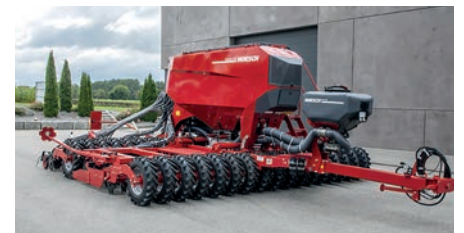
4. kép. Pronto 6 DC tartályrendszer, a ventilátor magasan a tartályban olajhűtővel
