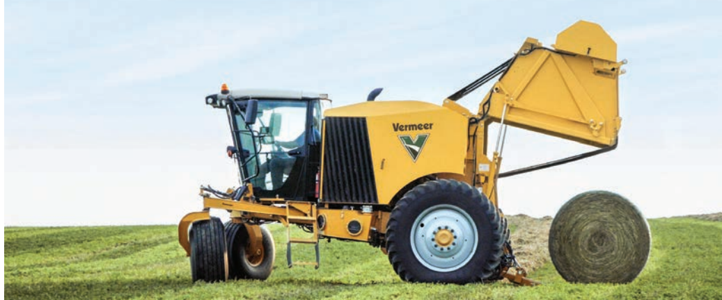
Bálakidobásnál lehetőség van a bálázó 90 fokban történő kifordulásának automatizálására
