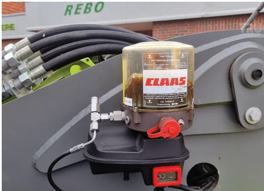
12. kép. CLAAS rakodógép központi zsíró szivattyújának elhelyezése (forrás: www.wijelo.com/wp-content )
