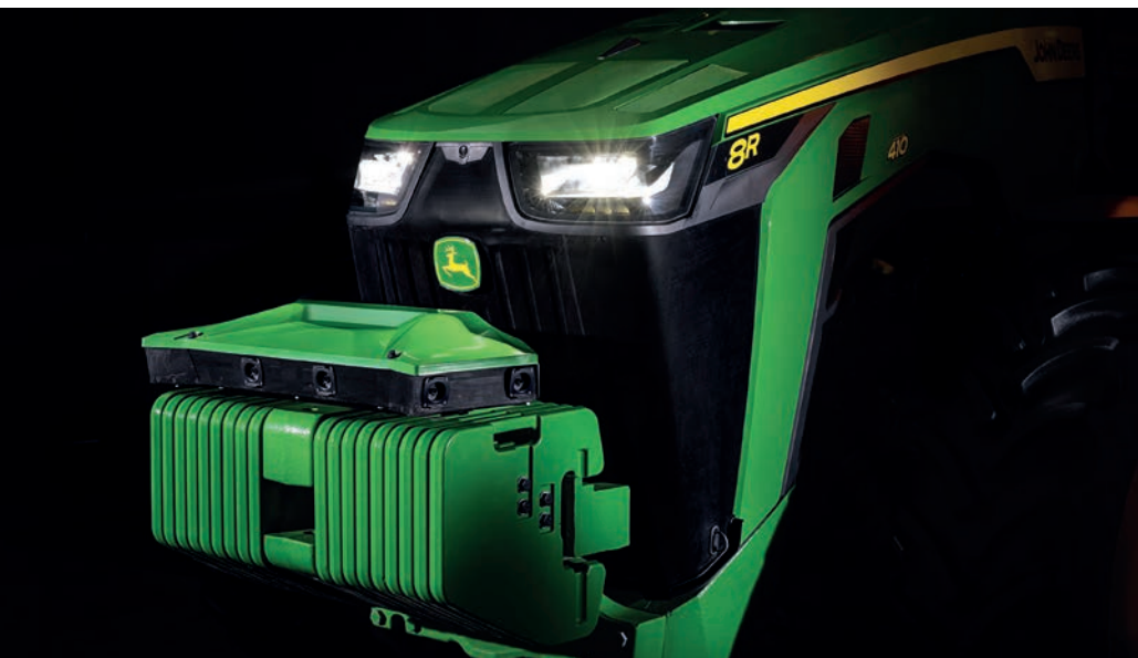
7. kép. John Deere 8R 410 autonóm traktor elején elhelyezett sztereó kamerák (forrás: https://ces2022.deere.com/ )
