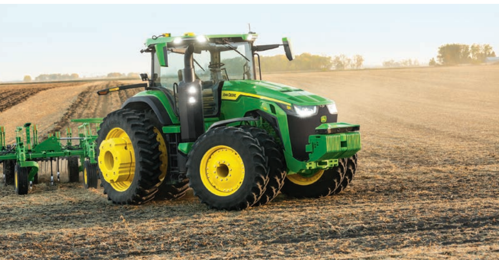
6. kép. John Deere 8R 410 autonóm traktor TruSet-kompatibilis talajlazító ekével (forrás: https://ces2022.deere.com/ )
