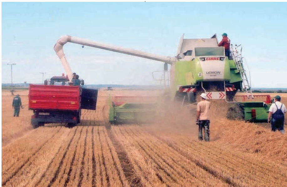
7. kép: A felműszerezett arató-cséplőgép a mérőszakaszban
