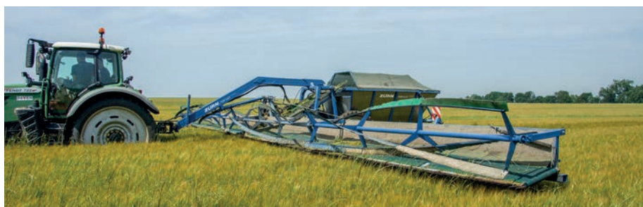
A Zürn Harvesting gyomgyűjtője, a Top Cut Collect mechanikusan bánik el a gyomokkal, nincs rezisztencia, nincs magelszóródás (fotó: http://www.zurnuk.co.uk/ )
