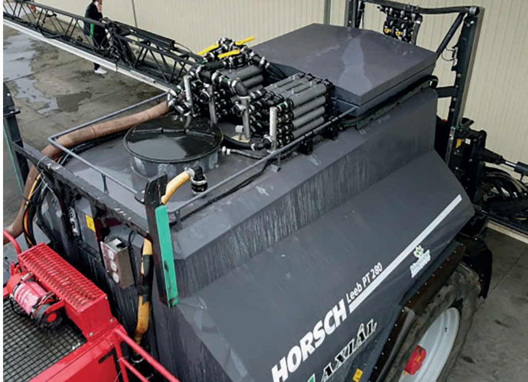
A MagGrow technológia célja a permetezéskor fellépő elsodródás csökkentése, megszüntetése
