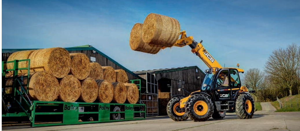
A DualTech VT sebességváltóval felszerelt többi Loadall 542-70 modellhez hasonlóan az AGRI Pro maximális emelőkapacitása 4,2 tonna, teljes magasságú emelése pedig 2,75 tonna 7,01 m magasságig
