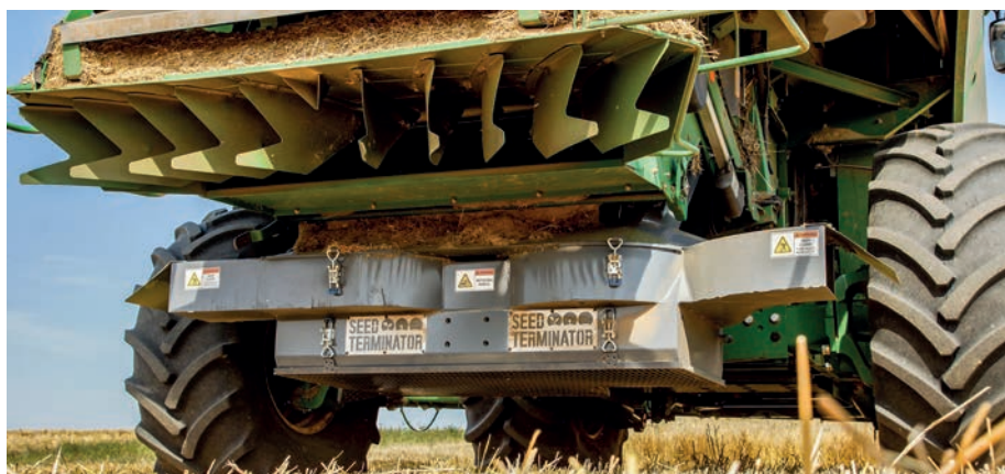
A Seed Terminator új, vegyszermentes gyomirtó-megoldás, amely már a betakarításnál gondoskodik a gyommentesítésről (fotó: http://www.zurnuk.co.uk/ )
