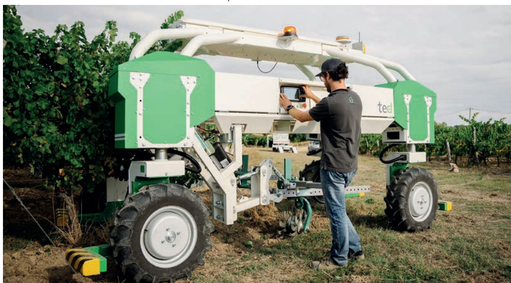
11. kép. Naio Technologies TED robot programozása GPS-RTK rendszerrel (forrás: https://www.naio-technologies.com/en/ted/ )
