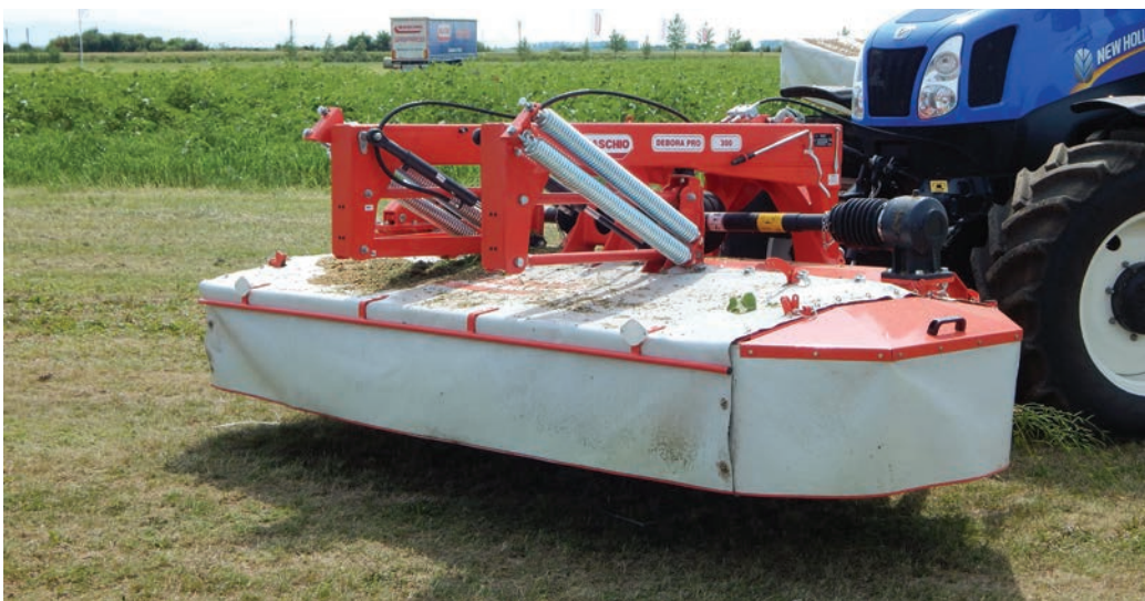
4. kép: Paralelogramma mellső függesztésű tárcsás kasza
