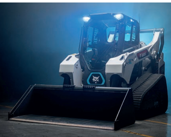
13. kép. Bobcat T7X teljesen elektromos, kompakt, gumihevederes rakodógép (forrás: www.bobcat.com/company-info/innovation/... )
