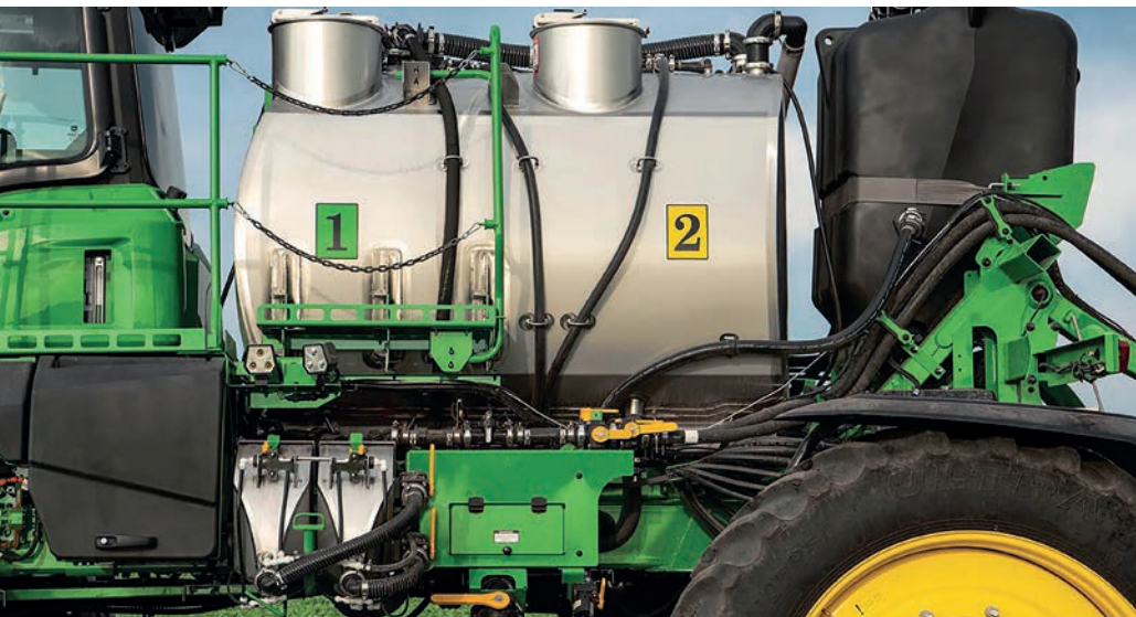
5. kép. John Deere permetezőgép, két részre osztott tartállyal (forrás: www.deere.com/en/sprayers/ )
