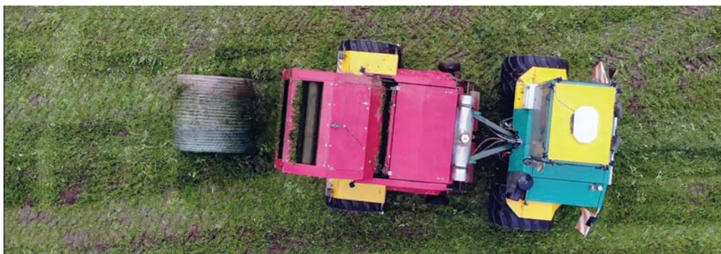
Rövid, kompakt felépítés jellemzi az önjáró bálázót
