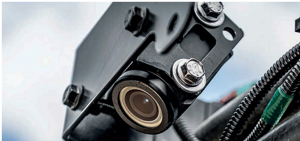
2. kép. Nagy képfelbontású, szenzoros tulajdonságú kamera (forrás: www.deere.com/en/sprayers/ )
