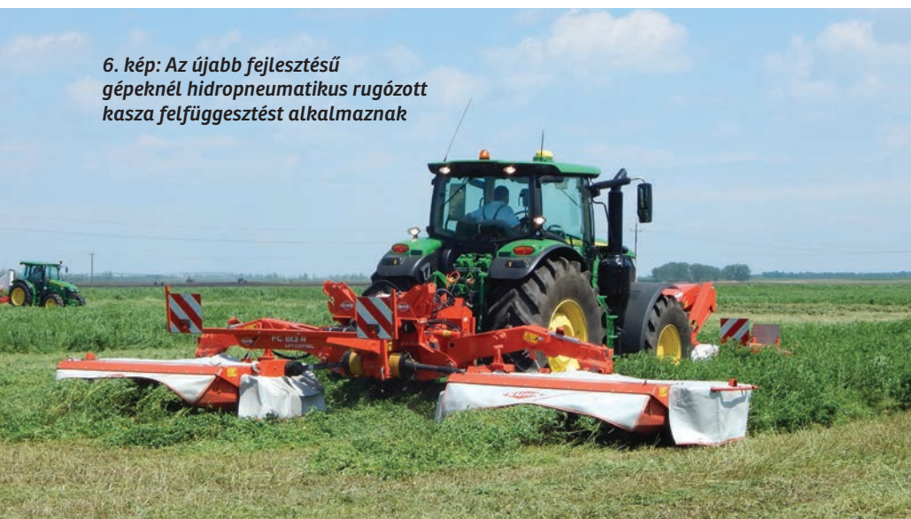
5. kép: Központi kaszagerendely felfüggesztésű tárcsás rotációs kasza
