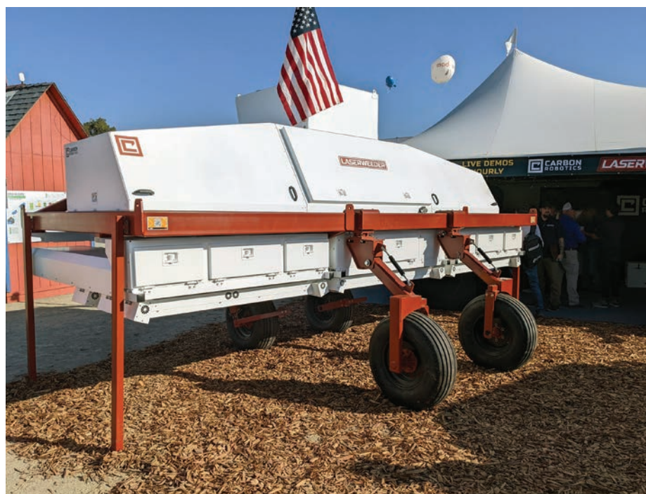
A Carbon Robotics LaserWeeder „lézeres gyomirtó” a traktor hárompontos függesztőszerkezetére csatlakoztatható (fotó: https://carbonrobotics.com/autonomous-weeder )
