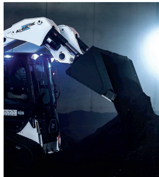
14. kép. Bobcat T7X rakodógép elektromos munkahengerekkel (forrás: www.bobcat.com/company-info/innovation/... )
