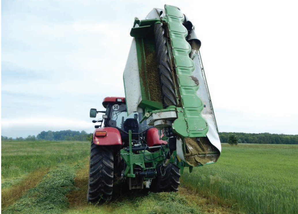
2. kép: Szársértős, tárcsás vágószerkezetű kasza szállítási helyzetben
