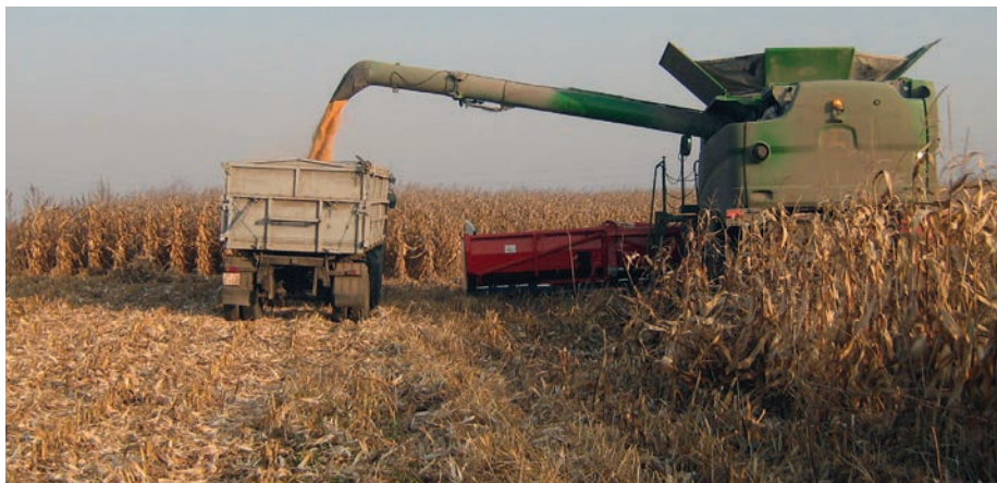
5. kép: Felműszerezett arató-cséplőgép mérése kukoricatesztben
