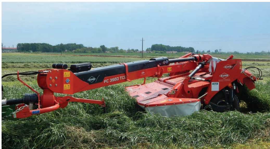
8. kép: Központi vonórúddal ellátott vontatott tárcsás kasza
