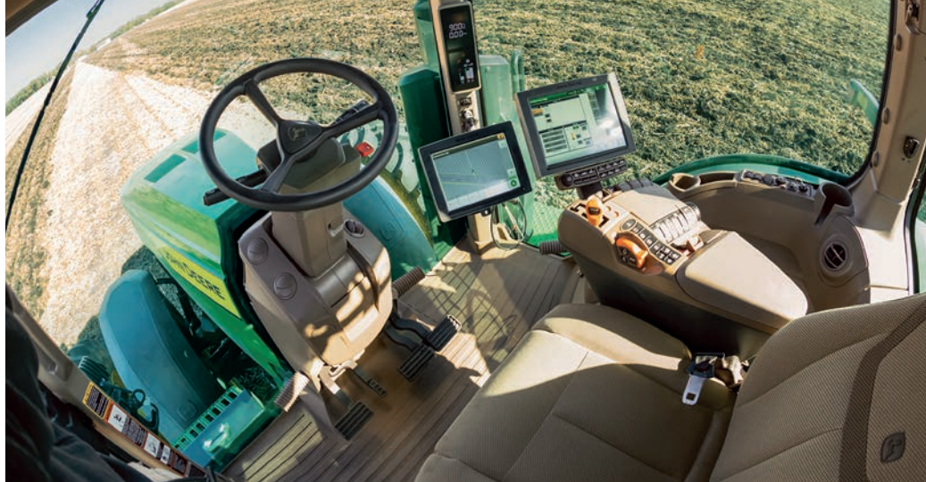
9. kép. John Deere 8R 410 autonóm traktor vezetőfülkéjének belseje (forrás: https://ces2022.deere.com/ )
