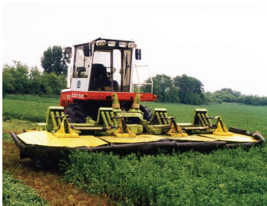
1. kép: Nagy hozamú állomány kaszálása, magajáró eszközhordozóra szerelt, 4 forgórészes, független forgórész-felfüggesztésű dobos kaszával
