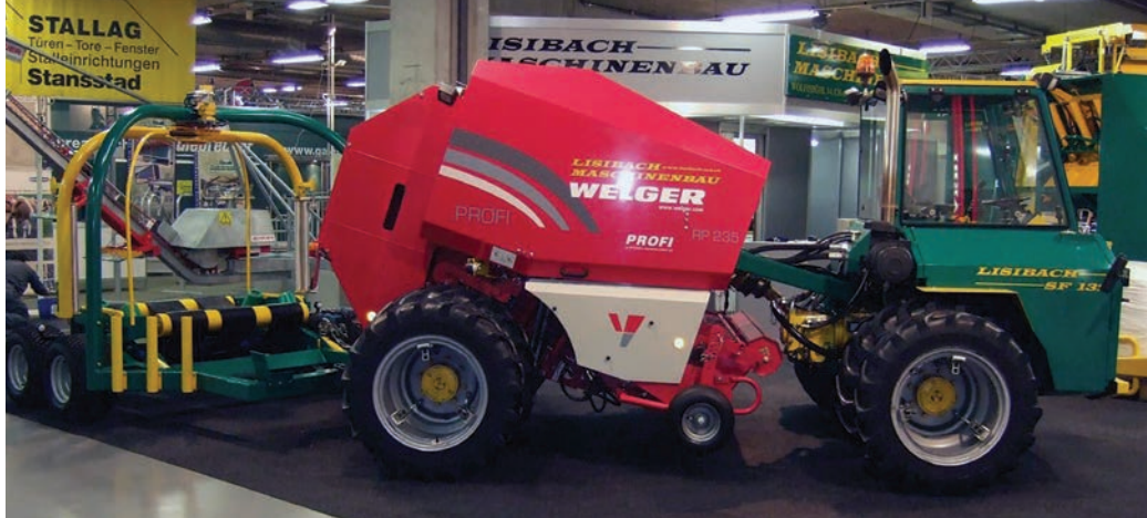
A svájci gyártó bálacsomagolójával egybekapcsolva két feladatot végezhető egy munkamenetben
