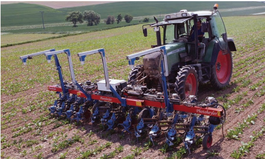
A Photoheylor innovatív rotoros koncepciója óránként 1 hektár feletti területteljesítményt tesz lehetővé (fotó: https://www.agritechnica.com/ )
