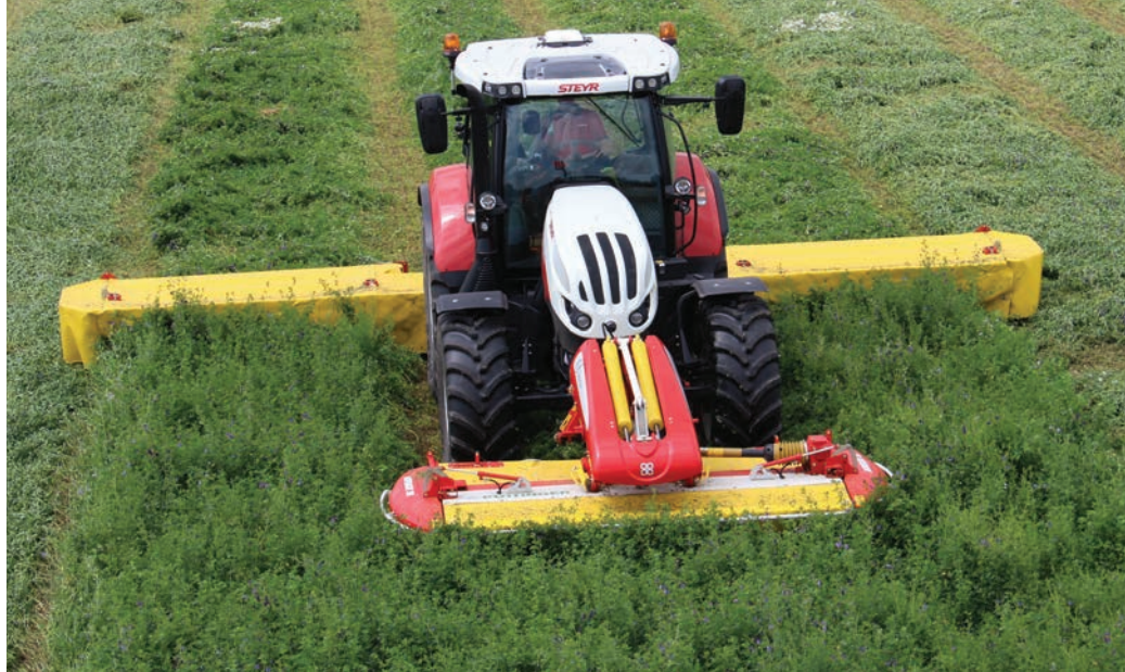
7. kép: A rotációs kaszák munkaszélessége a mellső és hátsó függesztésű gépkombinációkkal növelhető
