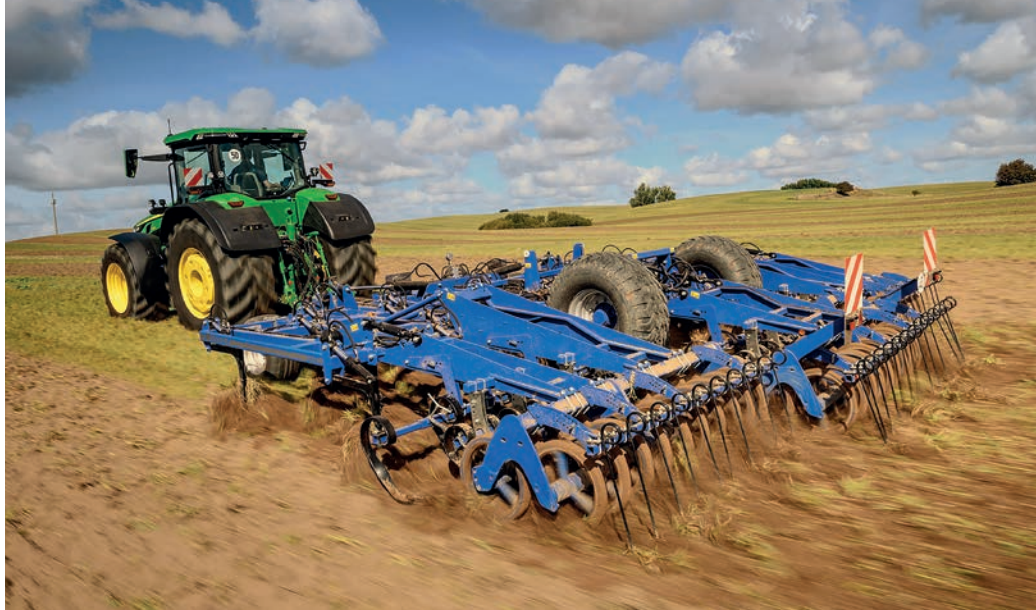
Vector hidraulikus késbiztosítással
