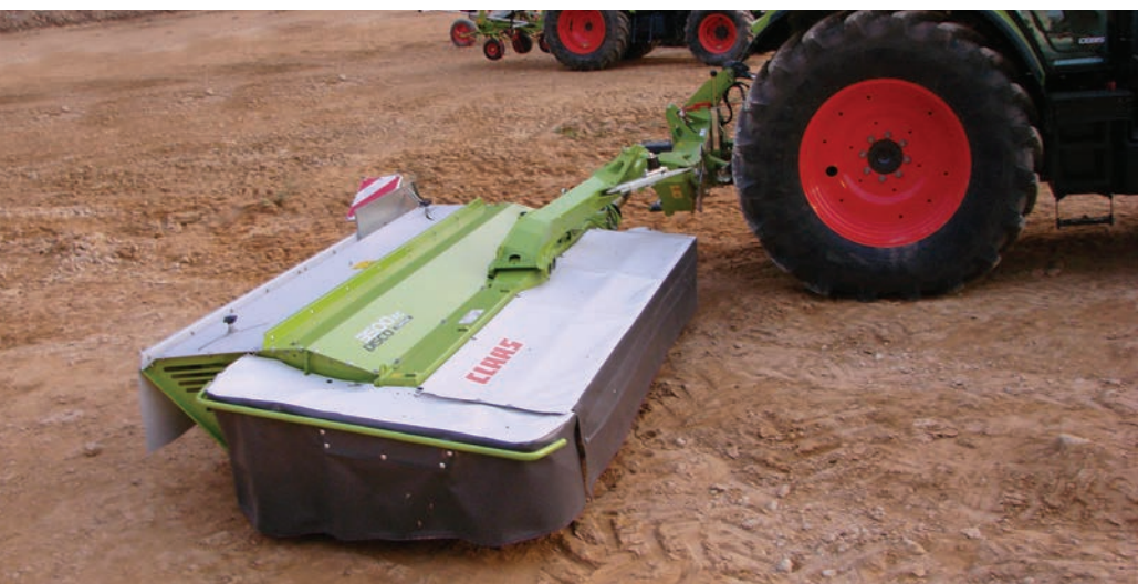
5. kép: Központi kaszagerendely felfüggesztésű tárcsás rotációs kasza
