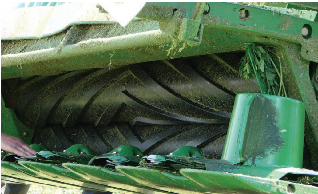
3. kép: „V” alakú, aktív profilú gumihengeres szársértő berendezés
