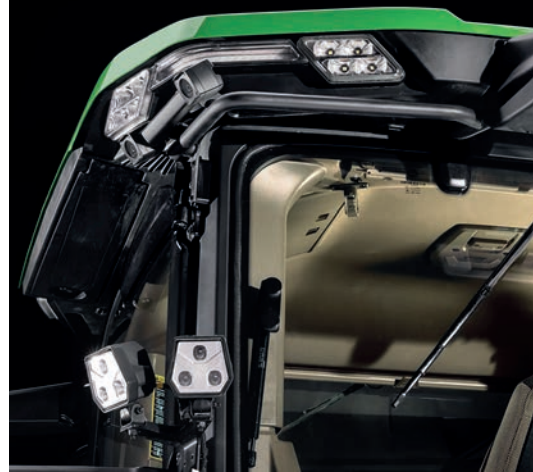
8. kép. John Deere 8R 410 autonóm traktor fülkéjén elhelyezett sztereó kamerák (forrás: https://ces2022.deere.com/ )
