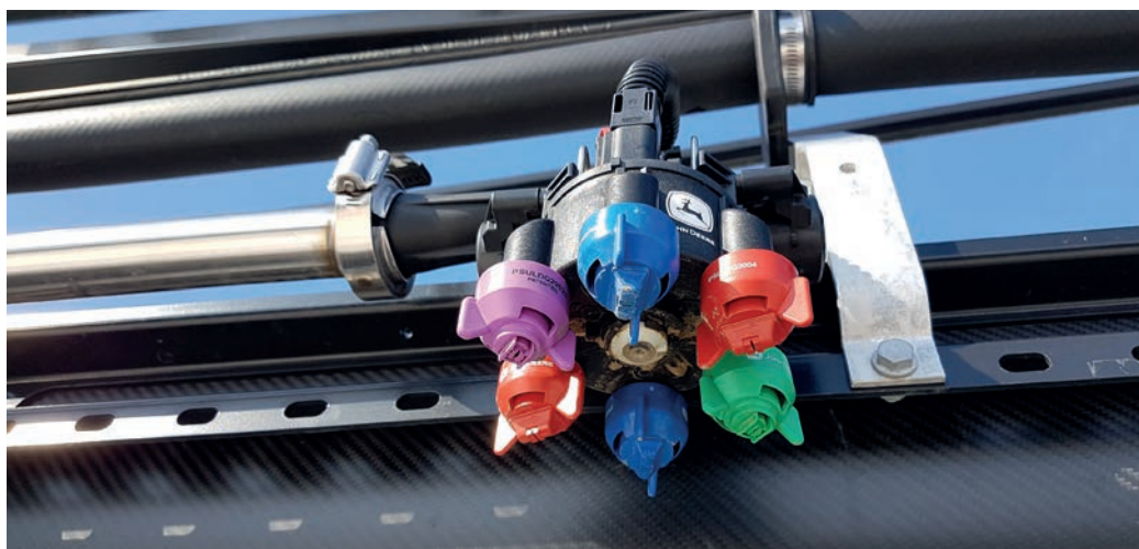
4. kép. ExactApply hatfűvőkás szóróegység (forrás: www.deere.com/en/sprayers/ )
