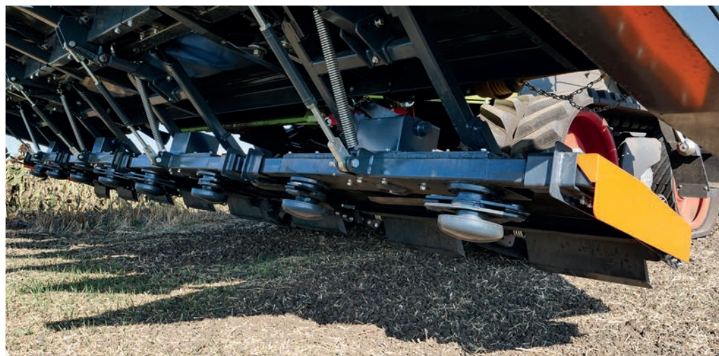
A szárzúzó egységek 2 soronként, egymástól függetlenül, szabadon mozognak
