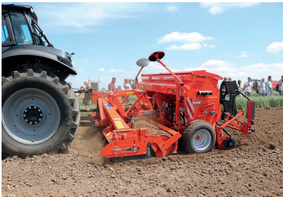
A 4 méteres KUHN HR 4004 D forgóborona és a Premia 4000 függesztett gabonavetőgép kombinációja
