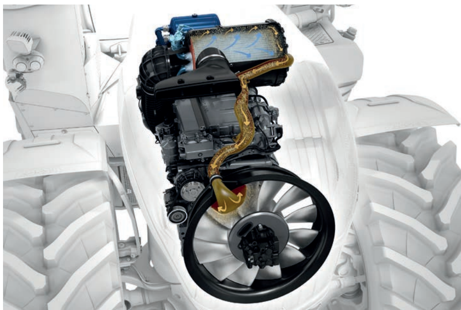
6. kép. Fendt 900 Vario és 1000 Vario traktor öntisztuló légszűrő rendszere (forrás: www.fendt.com )
