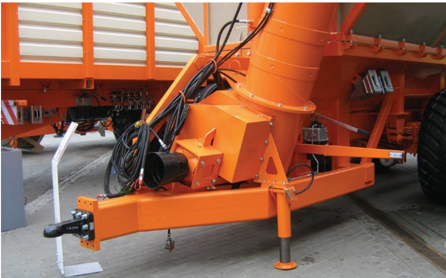
4. kép. Gyűjtő-átrakókocsi vonórúdmegoldása a hajtásátvitellel
