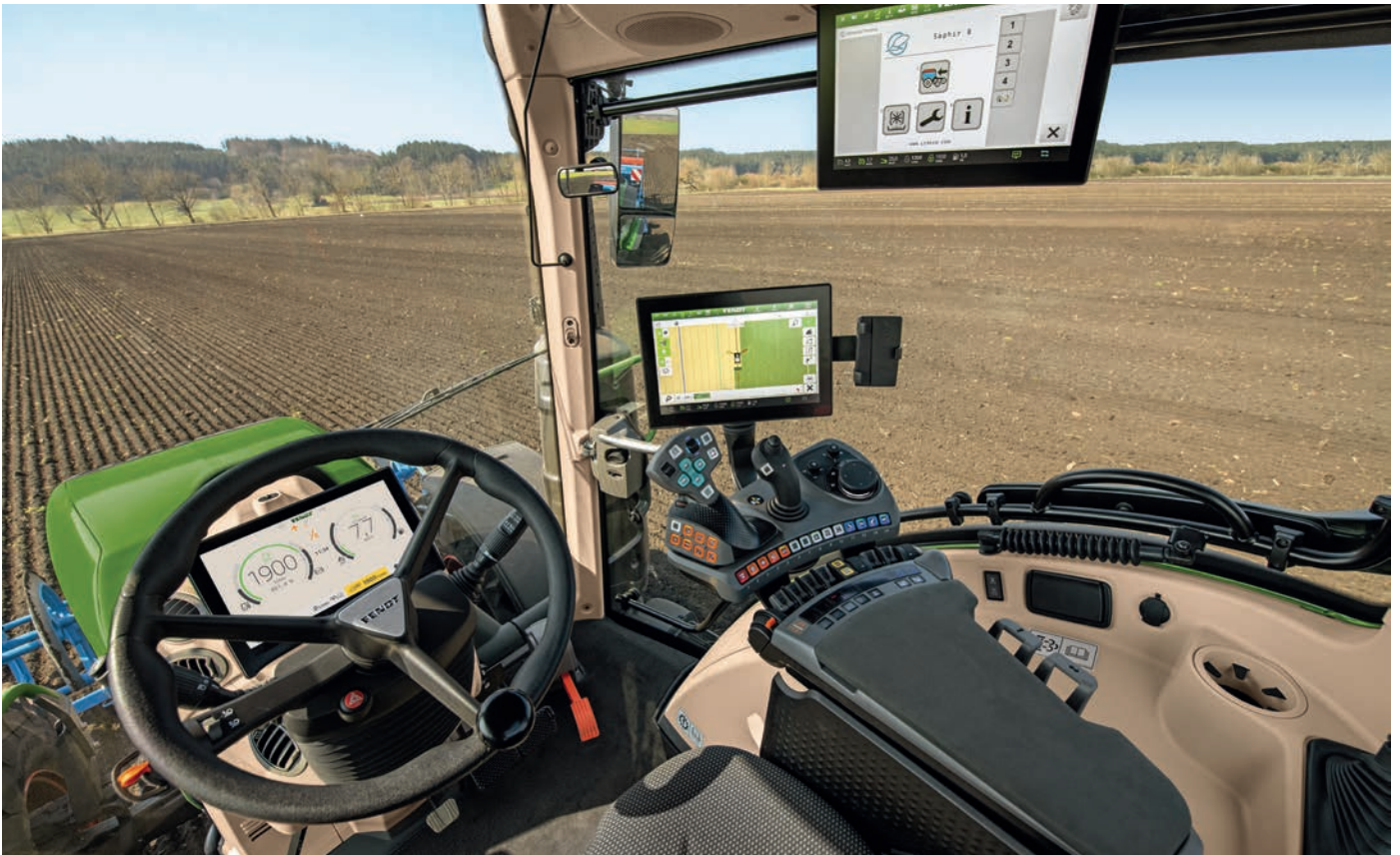
A „TIM-Steering” funkció segítségével a munkagép képes a traktor kormányzására is, nem csak a sebességének a szabályozására
