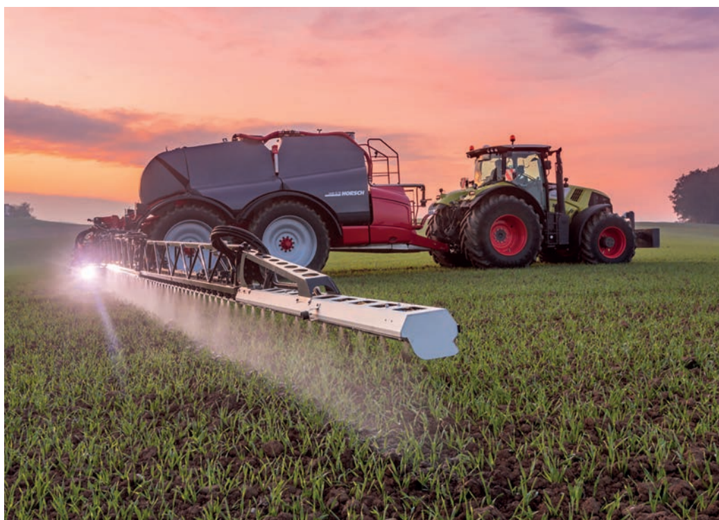
Az eredeti tényleges 25 cm fúvókaosztás, LEEB
