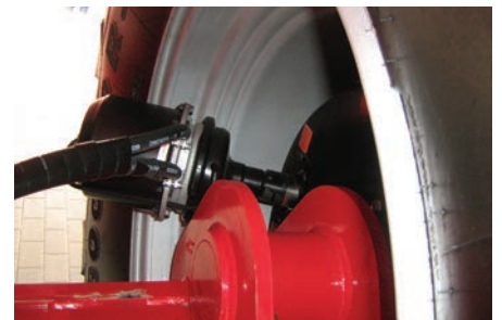
5. kép. Hajtott kerekű futóműmegoldás
