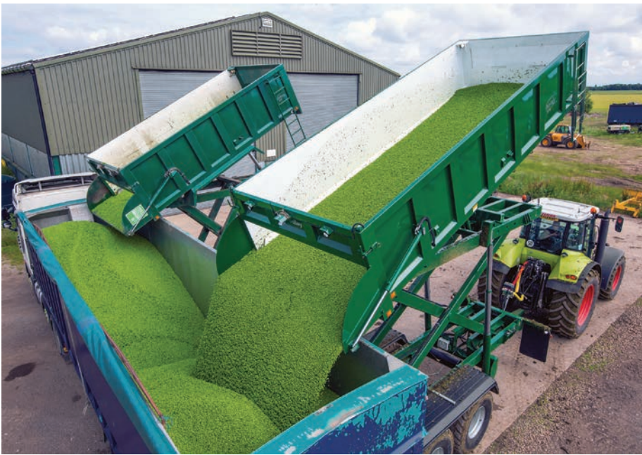
8. kép. A cukorborsó kiközelítésében és átrakódásában az emelve billenős pótkocsik jól kihasználhatók (fotó: http://www.baileytrailers.co.uk/ )
