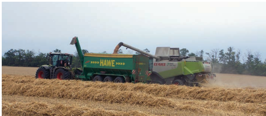
1. kép. A gyűjtő-átrakókocsik menet közbeni töltése javíthatja az arató-cséplőgépek teljesítményét
