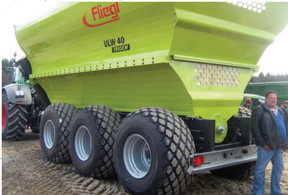
2. kép. Különleges, 40 m 3 -es kocsiszekrény-kialakítás
