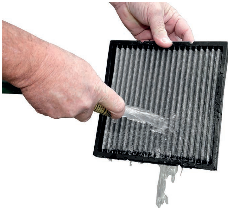
8. kép. K&N utastér levegőszűrő-betét tisztítása mosással (forrás: www.knfilters.com/cabin-air-filters ) https://agraragazat.hu/hir/a-tractorkok-levegoszuro-berendezesei/
