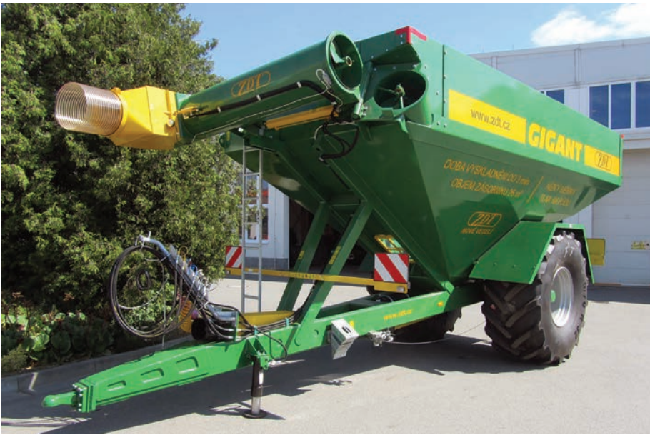
3. kép. Egyes típusoknál az átrakócsiga fix szakasza a kocsiszekrénybe van beépítve
