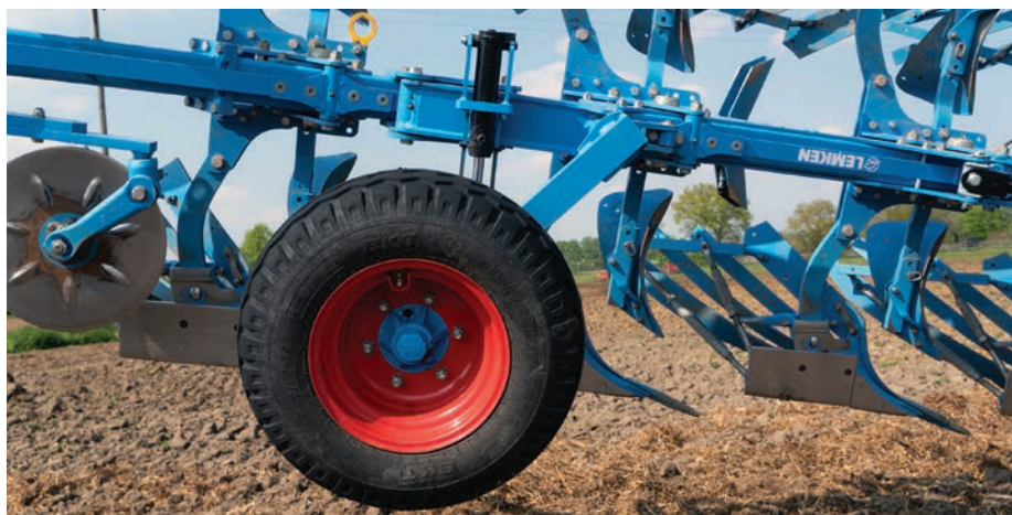
LEMKEN Juwel 6 támkerék hidraulikus felfüggesztéssel
