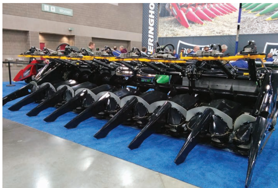
1. kép. Sortávolságra kevésbé érzékeny csőtörő-konstrukció
