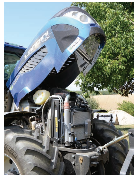
Az egyrészes motorháztető jobb hozzáférést biztosít a karbantartási munkákhoz
