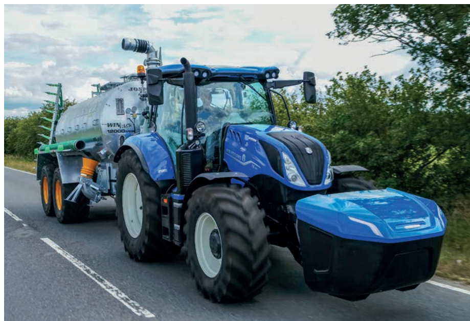
1. kép. A New Holland megkezdte a T6.180 metántraktor sorozatgyártását (forrás: www.newholland.com )
