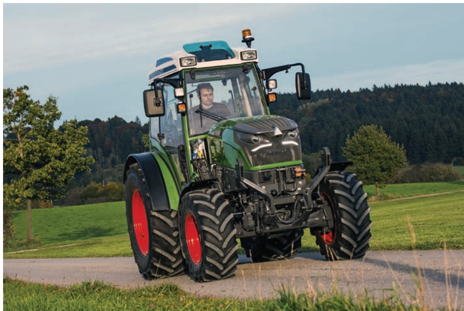
7. kép. Fendt e100 Vario típusjelzésű elektromos kompakt traktort (forrás: www.fendt.com )
