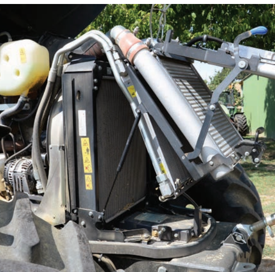
A nyitható hűtőnek köszönhetően rendkívül egyszerű a tisztítása
