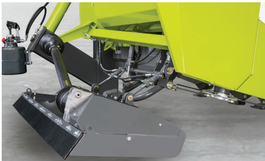
A STUBBLE CRACKER soronként egy forgó tányérral működik, amelyet két speciális kialakítású és különleges bevonatú zúzóval szereltek
