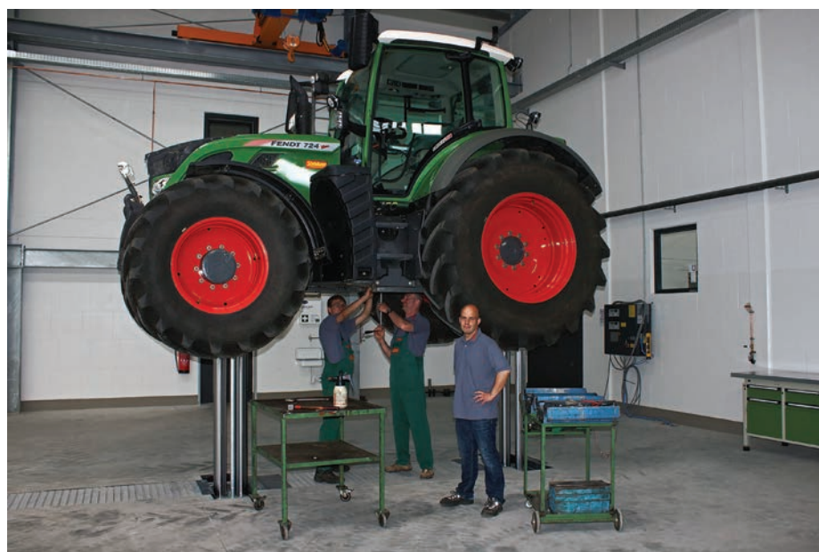
A műhelyben vagy a multifunkciós csarnok gépszerelésre berendezett sarkában a gép biztonságos szétszereléséhez megfelelő tér álljon rendelkezésre (fotó: https://www.fendt.com/ )
