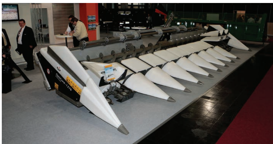
2. kép. Nagy szilárdságú szerkezeti acélok beépítésével kialakított adapter
