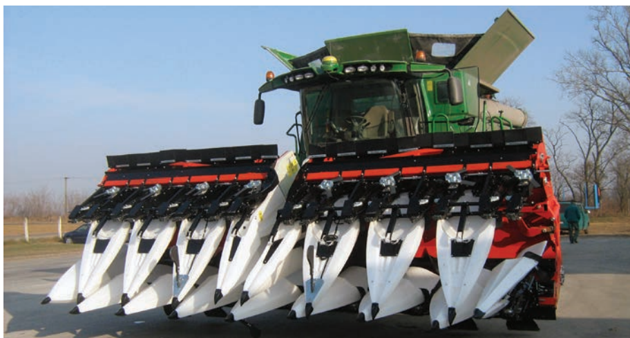
4. kép. 16 soros, összecsukható vázkeretű adapter szállítási helyzetben
