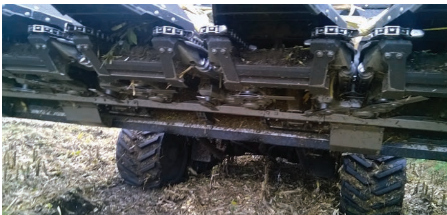
7. kép. Párhuzamosan kialakított két forgórészes zúzóberendezés beépítve
