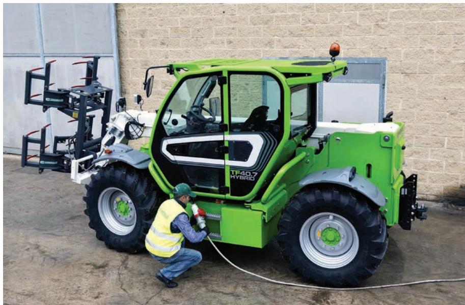
3. kép. Merlo Turbofarmer 40.7 soros, hibrid, teleszkópos rakodógép (forrás: www.merlo.de )
