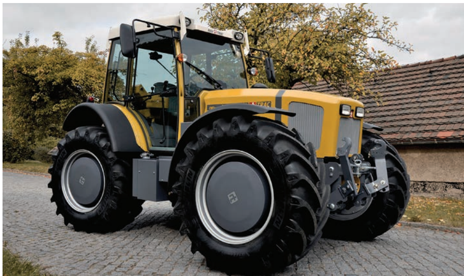
2. kép. RigiTrac WD 120 típusjelzésű, soros, 91 kW-os hibrid hajtású traktor (forrás: www.reo-it.de )
