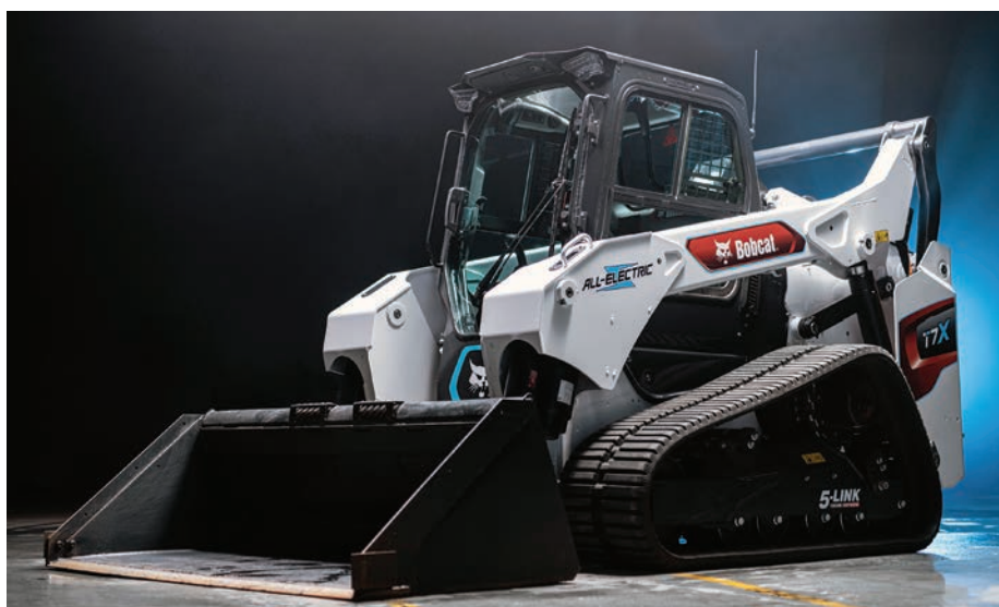
9. kép. A Bobcat T7X, teljesen villamos gumihevederes rakodógép (forrás: www.bobcat.com/company-info/innovation )
