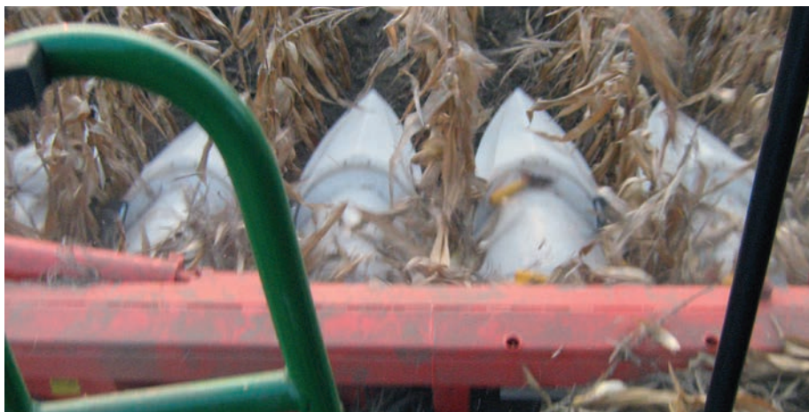
5. kép. A sorválasztó műanyag kúpok megakadályozzák a leválasztott csövek kiesését
