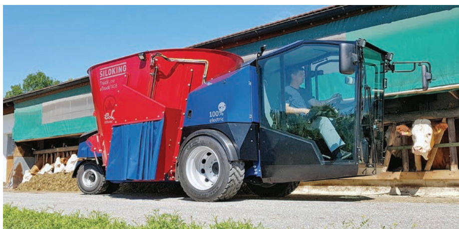
8. kép. Siloking eTruck 1408 takarmánykeverő és -kiosztó önjáró gép (forrás: www.siloking.com/en )
