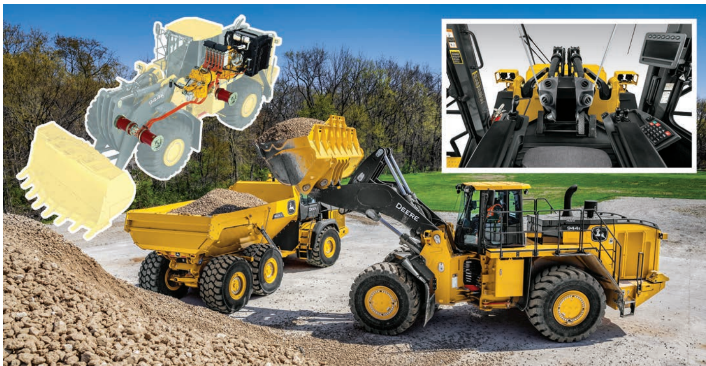
4. kép. John Deere a 944 K típusjelzésű soros, hibrid hajtású rakodógép (forrás: www.deere.com/en/construction )
