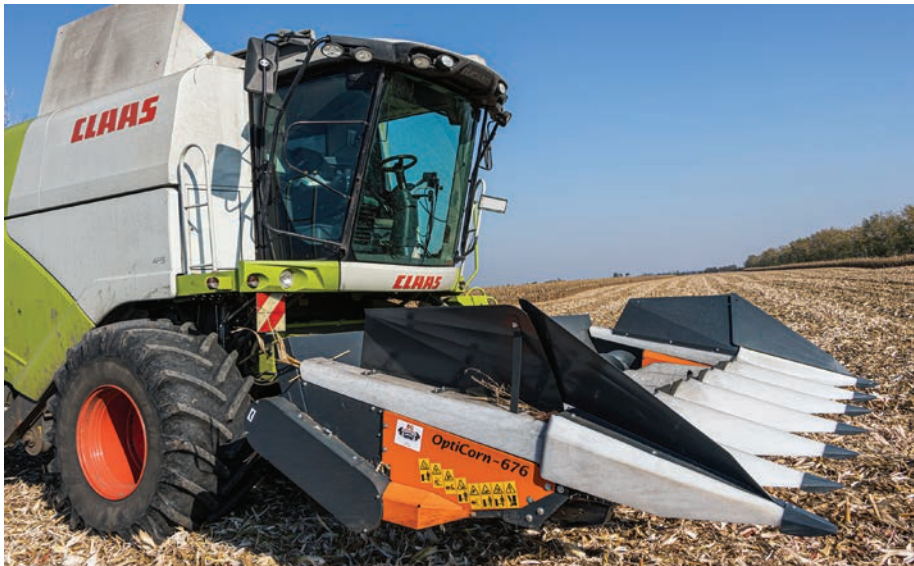
6. kép. A magas építésű oldalfalak és aktív sorválasztók is csökkentik az elhagyási veszteséget
