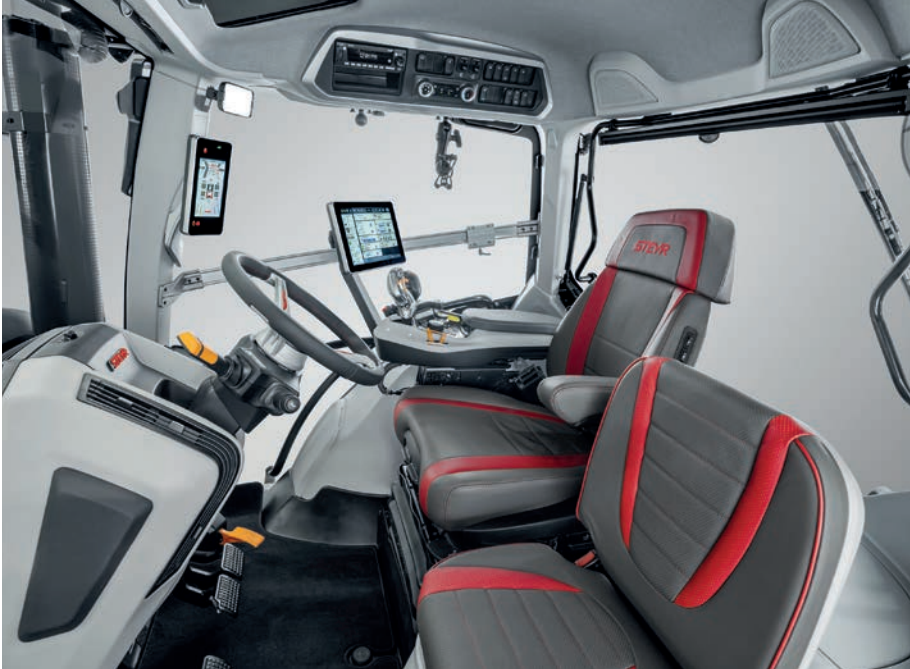
A vezetőfülke további belső fejlesztései közé tartozik az új, táblagépszerű, az A oszlopon elhelyezett kijelző, egyedi STEYR interfésszel
