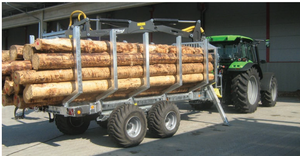
5. kép. Univerzális traktor és vontatott forgórakodós közelítőkocsi
