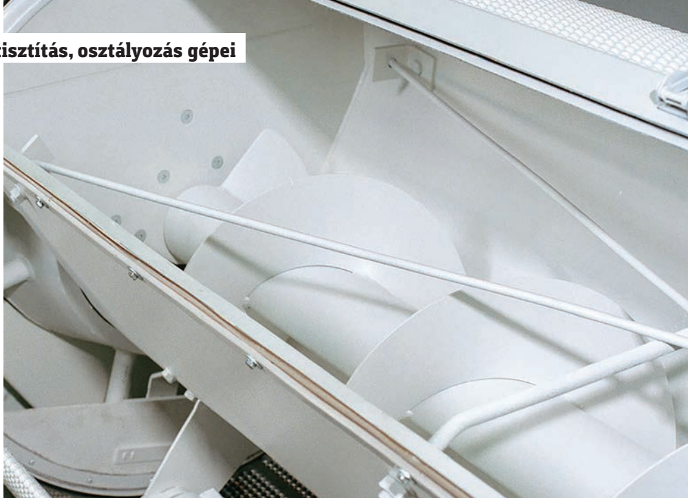
Triőr kihordócsigája (A magok hosszúság szerinti osztályozására a triőrök alkalmasak)
