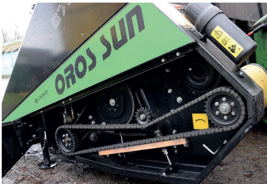
Duplex lánchajtás csepegtető olajozással
