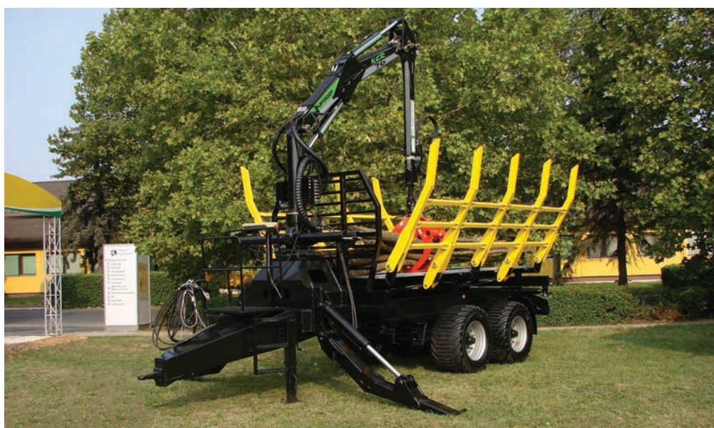
6. kép. Közelítőkocsikra szerelt forgórakodó kitámasztólábakkal
