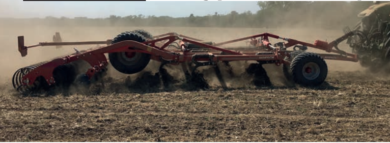
Terrano 4.4 GX – négy gerendely jobb egyengetés, nagyobb vonóerőigény
