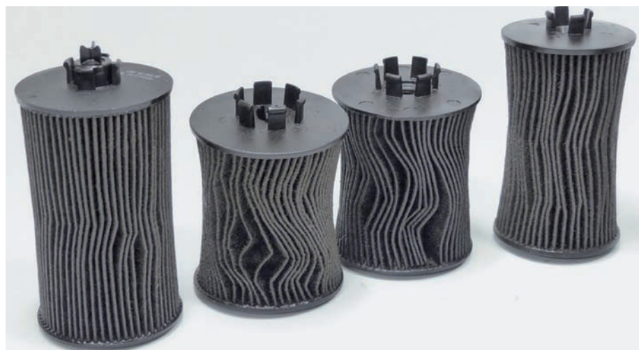
4. kép. Összeomlott olajsűrő betétek (forrás: www.mahle.com)
