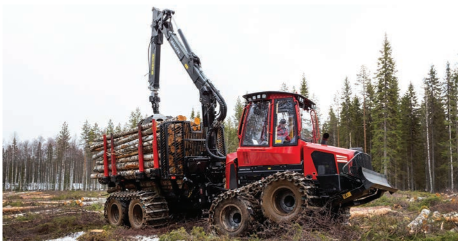
3. kép. Erdészeti traktoros, gumikerekes, de védőlánctalppal szerelt közelítő gépcsoport
