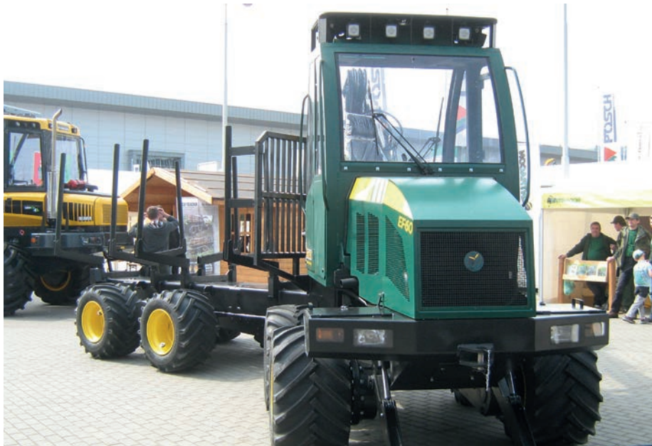
2. kép. Erdészeti traktor és közelítőkocsi gépkápcsolata
