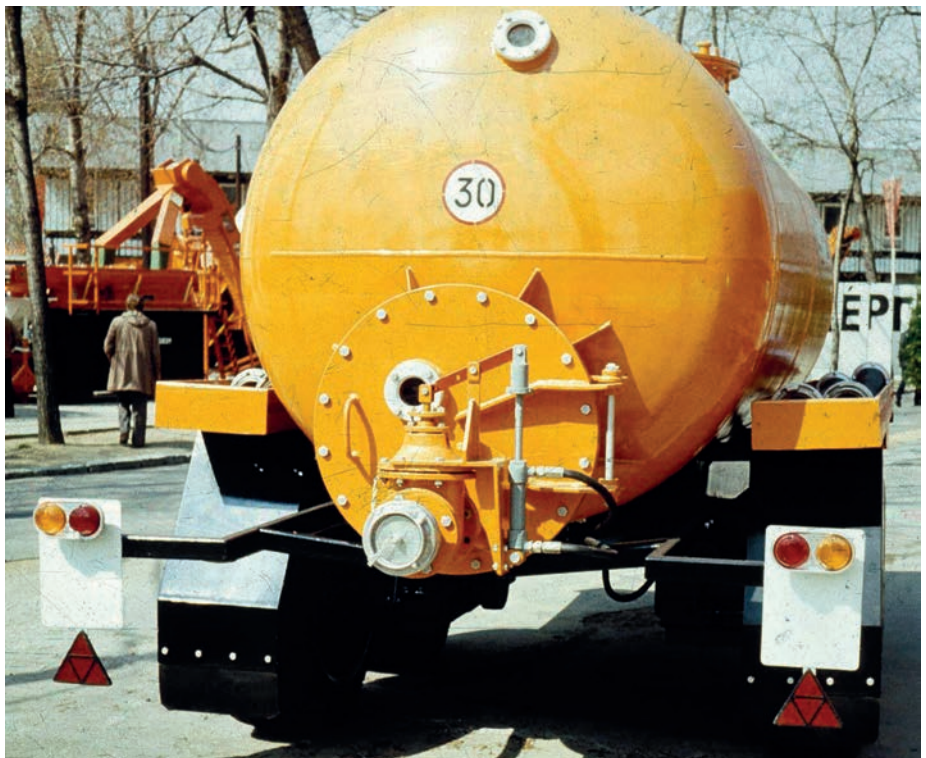
A hátsó tartályfenéken elhelyezett csőcsomók és a tartály tisztítására szolgáló búvónyílás
