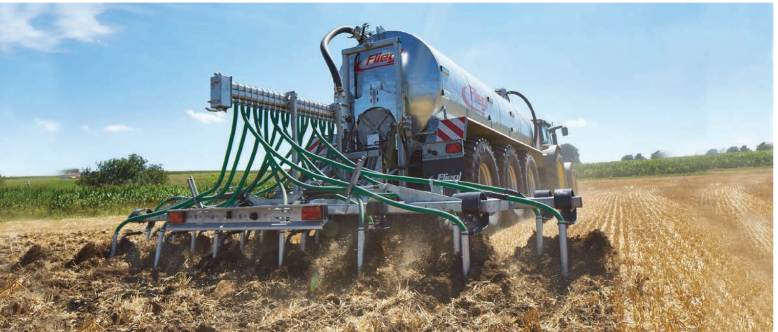
Flietl Abda Gépgyártó Kft. – Flietl HFW 25000 centrifugálszivattyús tartálykocsi GUG 45 grúberes hígtrágya-injektálóval
