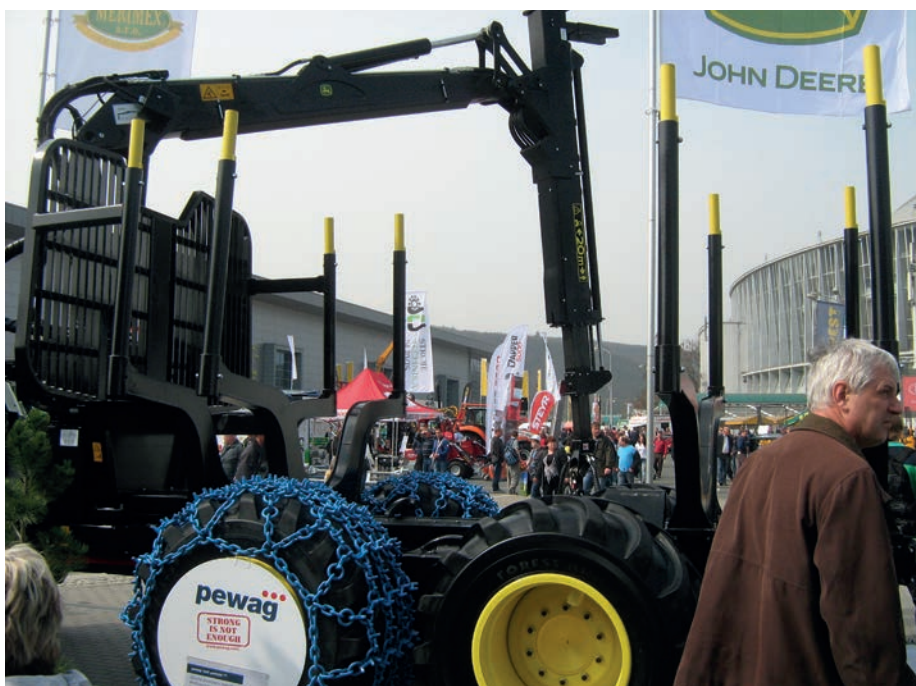
4. kép. A hajtott kerekes futóművek gumiabroncsaira kapaszkodólánccok is felszerelhetők
