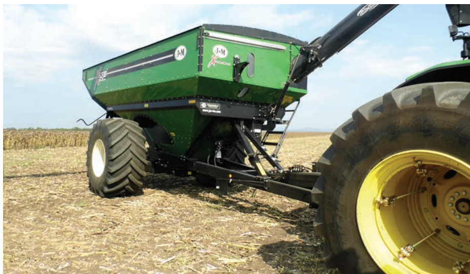
1. kép. Egyszerű egytengelyes, alacsonynyomású gumibroncsos futóművel szerelt pótkocsi
