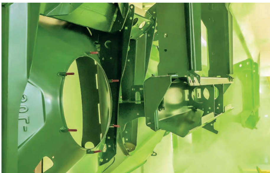
A kiegészítő, vastagon felhordott porfesték optimális védelmet nyújt a mechanikai igénybevételekkel szemben
