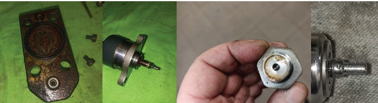
Rozsda és fémtörmelék az üzemanyagrendszerben
