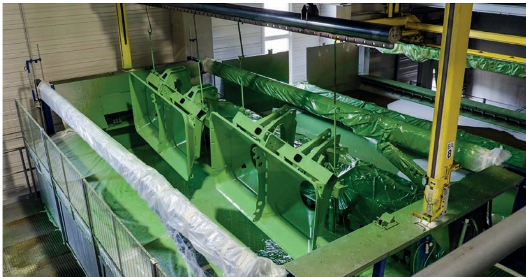
Az összes alkatrész katódos merítőfestése szinte teljes felületi korrózióvédelmet biztosít
