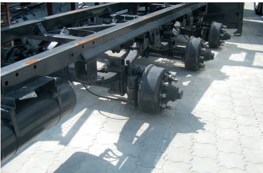
5. kép. Létra alakú alváz rugózott tridem futóművel
