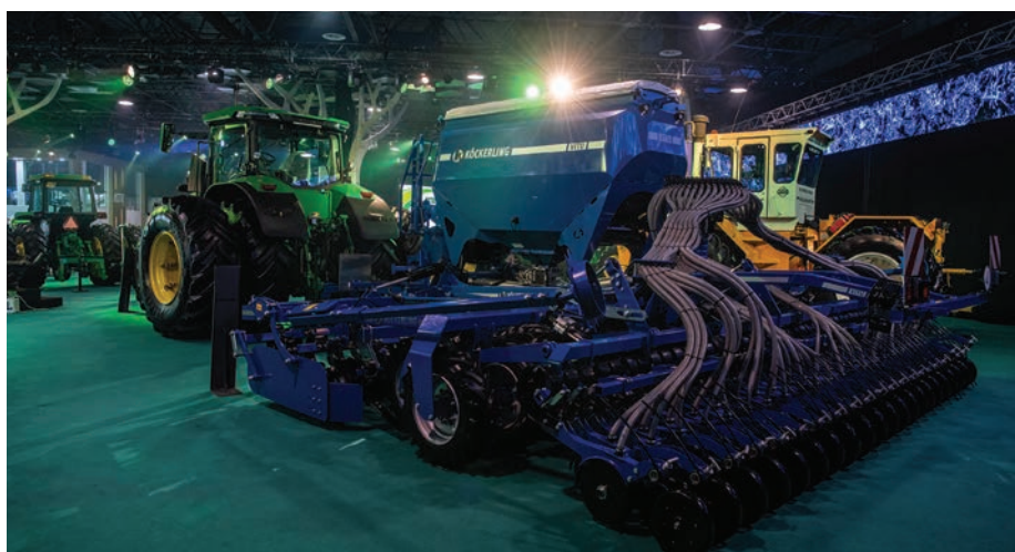
A német Köckerling gyár Vitu kombinált magágykészítő vetőgépe beilleszthető a hagyományos és forgatás nélküli talajművelési rendszerekbe egyaránt
