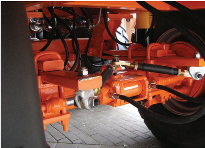
4. a. b. kép. Kerékhormányzási megoldás és vezérlése
