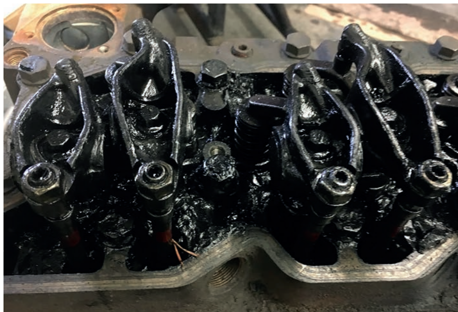
4. kép. Működést akadályozó olajiszap-lerakódás az elmulasztott olajcsere miatt (forrás: https://xlmechanicalservice.ca )
