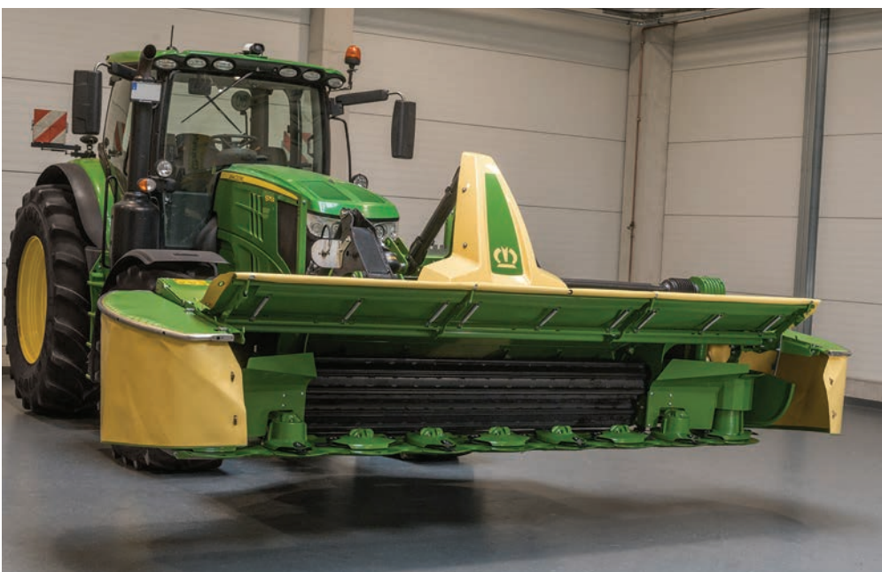
A Krone EasyCut F 400 CR frontkasza merev kaszatesttel és az alapfelszereltséghez tartozó, 25 cm átmérőjű profilozott poliuretán hengerekből készült szársértővel rendelkezik
