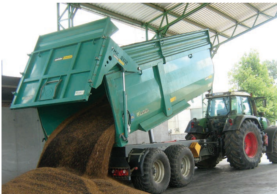
7. kép. Szemestermények szállítási feladatait a billenő felépítményes pótkocsikkal lehet megoldani
