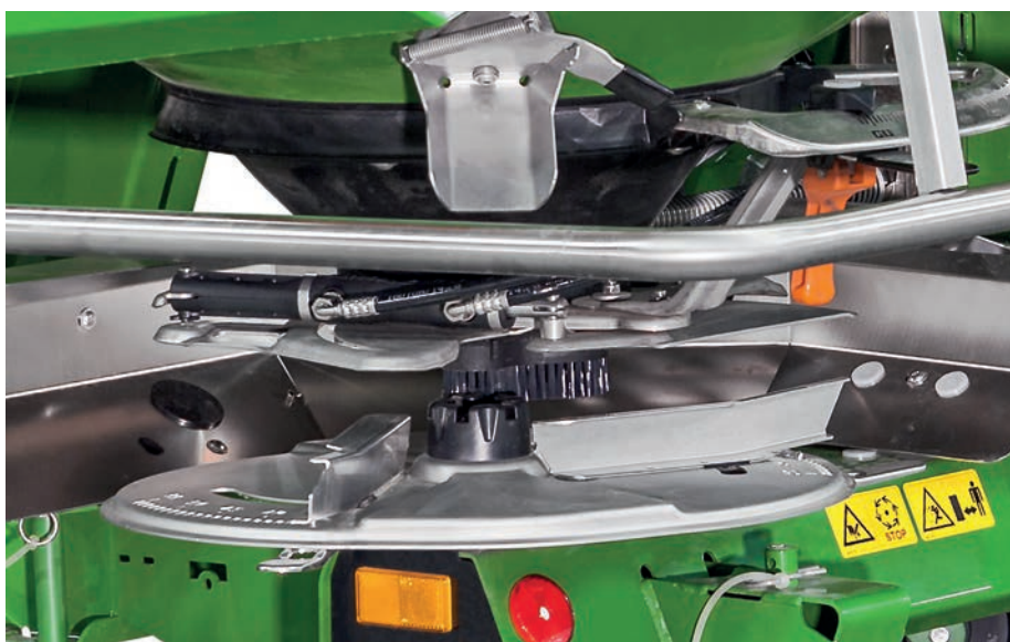
Következésképpen a korrózióvédelem van a fókuszban. A szórószerkezet alkatrészei és a hidraulikus szerelvények kiváló minőségű nemesacélból készülnek
