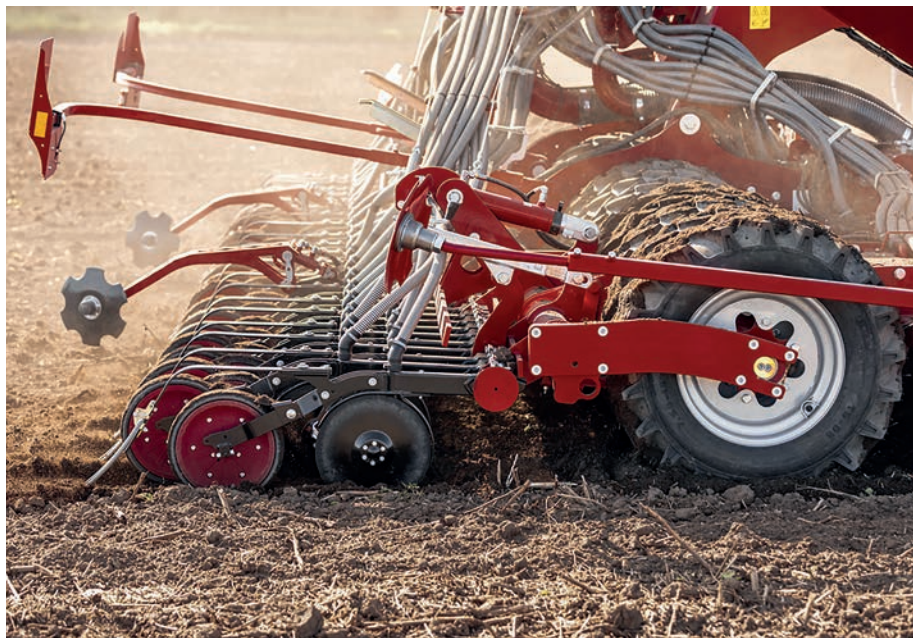
A Pronto elv talajművelés - tömörítés - vetés - lezárás
