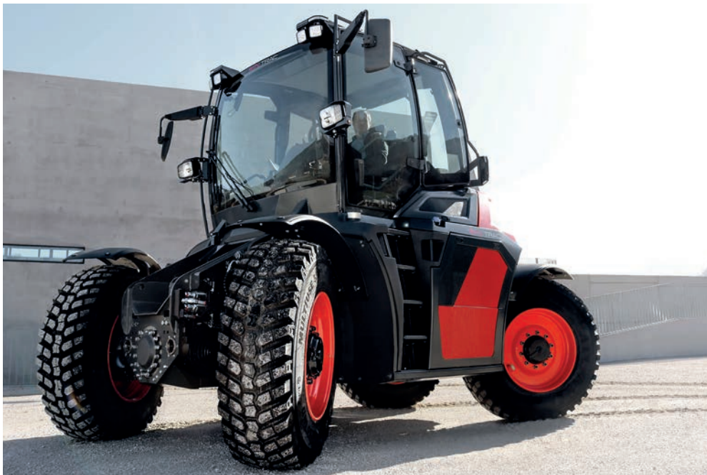
8. kép. Syn Trac négykerék-hajtású és -kormányzású, 420 lóerős, többcélú traktor (forrás: https://www.grainews.ca )
