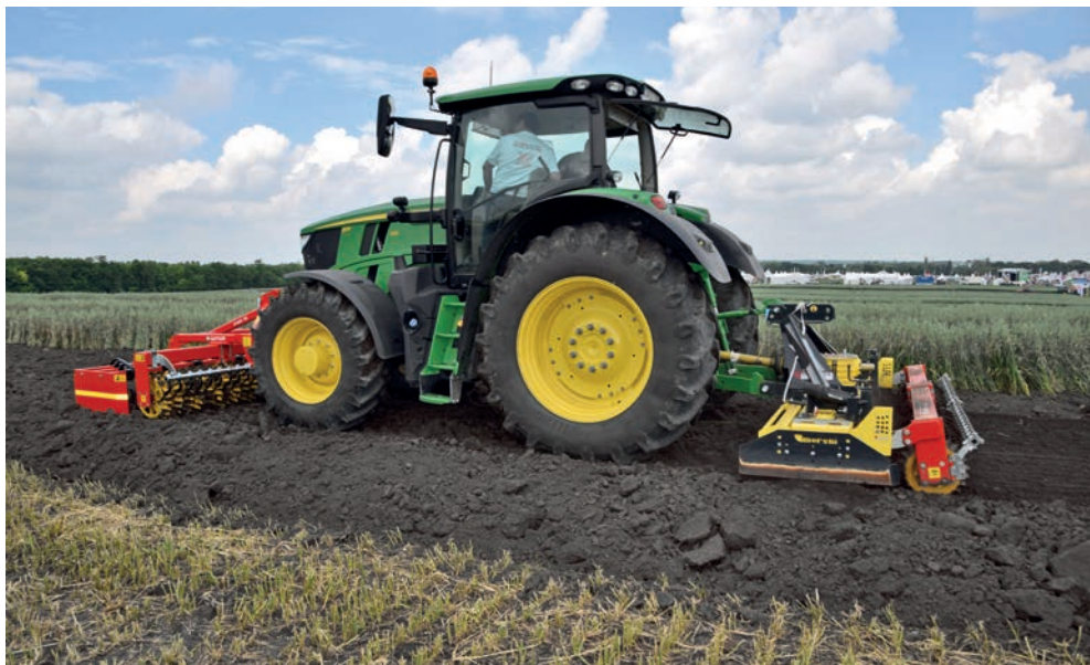
A Gütler Avant 30-56 3 méter szélességű, frontfüggesztésű magágykészítő Moreni Compact 3000 szántóföldi forgóboronával kombinációban
