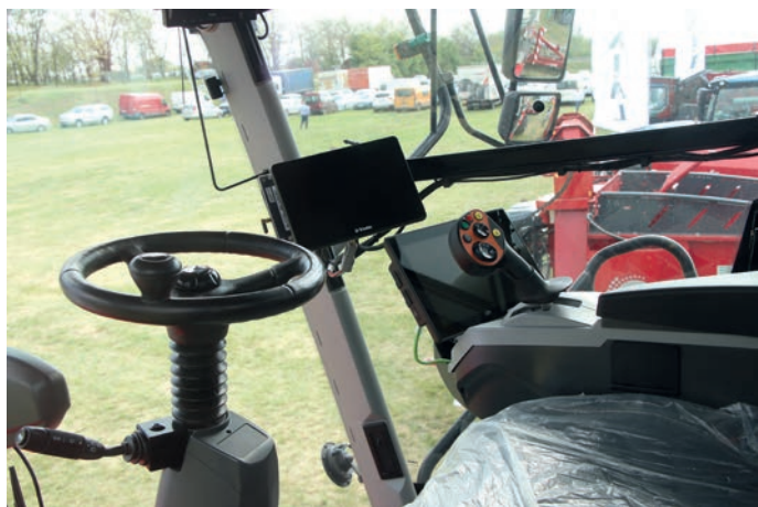
A fülkében multifunkcionális érintőképernyős monitoron végezhető el a gép összes beállítása, illetve futtatható a diagnosztika
