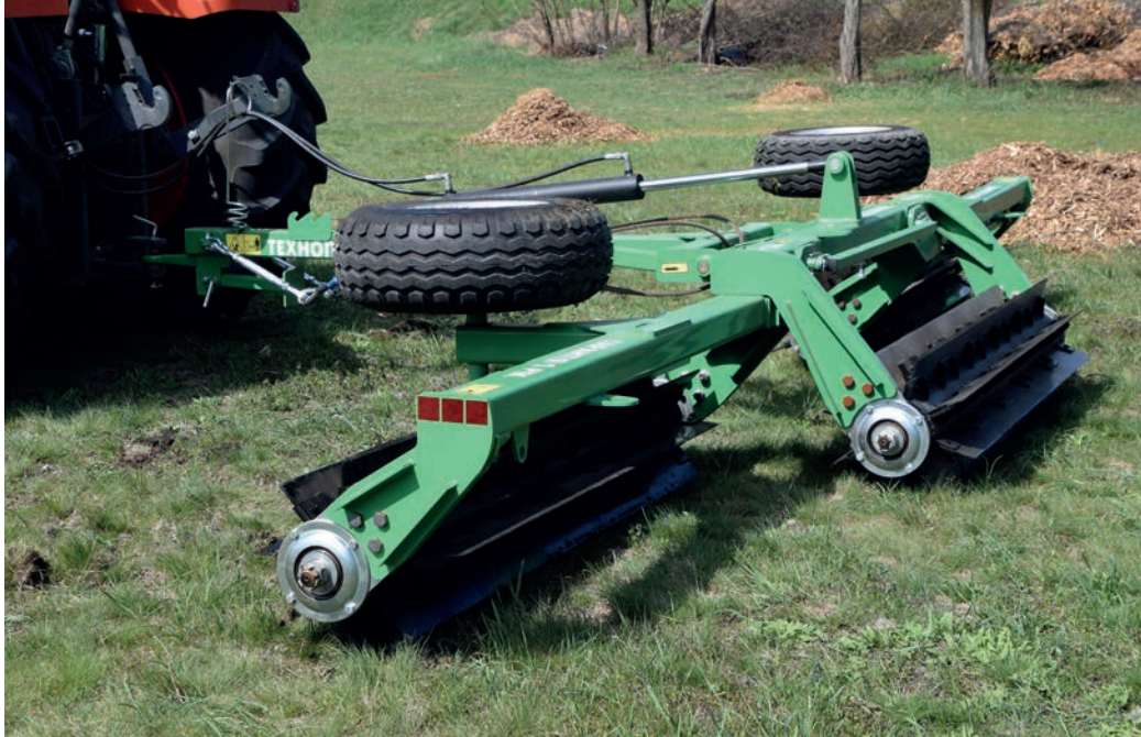
Néhány gyártó a rögtörő-tömörítő hengerek vázát felhasználva kínál vontatott aprítóhengert
