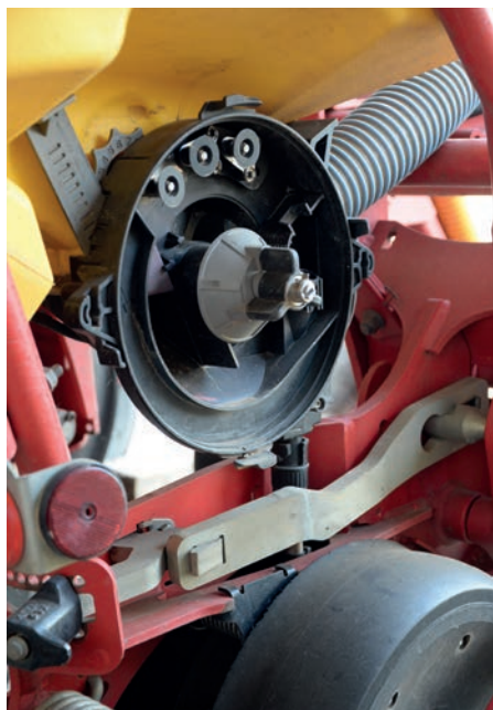
A Tempo magadagoló egysége nagy vetési sebességnél is rendkívül precíz
