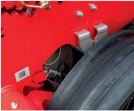
AF mérőcella, automata csoroszlyanyomás-állítás
