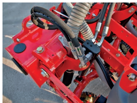
Széles, robusztus paralelogramma és a hidraulikus nyomásállítás
