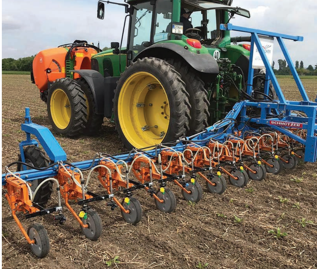
A Schmotzer gépével egy 75 cm-es sortávolságú kapás kultúránál, 10 cm-es permetezett sort feltételezve, akár 80%-os növényvédőszer-megtakarítás érhető el (fotó: https://schmotzer.de/ )
