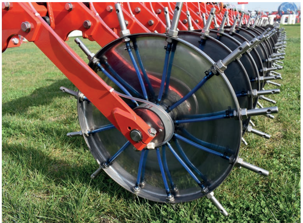
A tárcsák és alkatrészeik rozsdamentes acélból készülnek
