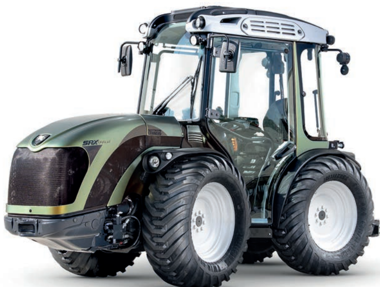
9. kép. Antonio Carraro SRX Hybrid típusjelzésű 95 kW-os (102 LE-s) traktor (forrás: https://lectura.press/en )
