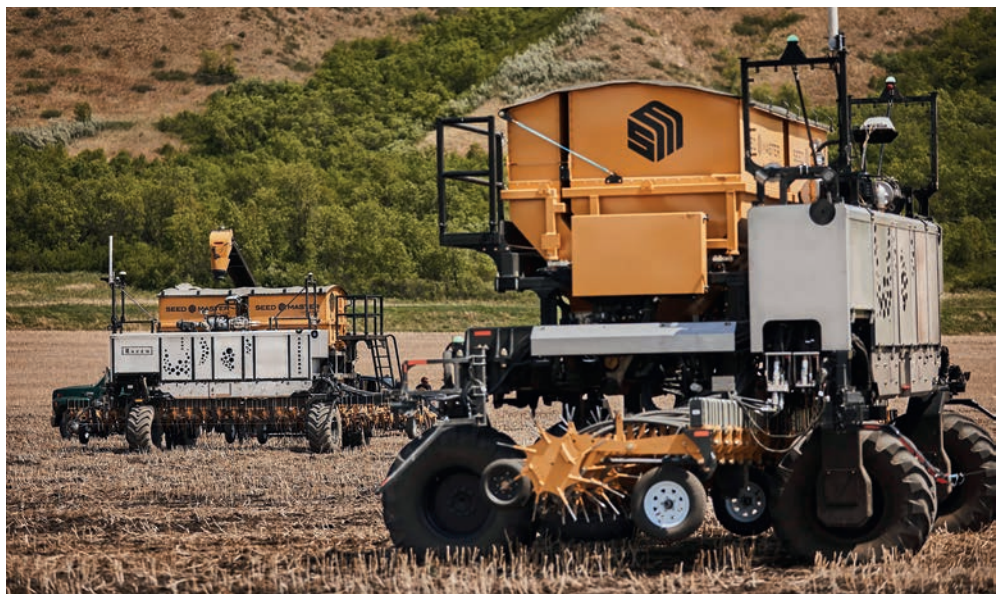
4. kép. Raven OMNi-POWER 3200 típus jelzésű, több célra alkalmas autonóm gép (forrás: https://mms.businesswire.com/media/ )
