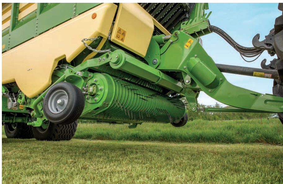
3. kép. A vonórúddal szállítási helyzetben kiemelhető rendfelseszdő, szeletelő, anyagtovábbító berendezés (fotó: https://mykrone.green/ )
