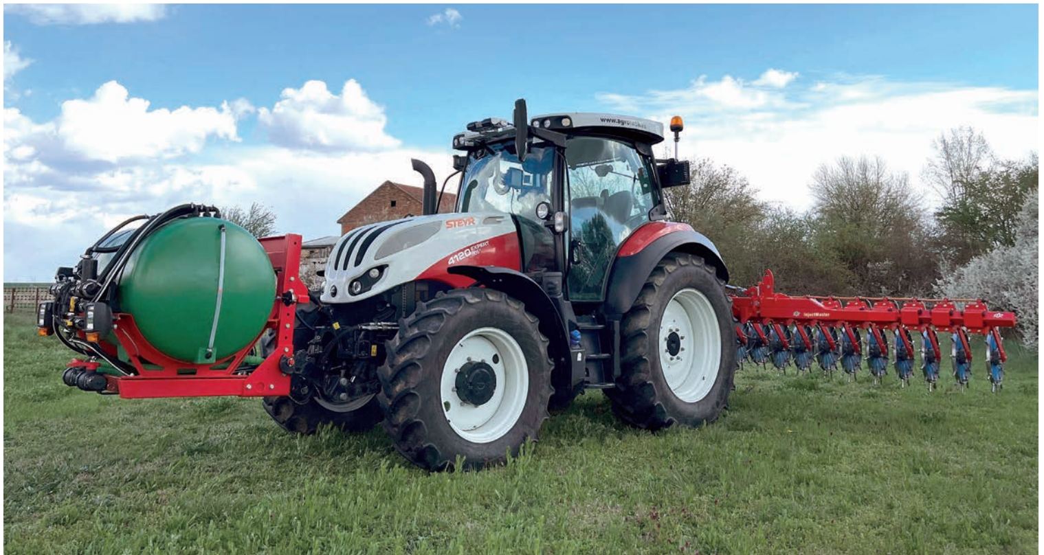
A tartály magára a munkagépre is szerelhető, de frontfüggesztésre is kapcsolható
