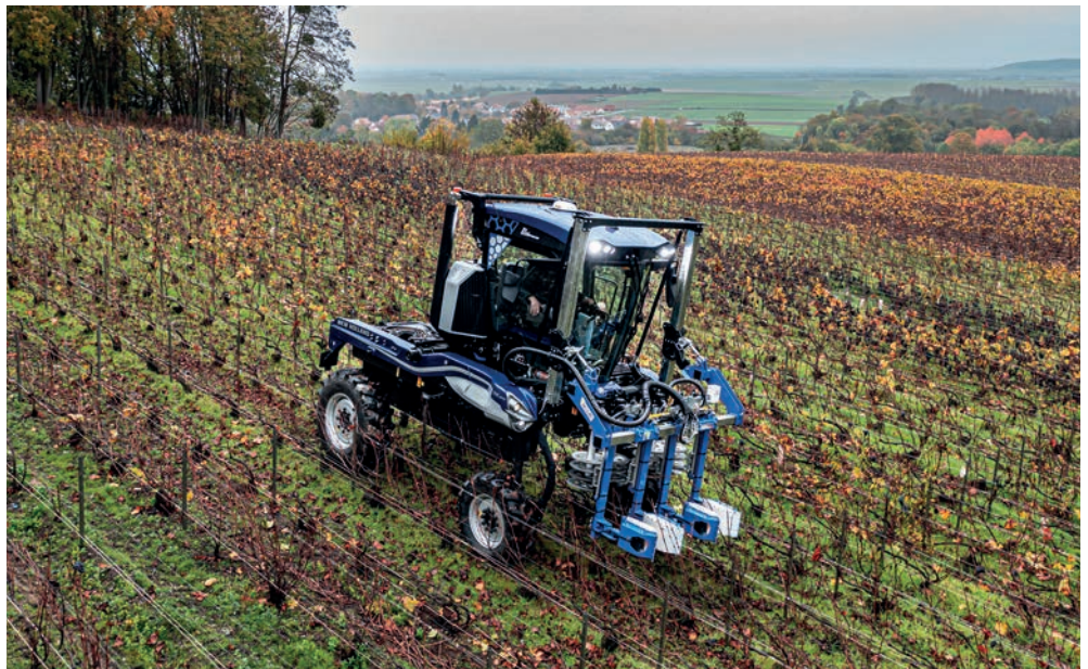
3. kép. New Holland TE6 hidas traktor (forrás: www.powertraininternationalweb.com )
