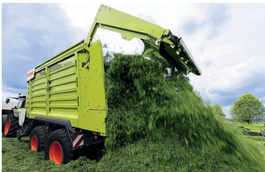
4. kép. Nagy raktérfogatú kocsiszekrény a bontóhengerekkel ürítés közben (fotó: https://www.claas.hu/ )
