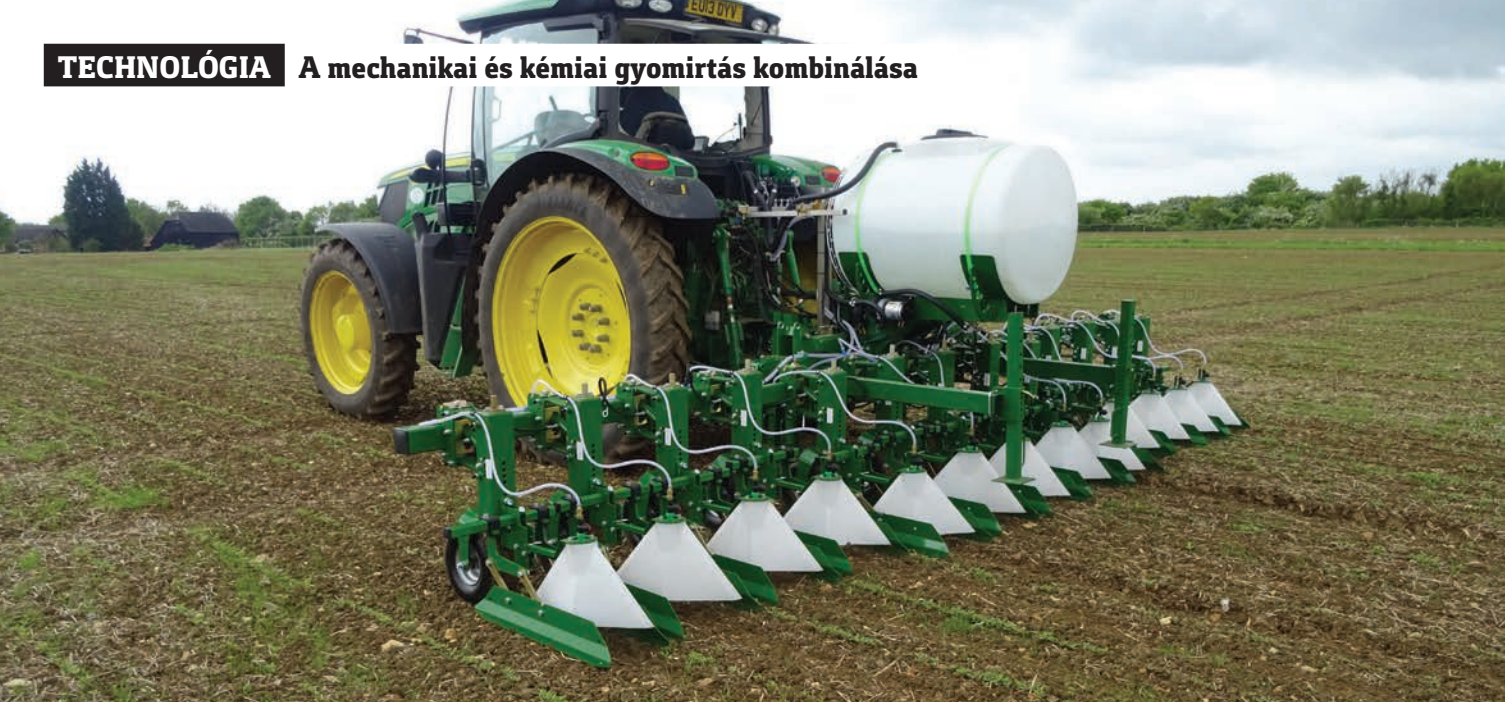
A Garford akár a sor- és a sávpermetezés egyidejű kivitelezését is lehetővé teszi Twin-Line rendszerével (fotó: https://garford.com/ )
