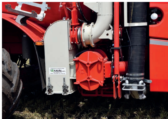
A 9000 l/perc szállítási kapacitású Börger zagyszivattyú
