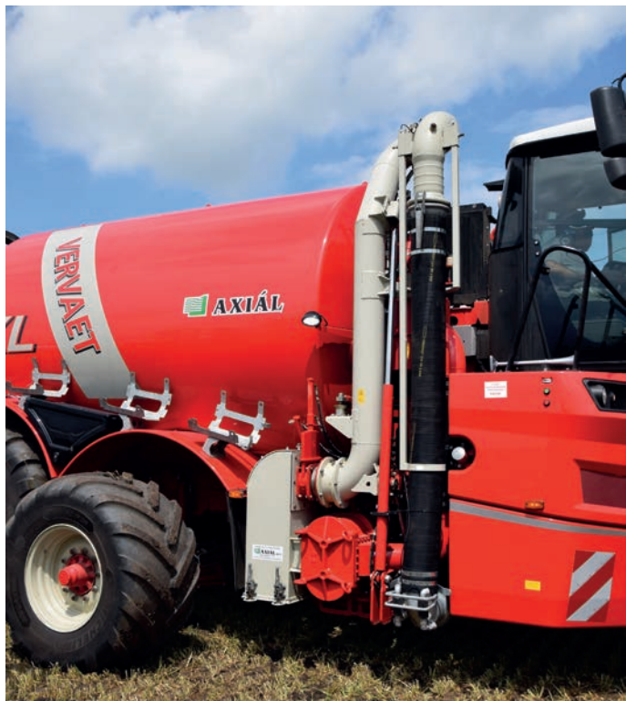
A 8 colos oldalkarról történő felszívás már kevesebb mint 3 perc alatt megvalósítható
