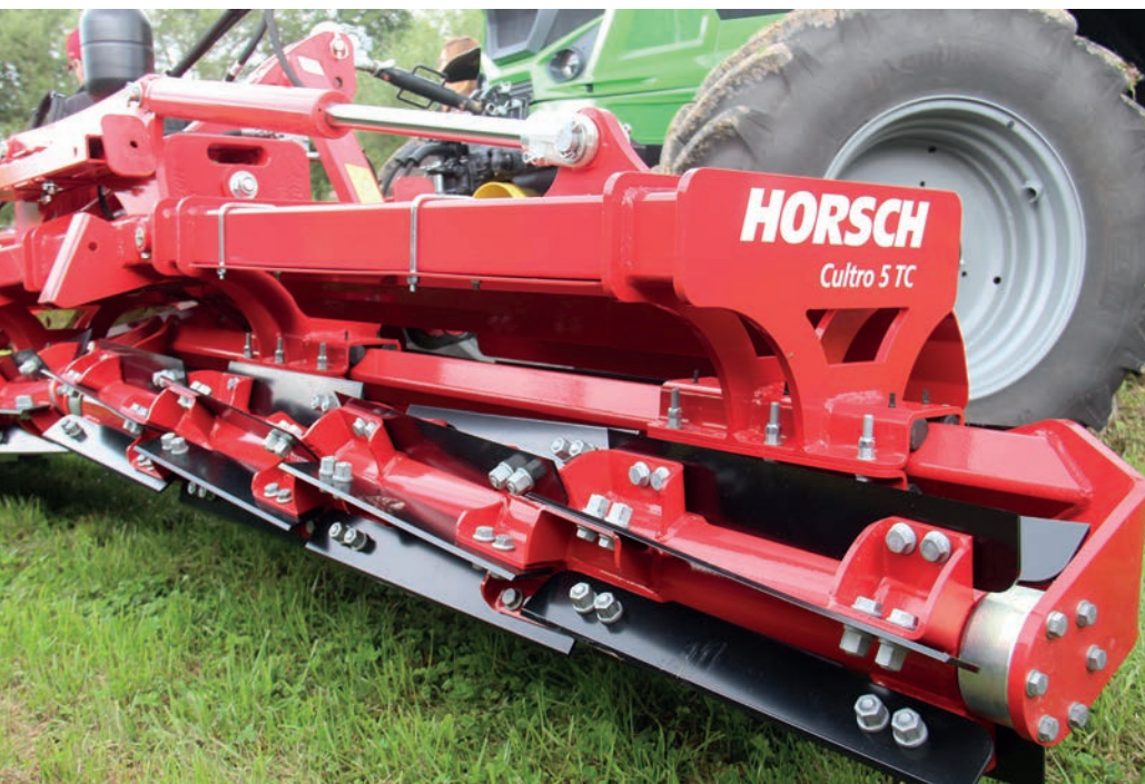
A talaj keresztirányú egyenetlenségeinek követését szekcionált hengerekkel és késekkel oldják meg
