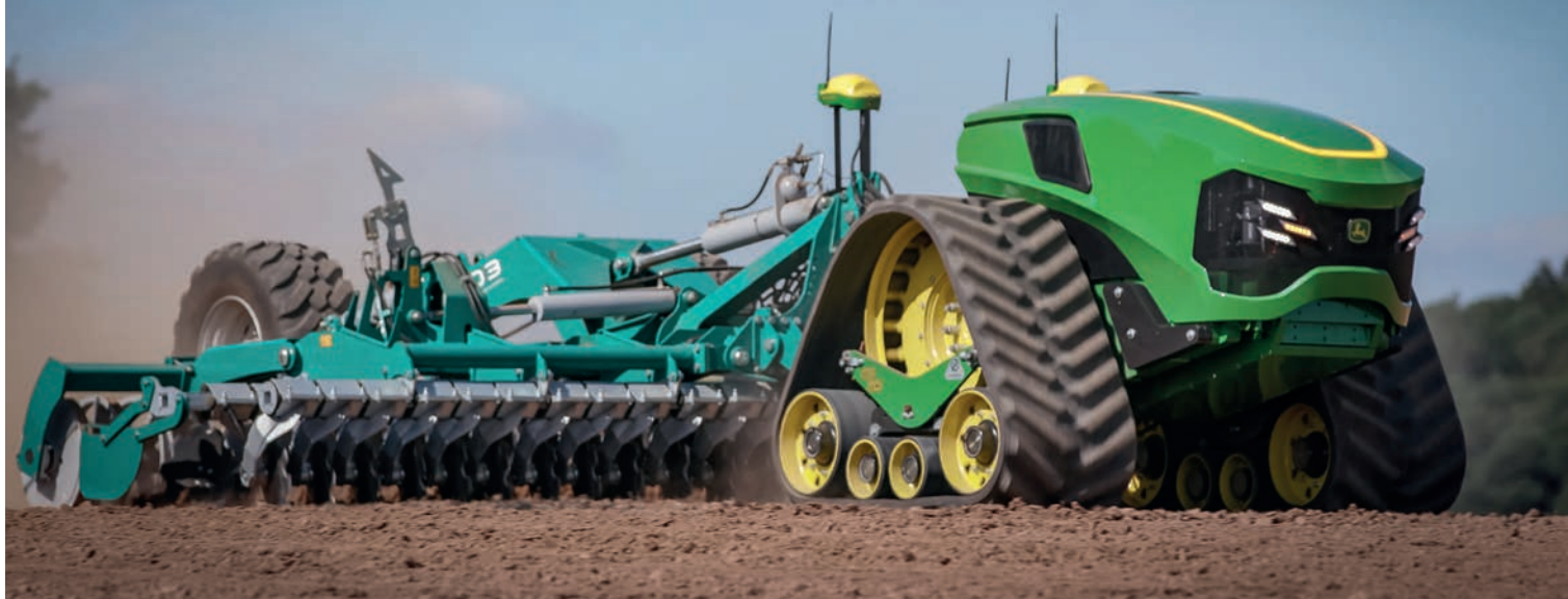
11. kép. John Deere kísérleti, egytengelyes, robot-elektromos traktor (forrás: https://www.deere.com/en/ )
