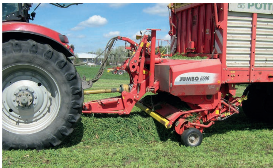
6. kép. Szeletelővel egybeépített rendfelszedő adapter munka közben
