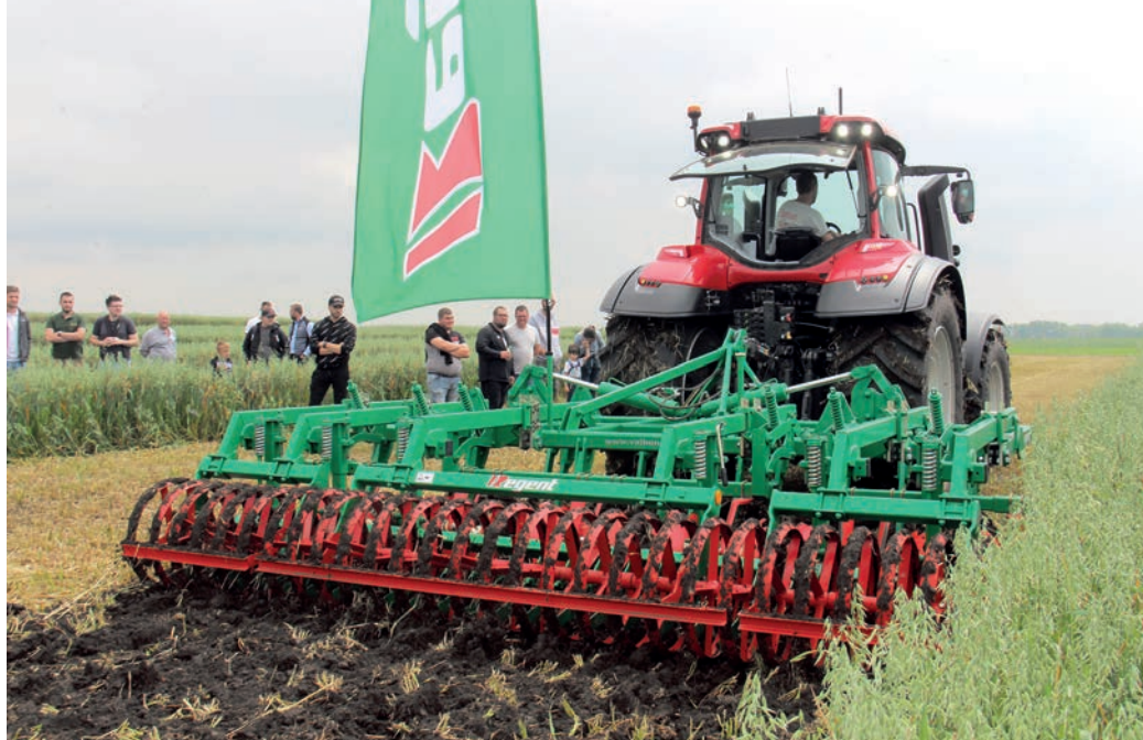
A Regent Tukan MSG400-3 függesztett gruber 80 cm-es gerendelymagasságú
