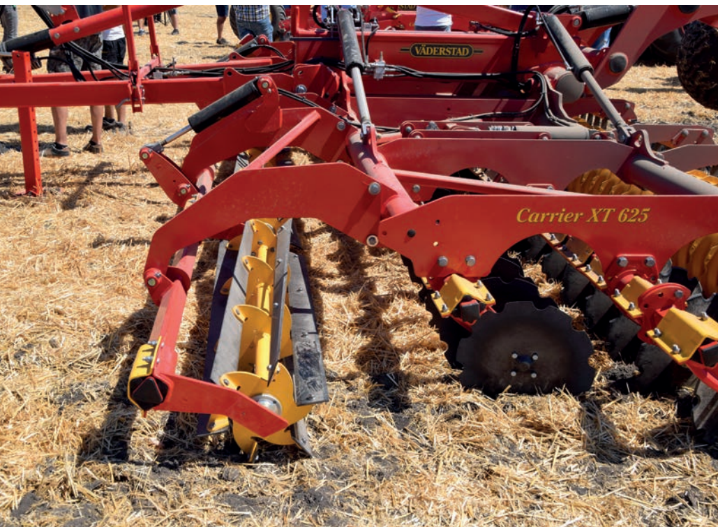
Könnyen fel- és leszerelhetők más talajművelő eszközök vázára, gerendelyére
