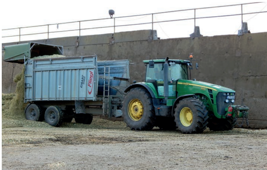
2. kép. Tandem tengelyes futóművel szerelt, nagy raktérfogatú, letolófalas pótkocsis falközi ürítés közben
