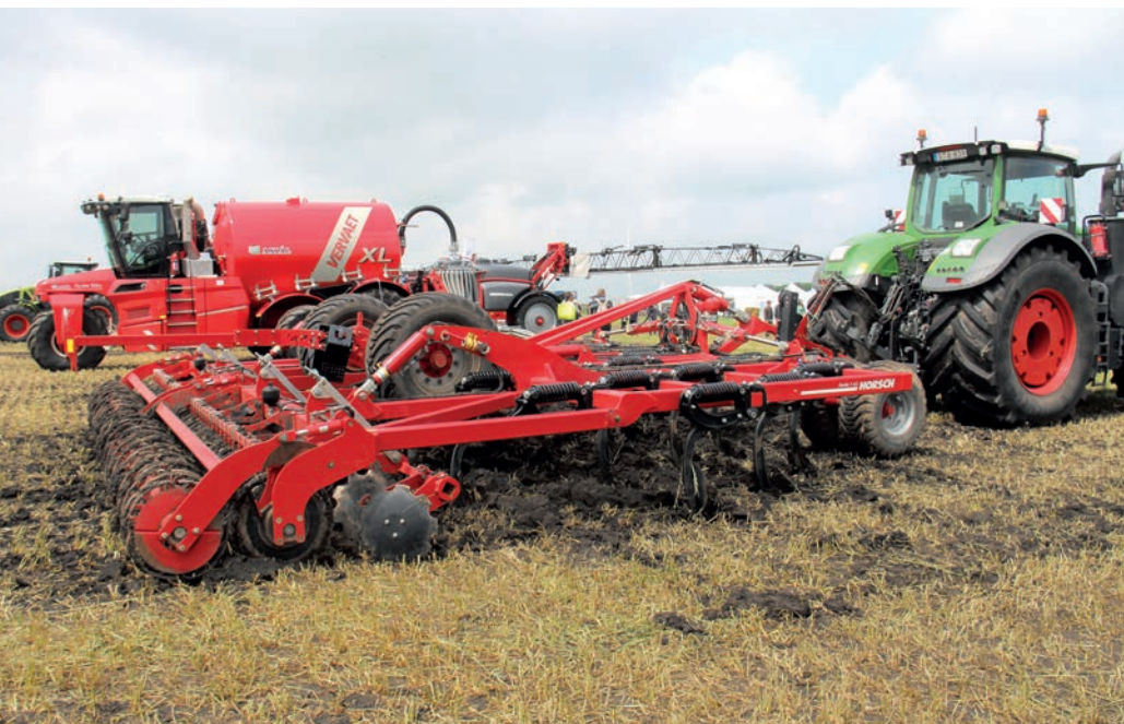
A Horsch Fortis szántóföldi kultivatort mély, de kevésbé intenzív talajművelésre tervezték
