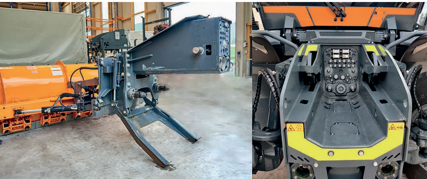
5. kép. Syn Trac erőgép és munkaeszköz automatikus kapcsolatának megoldása, bal oldalt a munkagép, jobb oldalt a traktor dokkoló szerelvényei láthatók (forrás: www.syn-trac.at )
