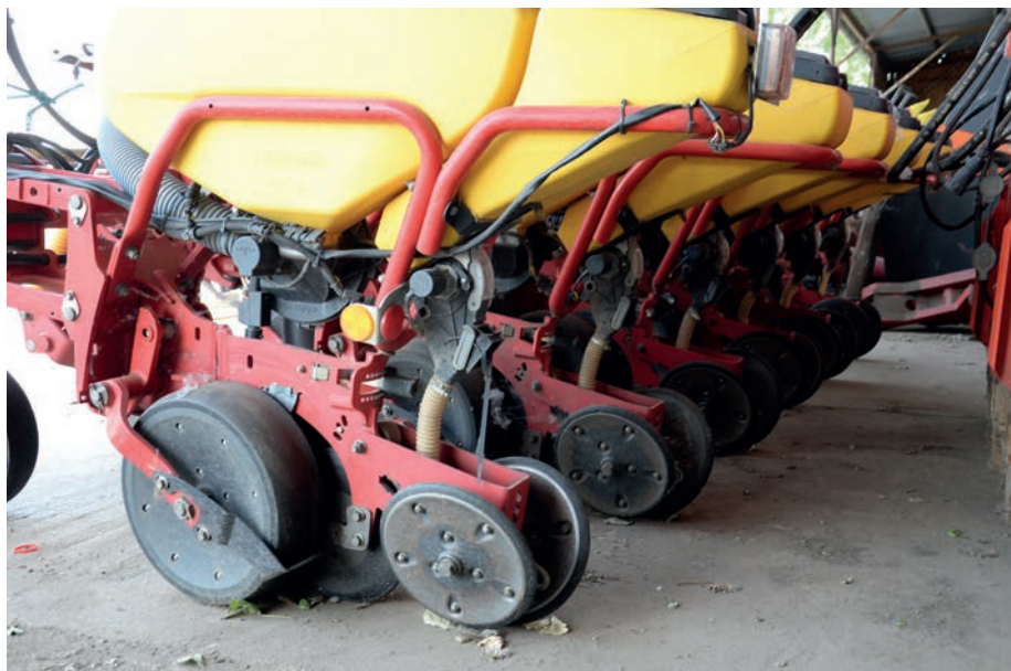
A vetett sorokat záró kerekek alakítják ki a tökéletes csírázás feltételeit
