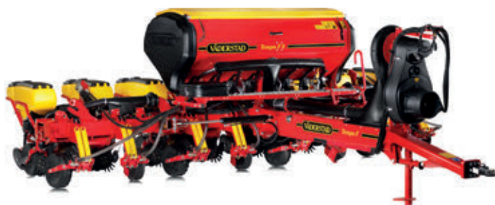
Tempo F8 vontatott szemenként vető gép
