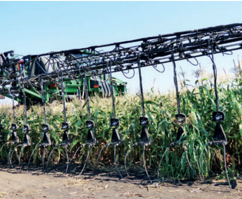
A John Deere Y Drop 24 soros permetezőgép a csózána magasságában is hatásosan dolgozik
