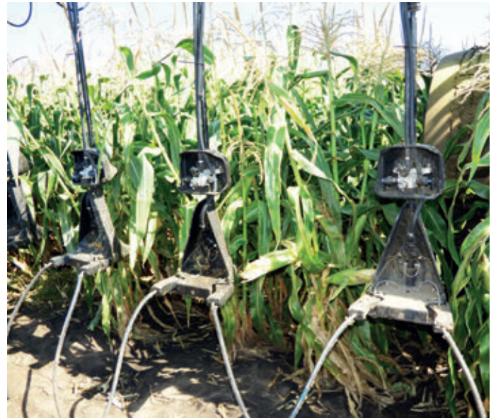
A John Deere Y Drop 24 soros permetezőgép a csózána magasságában is hatásosan dolgozik
