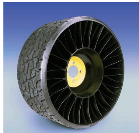
7. kép. Michelin X Twell Turf jelzésű levegő nélküli mezőgazdasági kerék (www.michelinweel.com)
