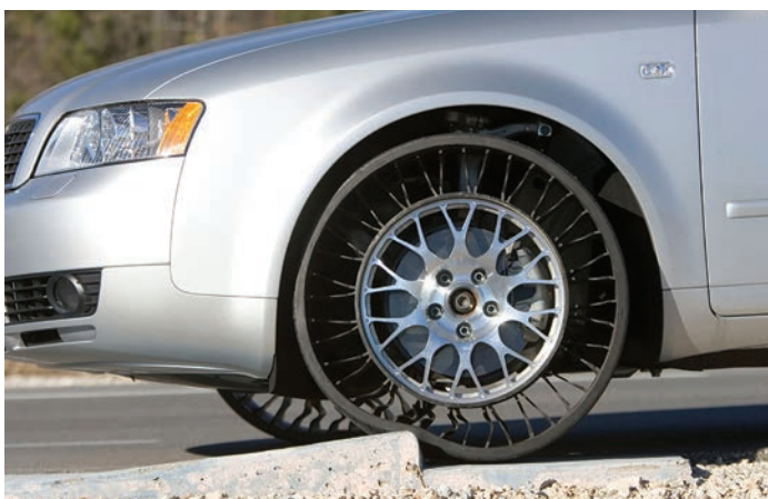
2. kép. A Michelin a 2004-es Párizsi Autószalonon mutatta be az első, személygépkocsira való levegő nélküli abroncs prototípusát ( www.autoszektor.hu/hu/ )
