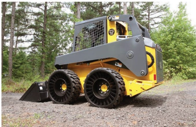
5. kép. CAT 252B homlokrakodó Michelin X Twell SSL All Terrain kerékekkel (www.michelinweel.com)
