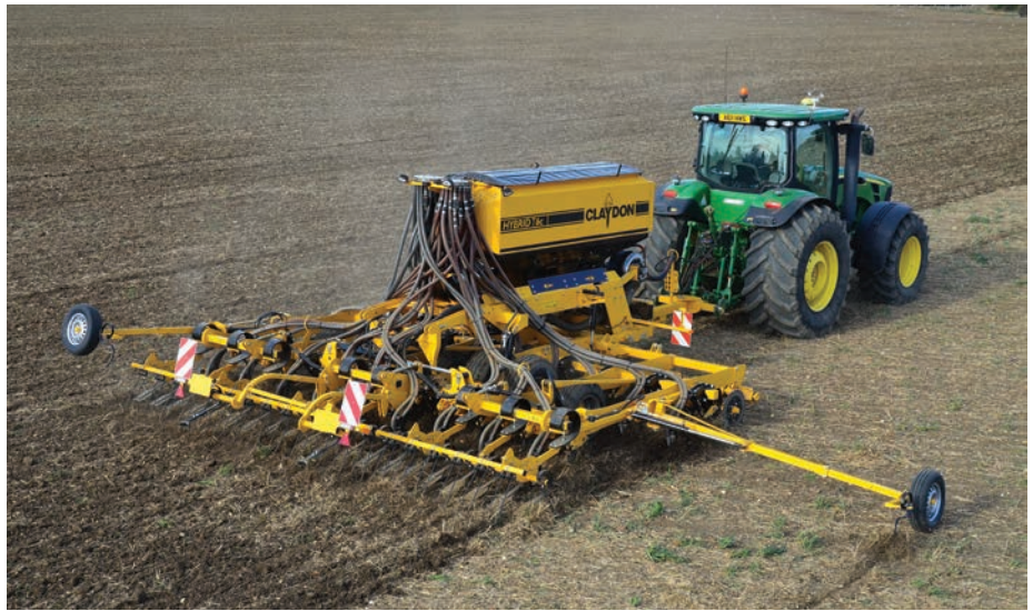
A Claydon új fejlesztésű Hybrid T6c sáv-művelő-gabonavető gépe
