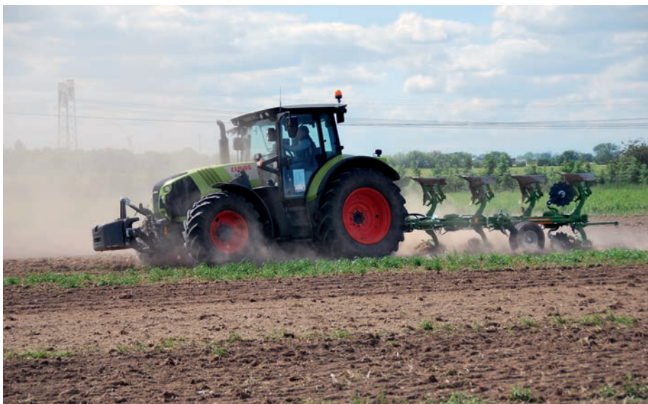
Az optimálisan beállított ekével csökken az üzemanyag-felhasználás és a kopás
