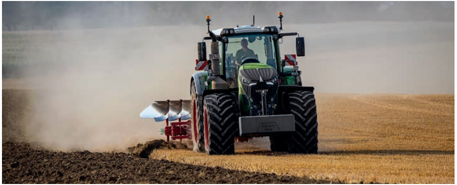
A maximális motornyomaték 1970 Nm, ami a 942-es Vario topmodell esetében 1100-as motorfordulat mellett érhető el
