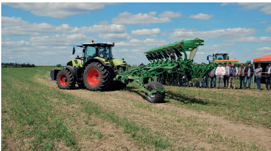
A hidraulikus véghelyzet-csillapítású fordítóhengerek az eke nyugodt és egyenletes fordítását garantálják
