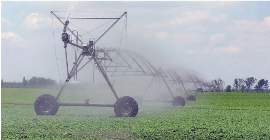
A haladási sebesség 0-120 m/óra között fokozatmentesen állítható. A kijuttatható vízáradék 5-50 mm
