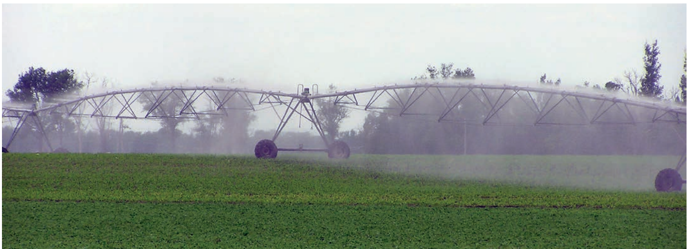
Járótornyokon helyezkednek el a hajtásért felelős elemek: a villanymotor, a kerékajtóművek, a kerekek, a kardán
