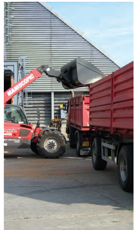
6. kép. Szemestermény-kitárolás horizontáltárolóból teleszkópos homlokrakodóval
