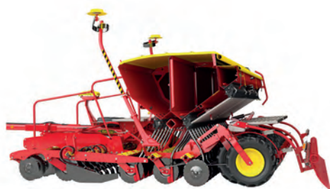
Rapid 400C kombi gabonavetőgép, foszforszóró egységgel
