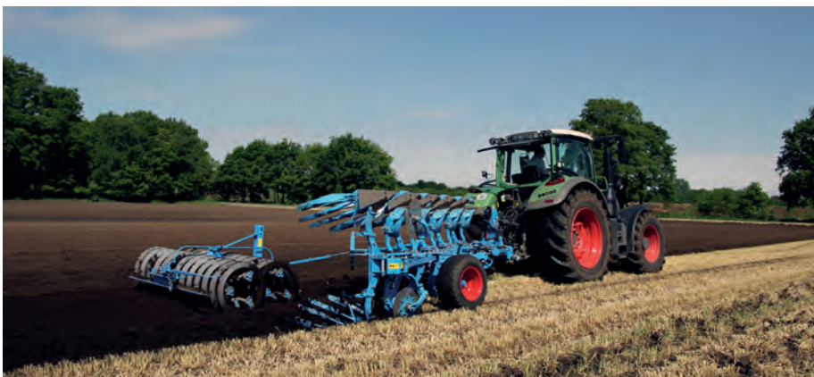
Lemken VarioPack-kal akár vetőágy is készíthető, még kötött talajon is
