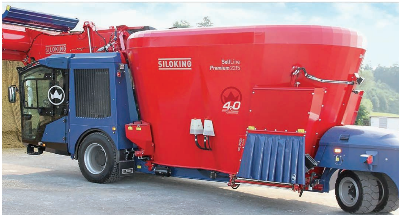
3. kép. SILOKING SelfLine 4.0 magajáró takarmánykeverő-kiosztó kocsiját (forrás: https://www.yumpu.com > view > siloking-40-product-overview-hu )
