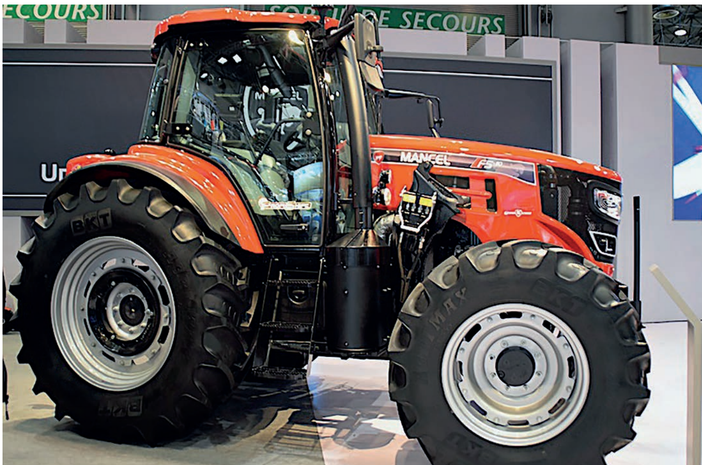
2. kép. Mancel F5-110 típusjelzésű, 110 lóerős, összkerékajtású traktor (forrás: www.meccagri.it.../wordpress/.../Mancel/ )
