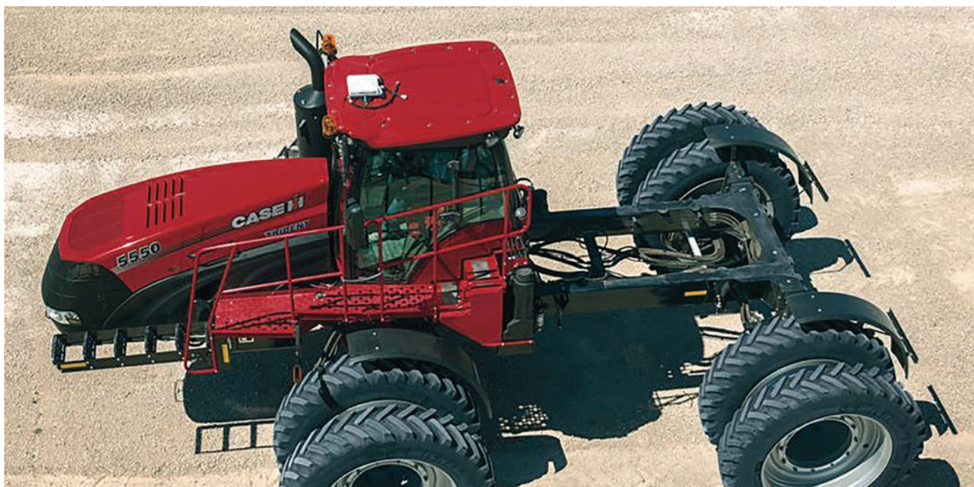
4. kép. CASE IH Trident 5550 növényvédő/tápanyag-kijuttató gép hordozó (forrás: www.caseih.com )
