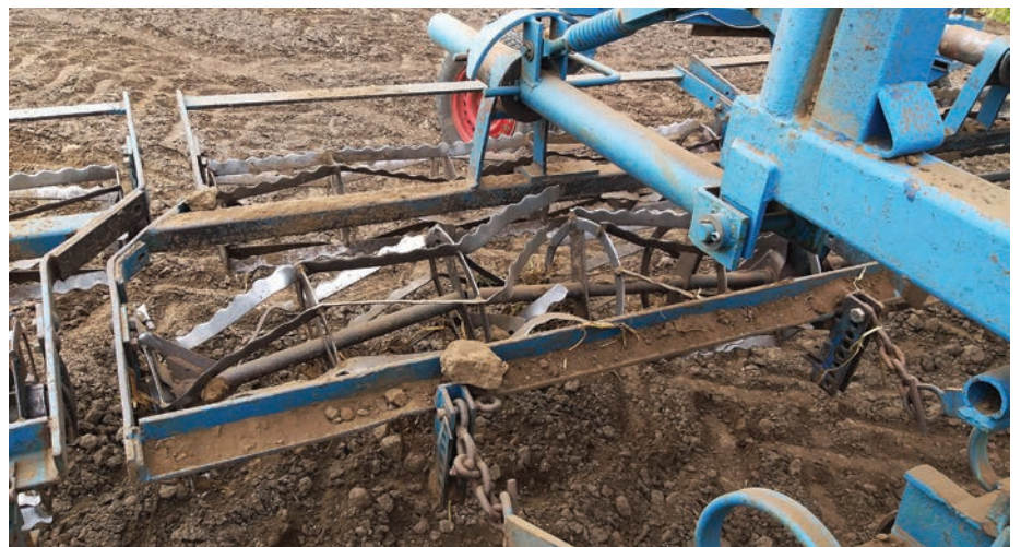
2. kép. Ha egy papírvékonyra elkopott hengert nem cserélünk a szezon előtt, akkor ez munka közben így bosszulja meg magát
