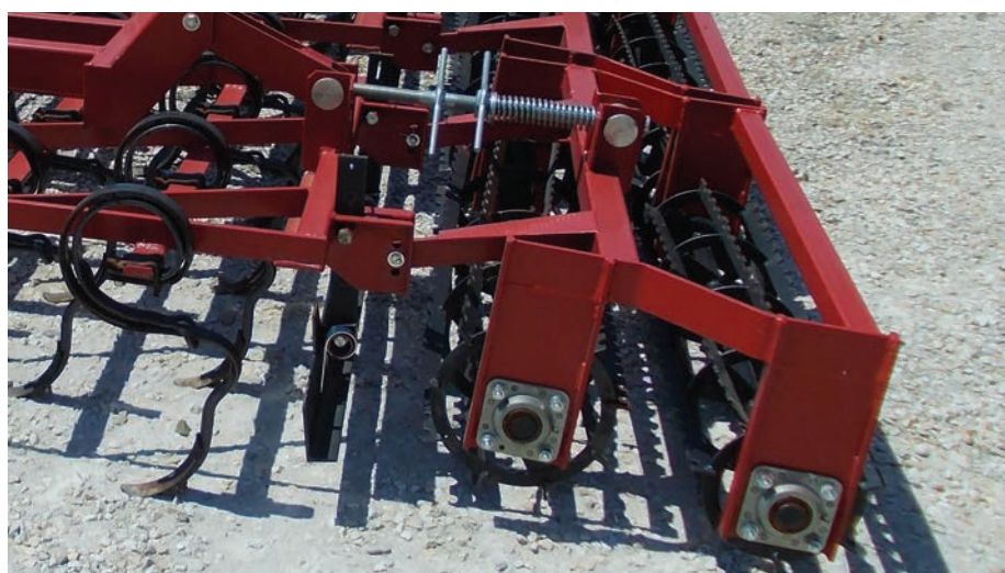
4. kép. A rögtörő hengerek menetes állítóorsóit is ellenőrizni kell
