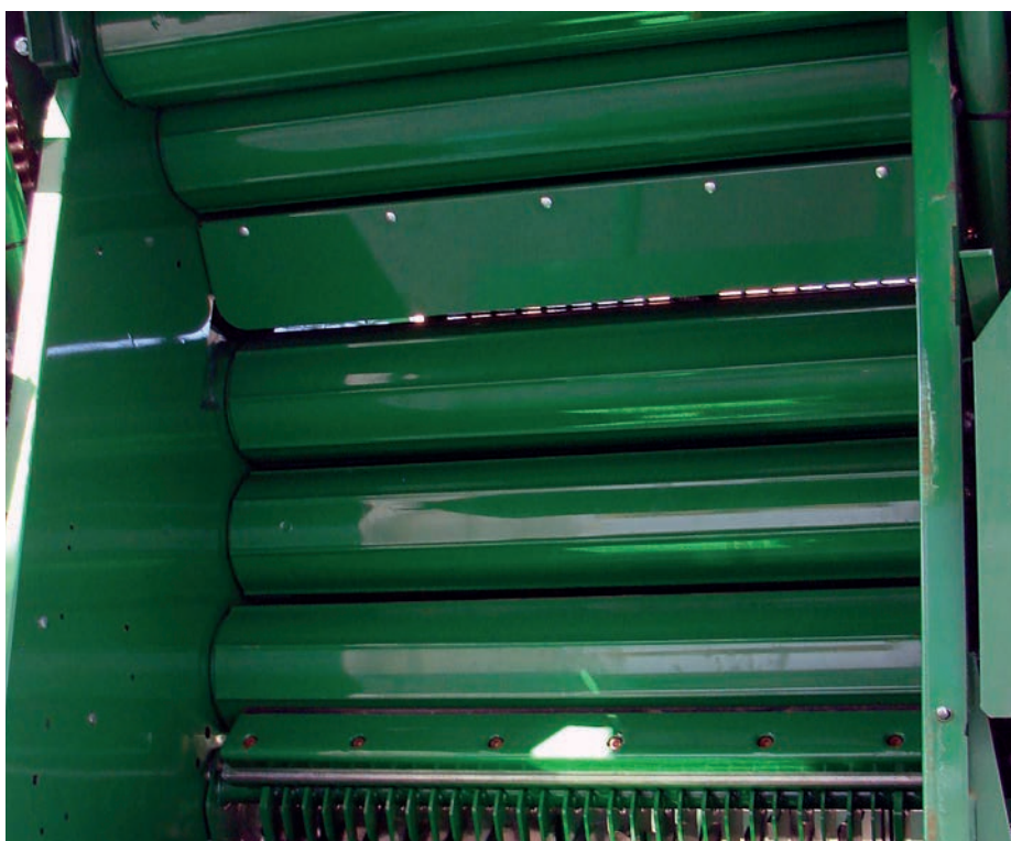
Bár a képen vadonatúj fixkamrás bálázó hengereit láthatjuk, de egy sok szezonat dolgozott gépnél ezek is lehetnek annyira kopottak, hogy rontják a bálázó munkaminőségét
