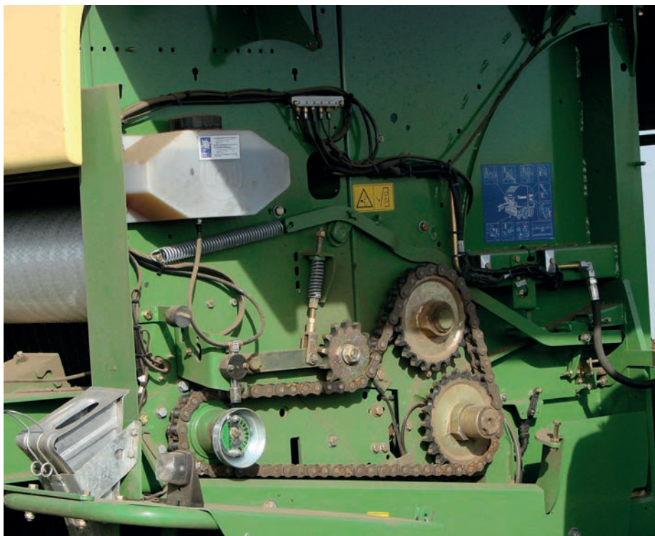
Ellenőrizzük a görgős láncáttelek és a lánckerekek kopását, illetve kenését!
