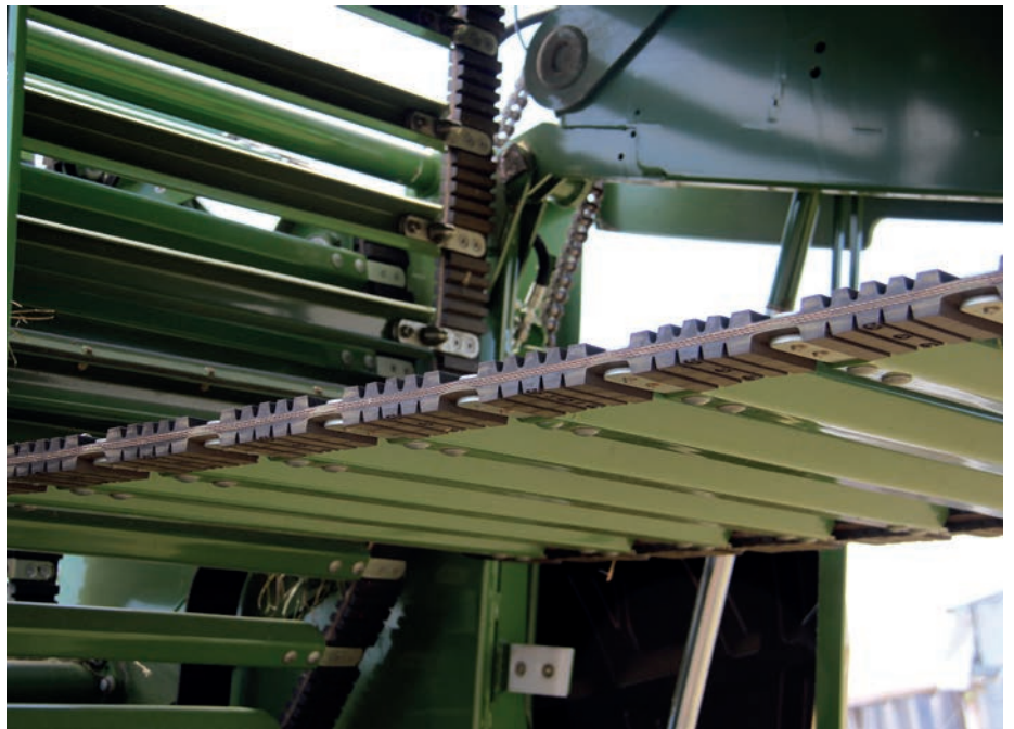
Ellenőrizni kell a bálaformázó rudakat, csatlakozásukat a hevederekhez
