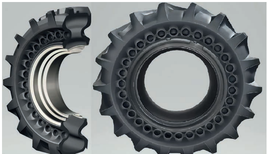
6. kép. Galileo CupWheel Airless elnevezésű, levegő nélküli hibrid gumikerék (forrás: www.galileowheel.com/media/ )
