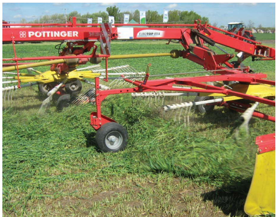
3. kép. A rendrakó gépek forgórészeit bonyolult futóművek támasztják alá
