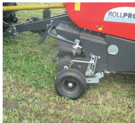
1/a-b. kép. Leválasztólemezes rendfelszedő és vezéreltujjas konstrukció talajkötés-állítási megoldása
