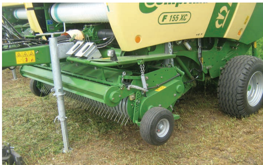
4. kép. A rendfelszedők pontos talajkövetéssel dolgoznak
