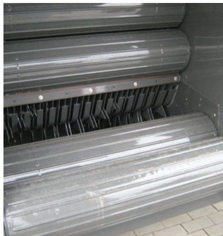
2/a-b. kép. Állandókamrás hengeres bálázó rotoros és a szögletes nagybálázó „FineCut” aprítóberendezése
