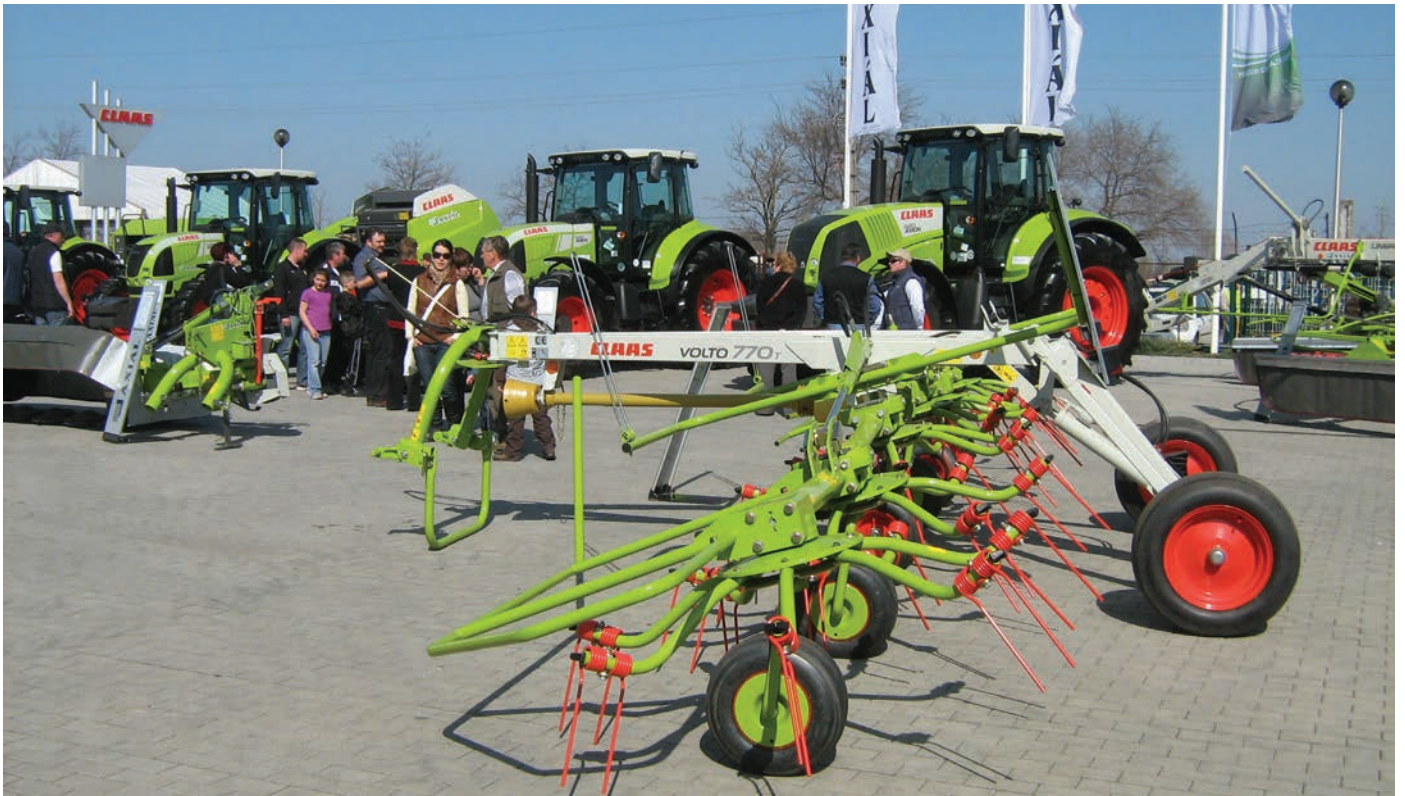
2. kép. A rendterítők rugós ujjainak kialakítása kíméletes növénykezelést biztosít
