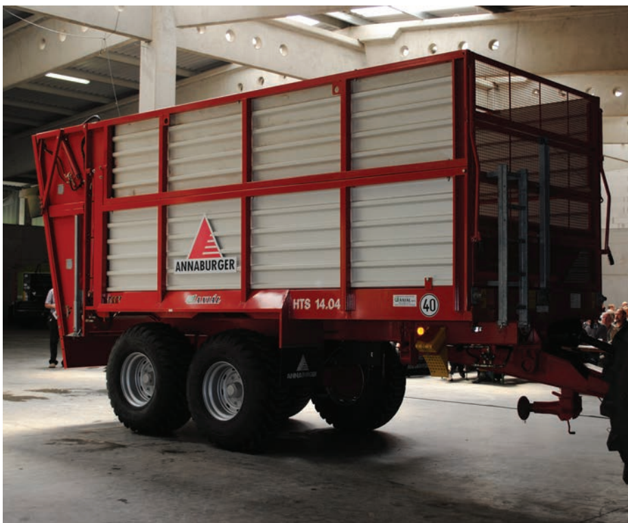
Számos olyan univerzális lehordószerkezetes szervestrágyaszóró van, amely gyári kiegészítővel átszerelhető silószállító pótkocsivá
