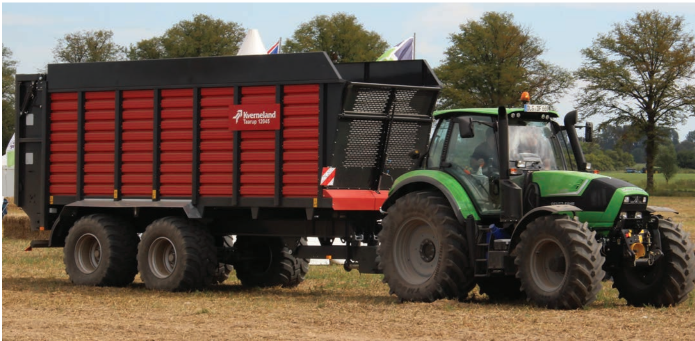
A homlokfal-kialakítás segíti a rálátást a raktérre, a lehajtható felső része pedig a kocsis feltöltését könnyíti meg
