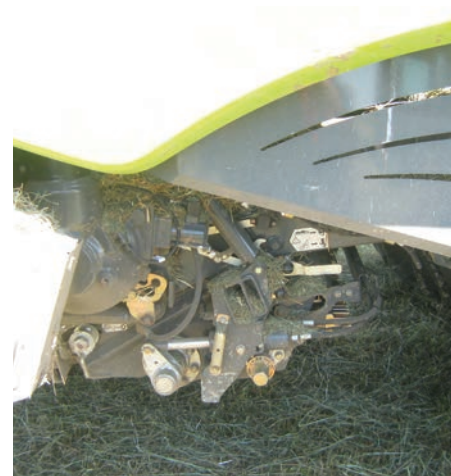
2/a-b. kép. Állandókamrás hengeres bálázó rotoros és a szögletes nagybálázó „FineCut” aprítóberendezése
