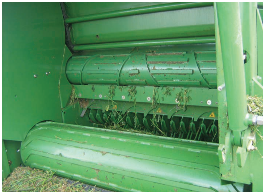
5. kép. A bálázók szeletelőberendezése szénakészítésben is megfelelő előaprítást végez
