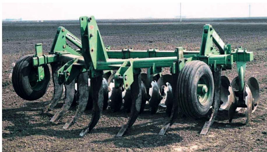
1. kép. Latar 3510, hazai gyártású, kompakt tárcsás lazító
