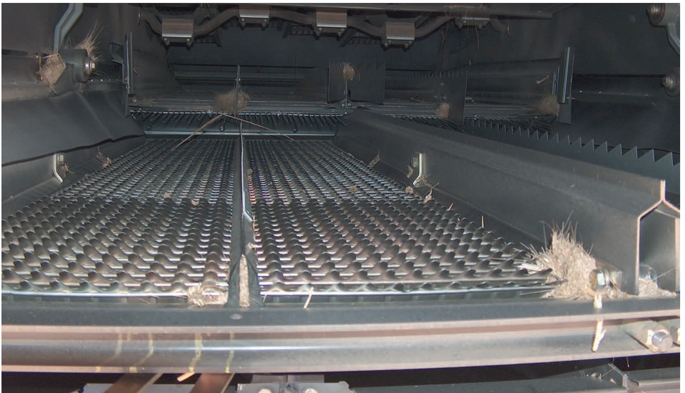
Az axiáldobos, rotoros és hibrid rendszerű arató-cséplő gépek szerkezeti részeiben sem maradhat semmiféle termény vagy növényi maradvány
