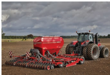
Pronto 6 DC PPF: vetés és műtrágyázás egy menetben
