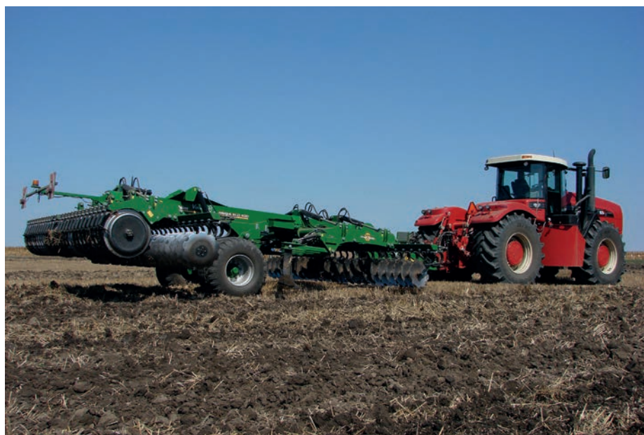
7. kép. Állítható szögállású tárcsatagokból álló tárcsasorokkal kombinált tárcsás lazító
