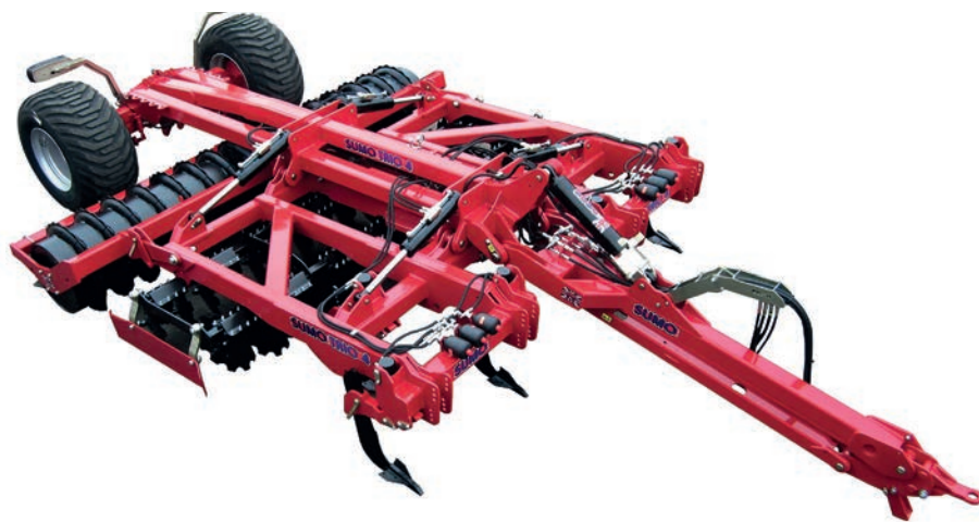
6. kép. Rövidtárcsával kombinált vontatott tárcsás lazító (fotó: sumo1.com)
