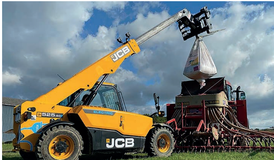
4. kép. JCB 525-60E ELECTRIC típusjelzésű teleszkópos rakodógép (forrás: www.fwi.co.uk)
