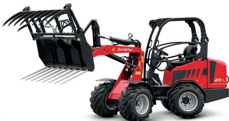
1. kép. Schäffer 23E villamos üzemű, kerekes mezőgazdasági rakodógép (forrás: www.schaeffer-lader.de )
