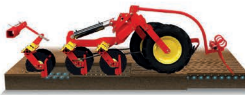
A vetéssel egyidejű műtrágya-kijuttatás gyors és megbízható műtrágya-feltáródást biztosít. Mivel a műtrágya a nyirkos talajba kerül, a feltáródás kevésbé függ a csapadéktól. A sor mellé kijuttatott műtrágya hatékonyabb, és növeli a terméshozamot
