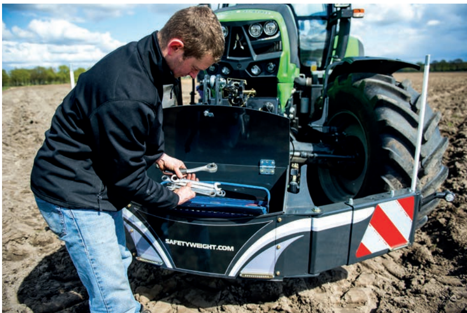
A traktorlökharítók pótsúlyként és szerszámtárolóként is funkcionálhatnak
