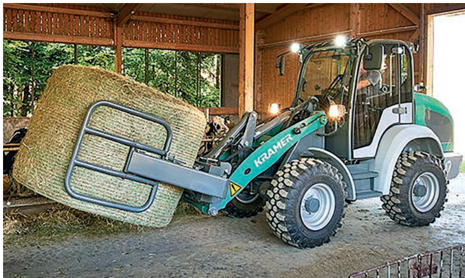
2. kép. Kramer KL 25.5e típusjelzésű, villamos üzemű kerekes rakodógép (forrás: https://whatsnewinfarming.co.uk/ )
