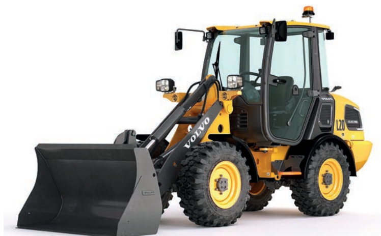
3. kép. Volvo L20 Electric típusjelzésű, kompakt kerekes rakodógép (forrás: www.volvoce.com/europe/en/products/... )
