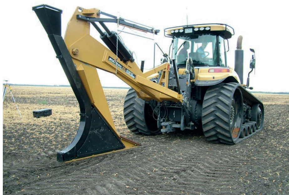
7. kép. Gumihevederes, nehéz univerzális traktor és alagcsövező rendszer
