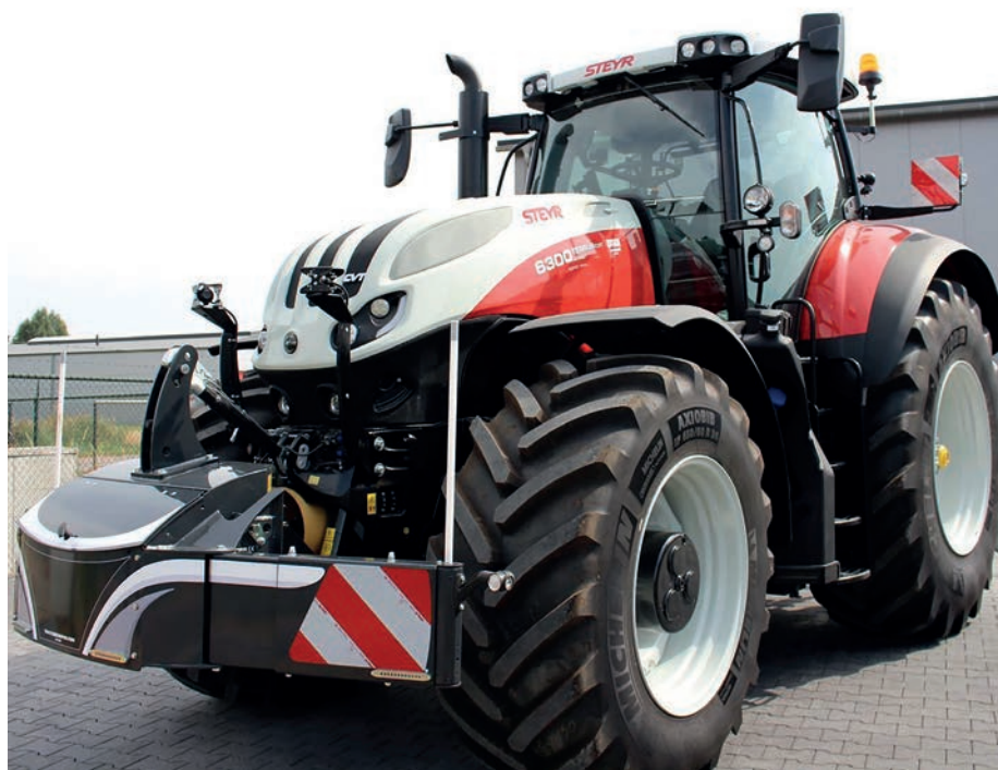
Holtterfigyelő kamerarendszerrel szerelt traktor
