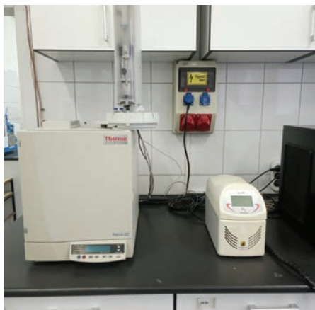
Gázkromatográf a zsírsav összetétel laboratóriumi meghatározásához
