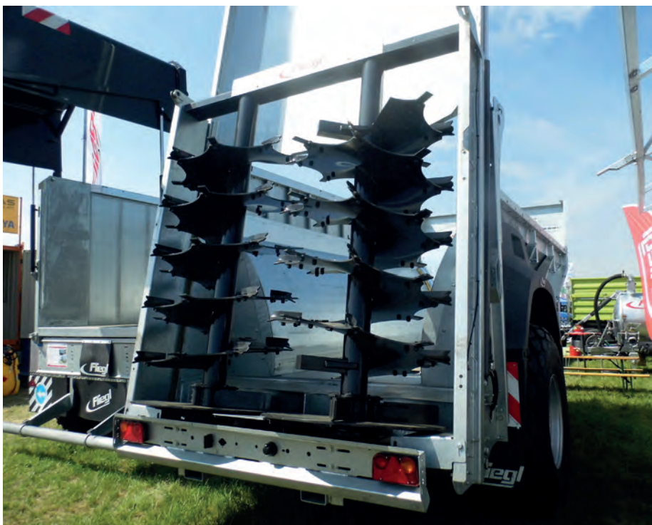
10. kép. Függőleges tengelyű, csigás, tépőfogas szórószerkezet
