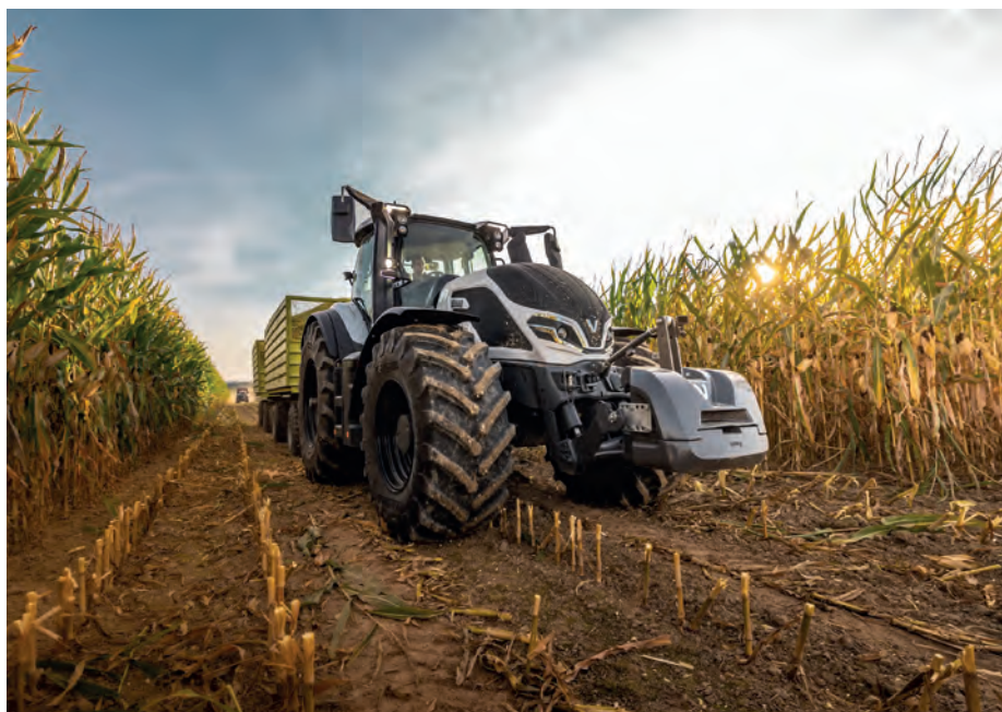
Az Aires légrugós mellsőhíd-felfüggesztés a hosszú tengelytávval kombinálva növeli a traktor vonóerejét
