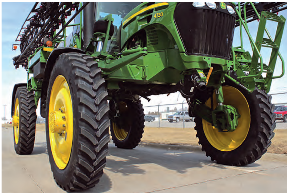
3. kép. Mitas HC 1000 mezőgazdasági abroncsok önjáró permetezőgépre szerelve (forrás: https://www.tiretechnologyinternational.com/news/ )
