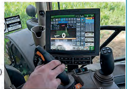
7. kép. Az adagmennyiség beállítása az újabb típusokon terminálon keresztül történik
