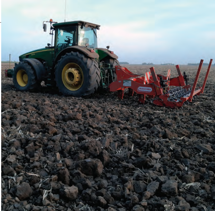
Száraz talajkörülmények között a tüskés hengerpárral dolgozó lezáróegység munkája hatástalan
