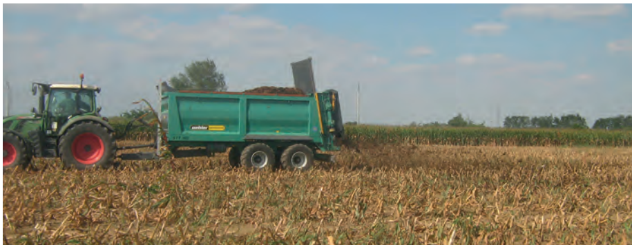
9. kép. Vízszintes szórószerkezetű, röpitőtárcsás gép munka közben
