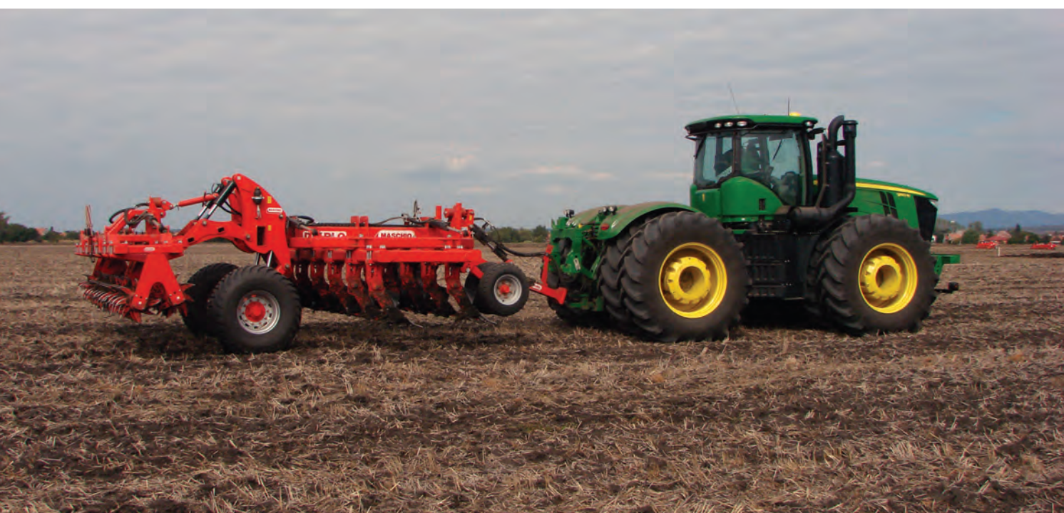
Vontatott, 13 késes, véső rendszerű lazító
