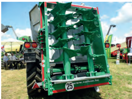
8. kép. Függőleges tengelyű szórószerkezet adapterszerű csatlakoztatása
