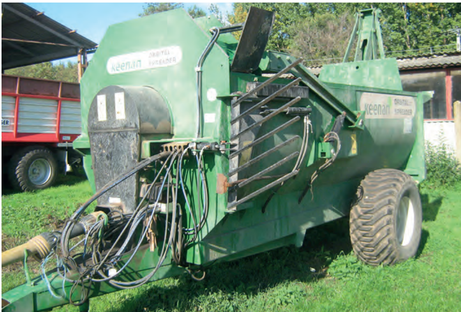
5. kép. Egytengelyes futóművel szerelt, oldalra szóró szervestrágya-szóró pótkocsi
