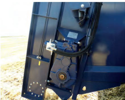
6. kép. A lehordószerkezet hidromotoros és homlokfogaskerekes hajtóműve
