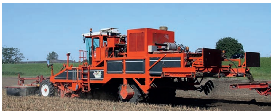
2. kép. Amac ZM4 gép alkalmazása tulipánhagyma felszedésére (forrás: www.agrifoto.nl)
