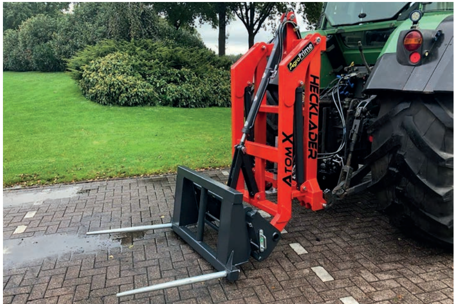
Gémkeretes konstrukció bálarakodó tuskével (fotó: agroprime.com.tr)
