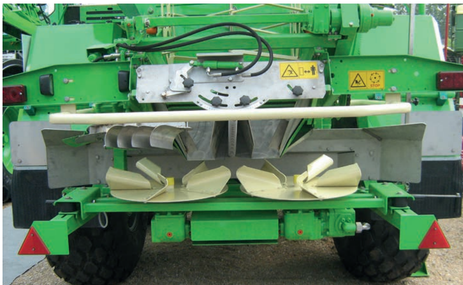
4. kép. Szórószerkezet-hajtást szabályzó és állító mechanizmus
