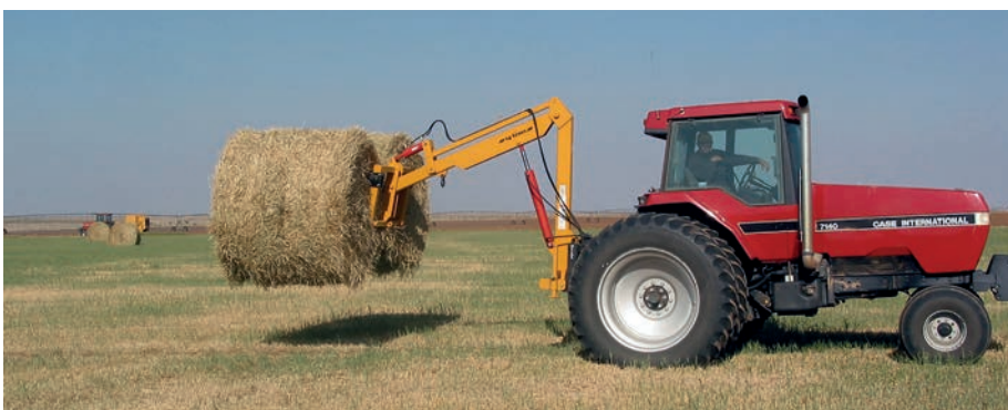
Hengeres bálák rakodása egygéműtoros farrakodóval (fotó: www.agkrane.com)
