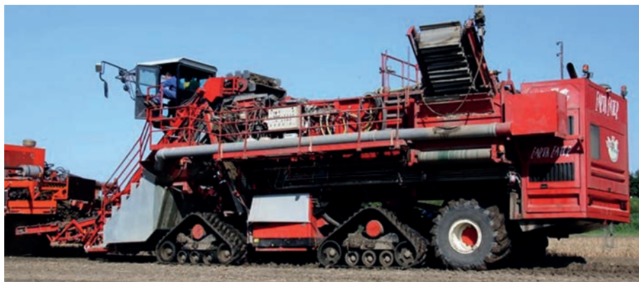
3. kép. Earth Eater Super II jelzésű önjáró tulipánhagyma-tisztító gép (forrás: www.agrifoto.nl)
