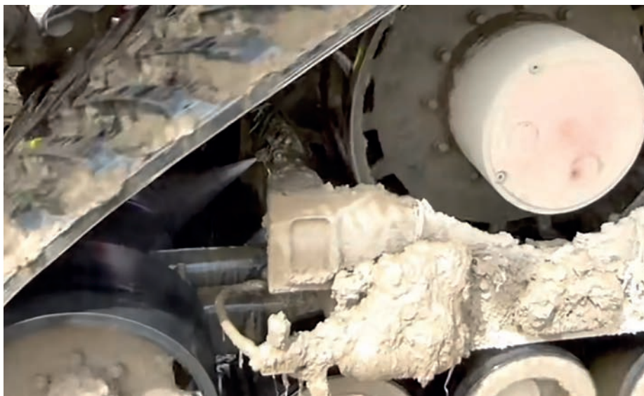
4. kép. Kerék-gumihevederes futómű hűtése nagy nyomású vízszugárral (forrás: youtu.be/wZ5MAr7d-5Y )
