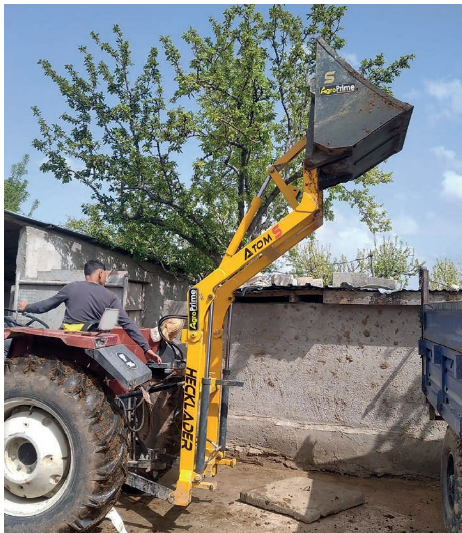
Gémkeretes rakodó nyitott traktorra szerelve föld rakodása közben (fotó: www.agroprime.com.tr)
