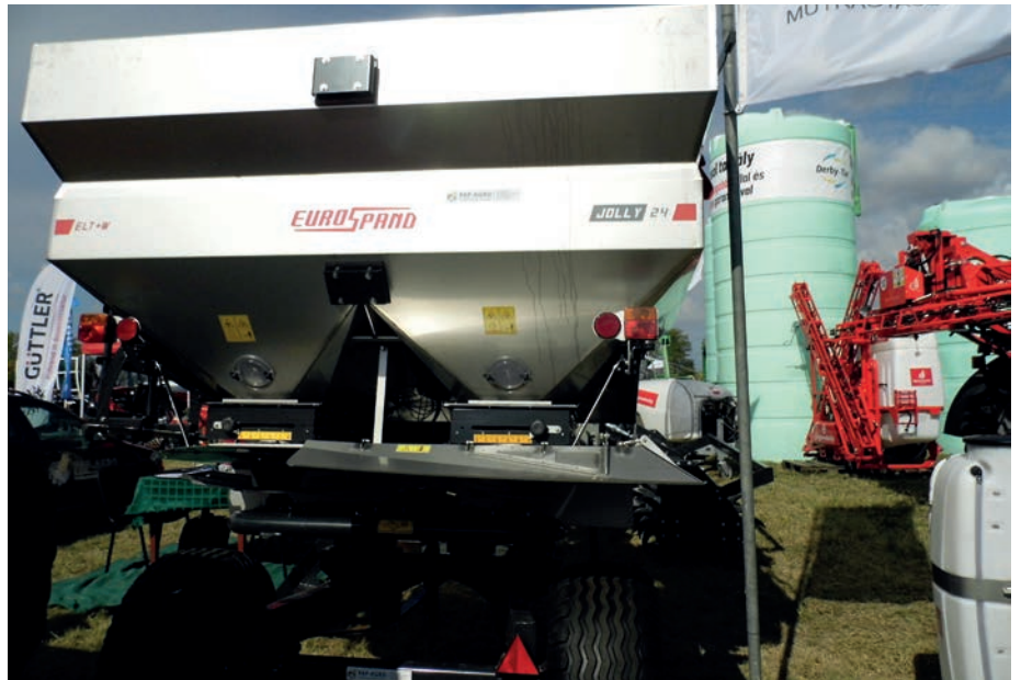
2. kép. A szilárdműtrágya-szórók konstrukciójánál, a funkcionális szerkezeti részeknél egyre inkább korrózióálló anyagokat, illetve festést alkalmaznak
