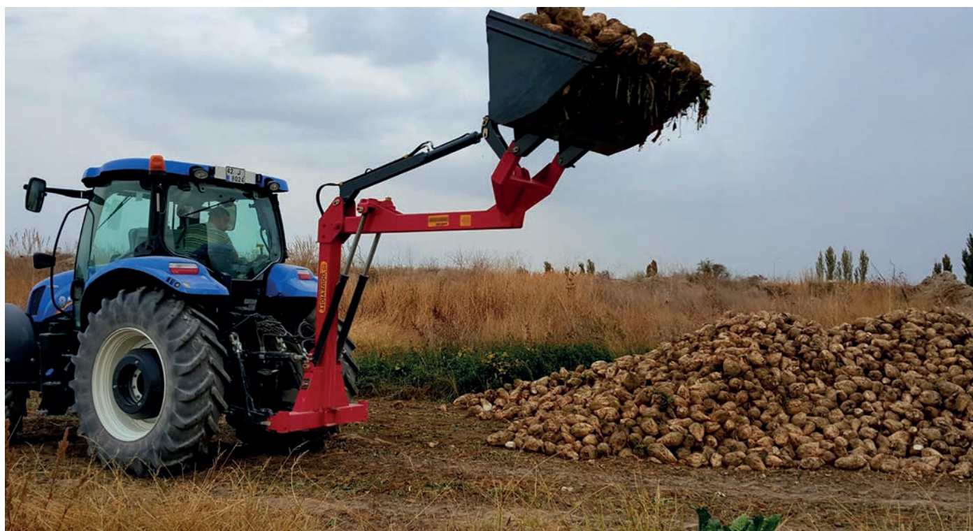
Egygémű farrakodó cukorrépa rakodása közben (fotó: www.oguztarim.com)
