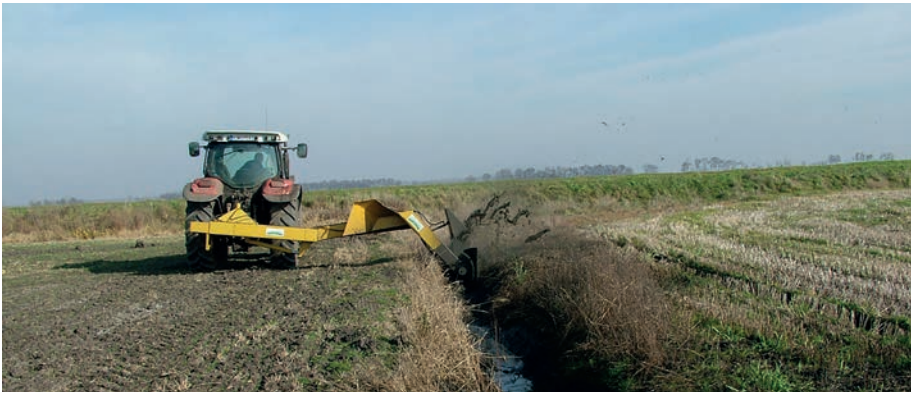
8. kép. Csatornatisztítás gépre szerelt rotoros eszközzel
