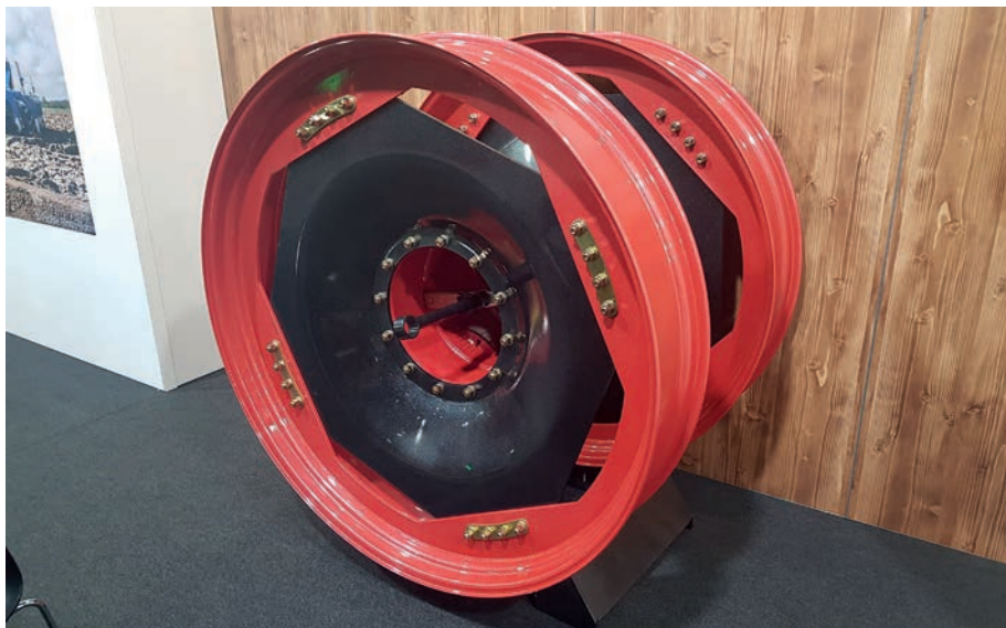
3. kép. Változtatható nyomtávolságú csőtávtartós ikerművelőkerék-felni (fotó: www.gruva.com)
