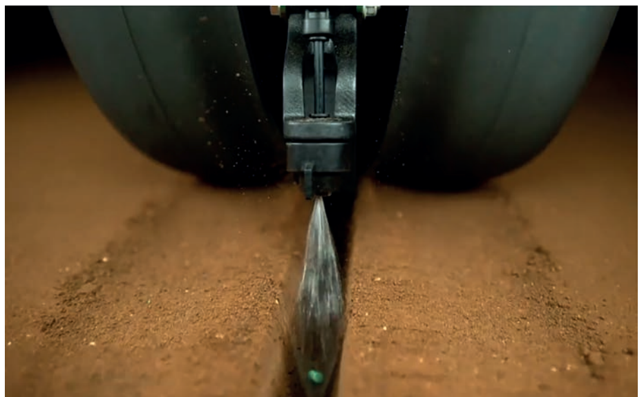
2. kép. John Deere ExactShot technológia az indító műtrágya elhelyezésére (forrás: agweb.com/news/machinery)
