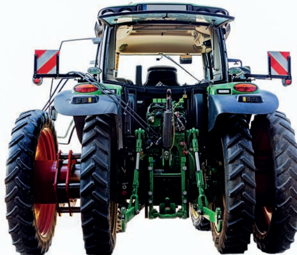
4. kép. Hidraulikusan állítható nyomtávolságú iker művelőkerék (fotó: beckloenne.de)
