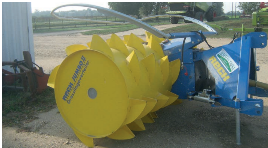
4. kép. A kések hengerek használata kedvezően alakítja a talaj szerkezetét a vízháztartás szempontjából is
