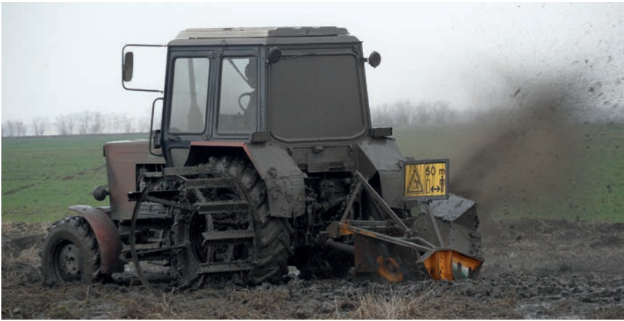
7. kép. Kéttorós csatornanyitó munka közben rácskerekes traktoron
