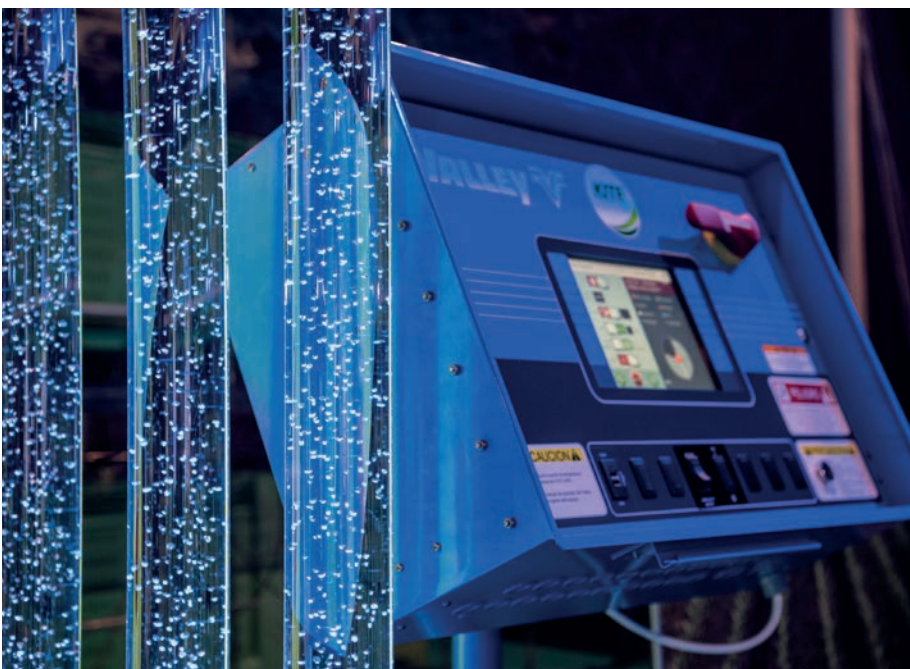
A KITE öntözésirányítási rendszere nemcsak az elmúlt időszakok vízmérlegének megállapítására alkalmas
