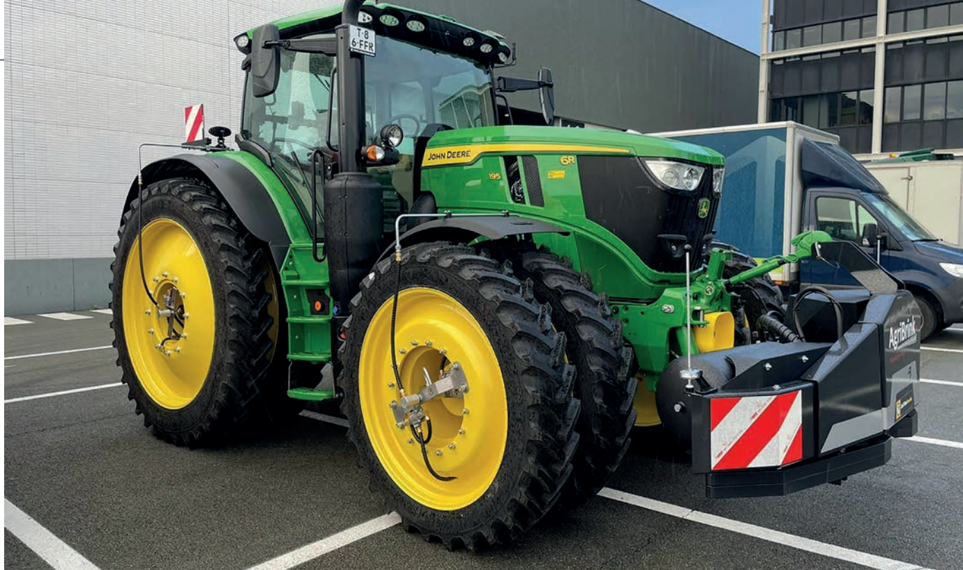
2. kép. Gumiabroncs-nyomásszabályozó rendszerrel szerelt iker művelőkerék (fotó: www.gruva.com)
