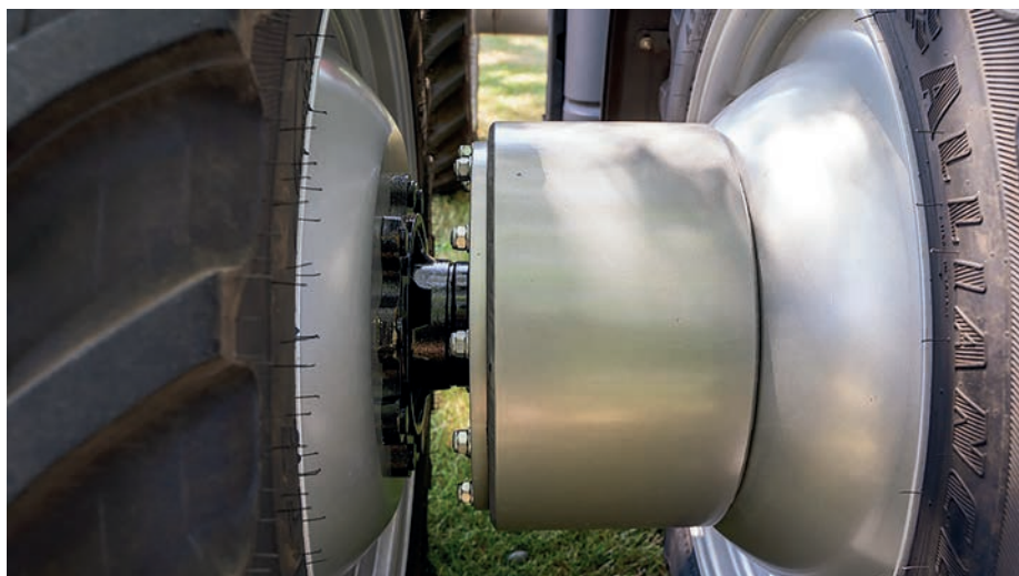
6. kép. A Bevri Duo Swing iker művelőkerék külső tagjának csapágyazása a távtartón (fotó: heuver.de)
