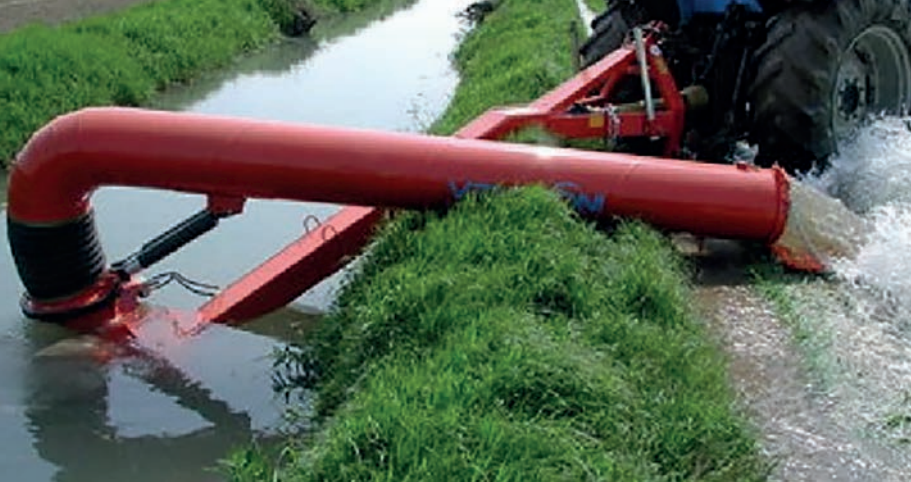
9. kép. A csatornák vízszint-beállítása, traktoros átemelőszivattyú munka közben
