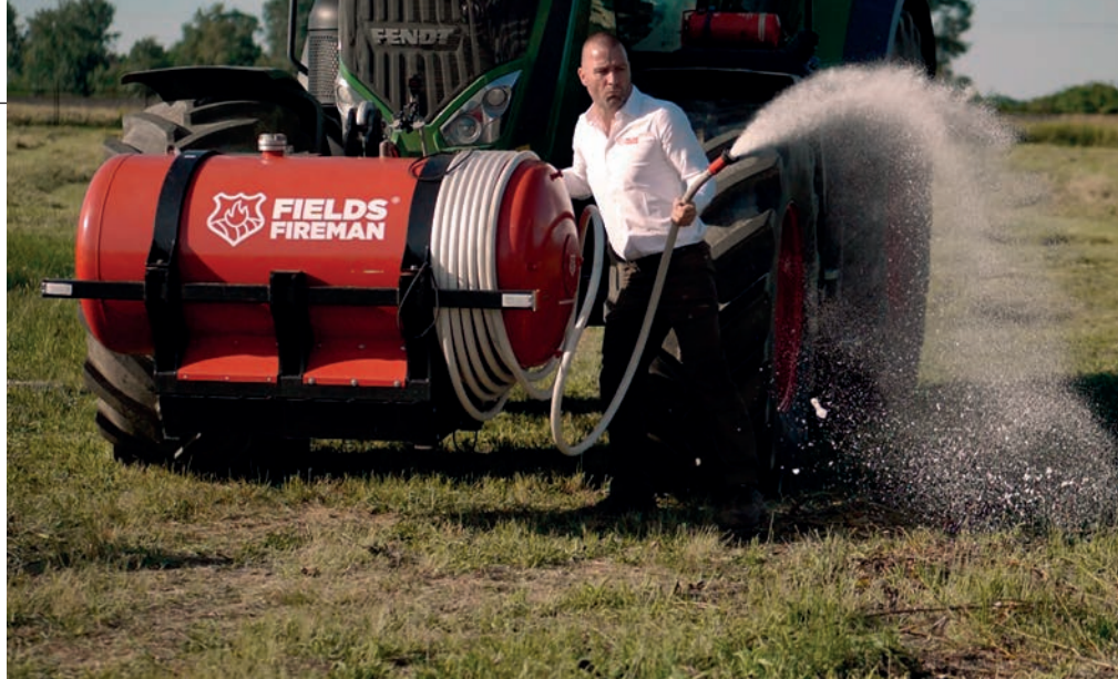
A Fields Fireman frontfüggesztésre kapcsolható tűzoltó berendezés (forrás: FIELDS FIREMAN PROJEKT Kft.)
