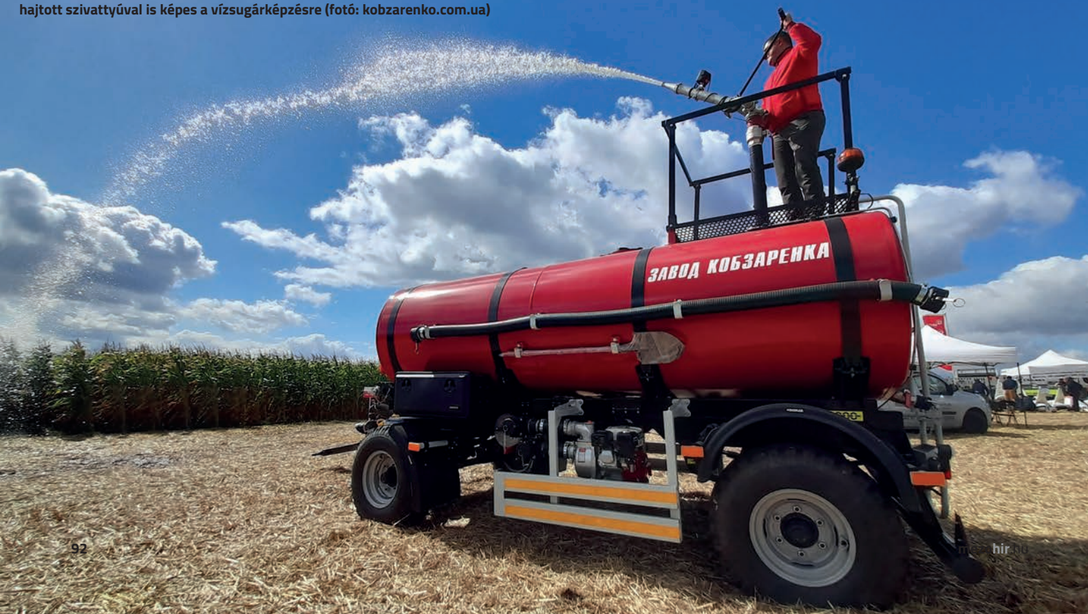
A Kobzarenko tartálykocsi a TLT-hajtású szivattyú mellett Honda benzinmotorral hajtott szivattyúval is képes a vízszugárképzésre (fotó: kobzarenko.com.ua)
