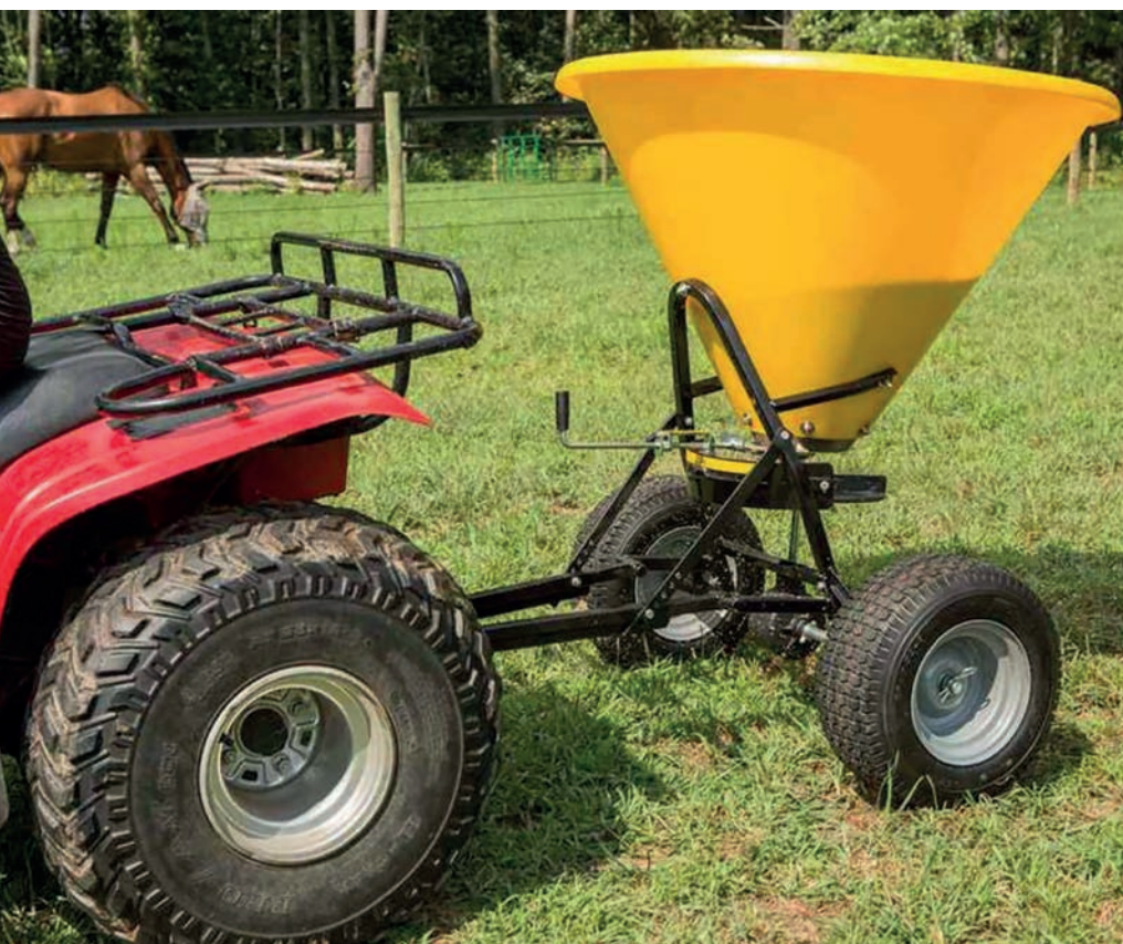
5. kép. ABI-BS-GD-339 típusú vontatott, járókerék-hajtású univerzális szórógép (forrás: abiattachments.com)
