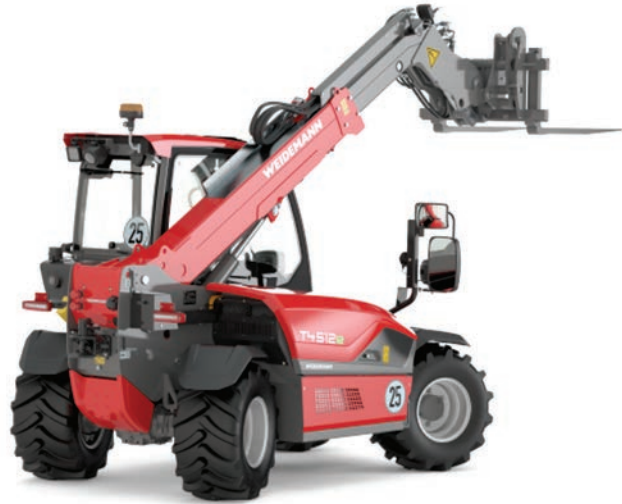
2. kép. Az új Weidemann T4512e villamos teleszkópos rakodógép (forrás: weidemann.de)
