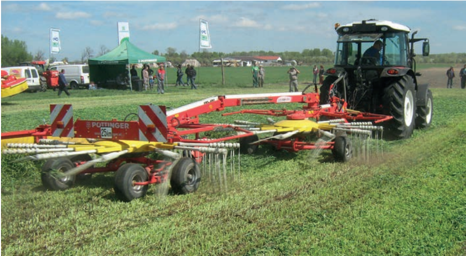
6. kép. A vezérelt ujjas forgórészeket bonyolult ikertandem futóművek támasztják alá
