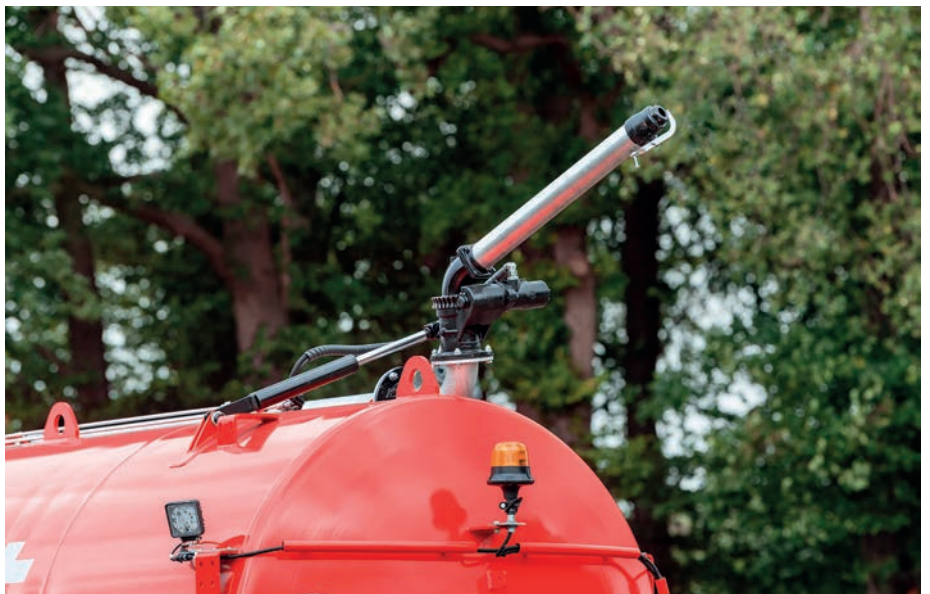
Az AquaLine vízszállító kocsi hidraulikusan, a traktorfülkéből 360 fokban forgatható vízágyúja (fotó: garant-kotte.de)
