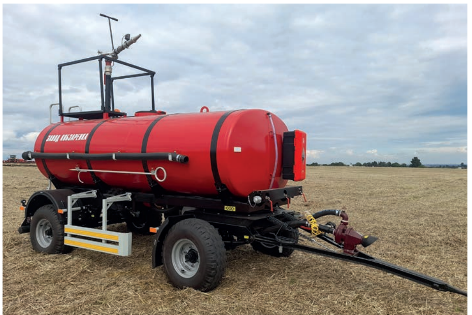
Az ukrán Kobzarenko vontatott tűzoltó tartálykocsija (fotó: kobzarenko.com.ua)
