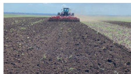
Cruiser XL – OptiCover henger és lúdtalp kapa – magágyszkészítésben
