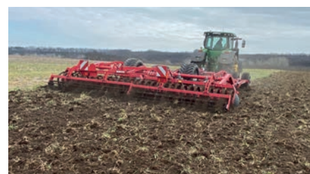
Cruiser 6 XL – kora tavasszal keskeny kapával az árvakelés bedolgozása
