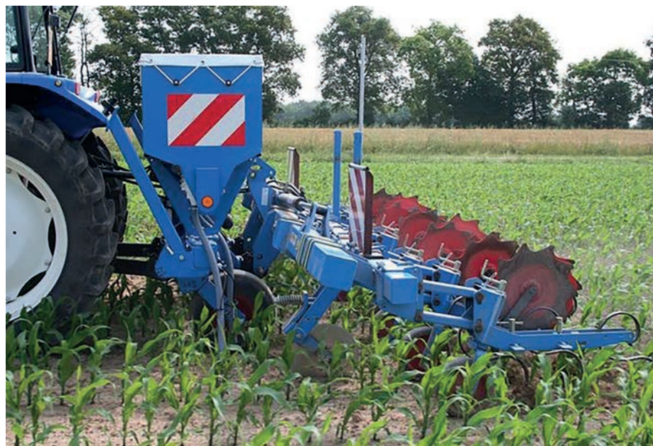
A sorközművelés igen fontos gyomszabályozási módszer a kapás kultúrákban, főleg ha egyúttal még a trágyázás is megoldható
