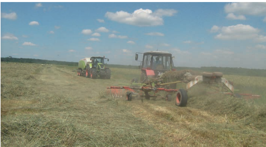
7. kép. A vezérelt ujjas rendrakókkal még a nagy teljesítményű szögletes bálázók leterheléséhez alkalmas gépek is összerakhatók
