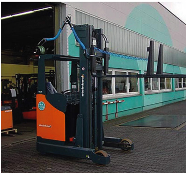
3. kép: Kamerával is felszerelt dupla palettás állványt kiszolgáló gép
