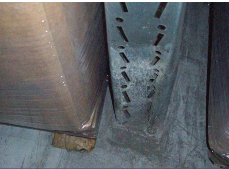
1. kép: Tolóoszlopos targonca által okozott sérülés
