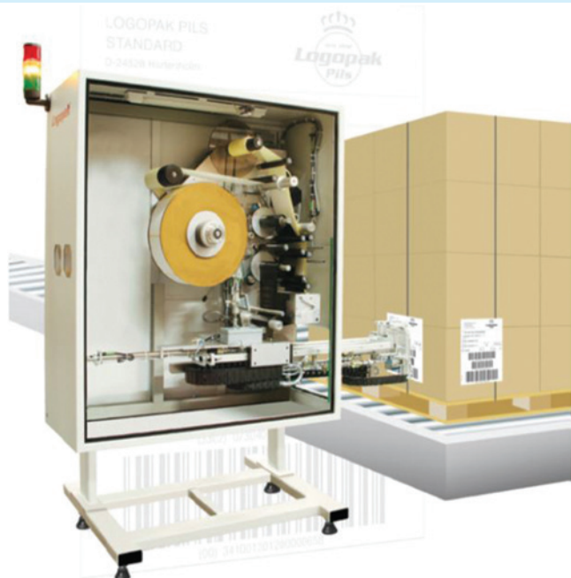
Logopak raklapcímkéző és jellemző címke a raklapon
