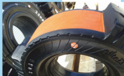
Egyedülálló kopáshatárjelzővel ellátott abroncs
