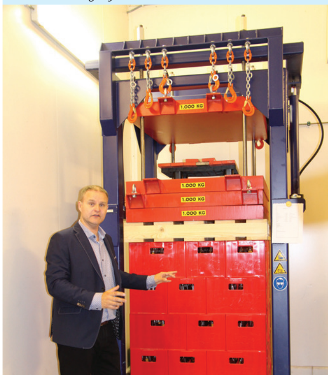
A rakat terhelését 1.000 kg lépcsőkben változtatják, és dinamikus igénybevételnek is kiteszik
