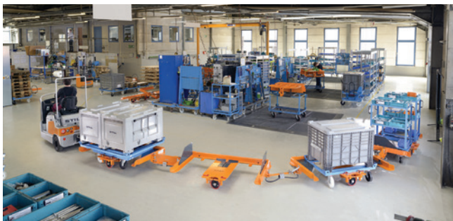
A STILL emelős vontatórendszer egy vontatójárműből és különböző vontatott elemek kombinációjából áll, mint pl. az emelős E-keret.
