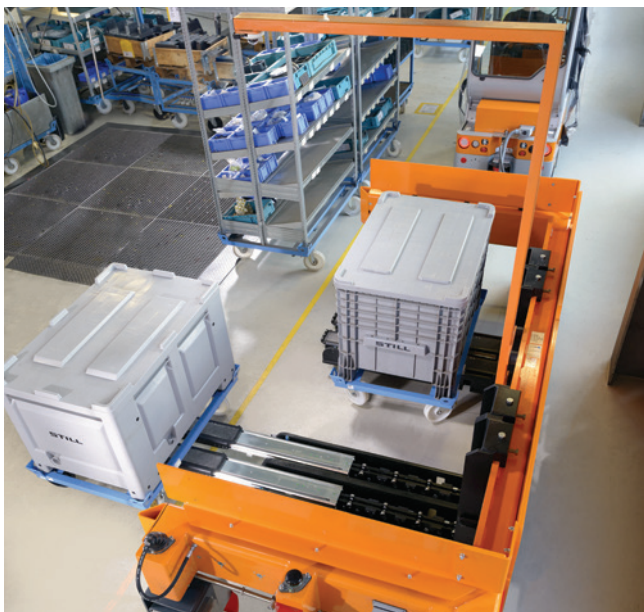
A szállítókoszokhoz alkalmazott automatizált fel- és lerakodórendszer megspórolja a rakodási területen a kellemetlen ki- és beszállást a járműről a kezelő számára.
