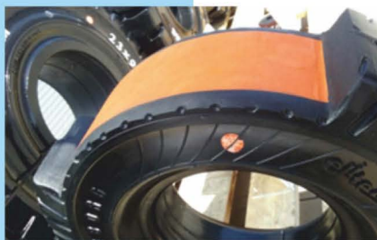
Egyedelülálló kopáshatárjelzővel ellátott abroncs
