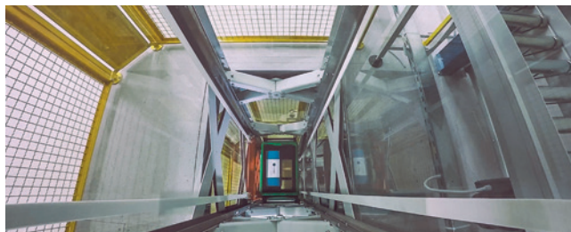
Függőleges anyagmozgató: sebesség: 3 m/s, emelési magasság: 3 m, gyorsulás: 3 m/s 2 teljes ciklusidő (beadástól beadásig): 8 s
