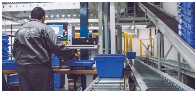
Az automata szállítópálya-rendszer a revizori állomáson dolgozók keze alá dolgozik
