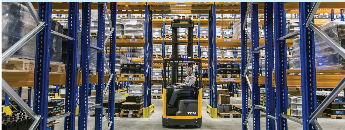
A normál tolóoszlopos targoncának el kell fordulnia a folyosói szállítás előtt
