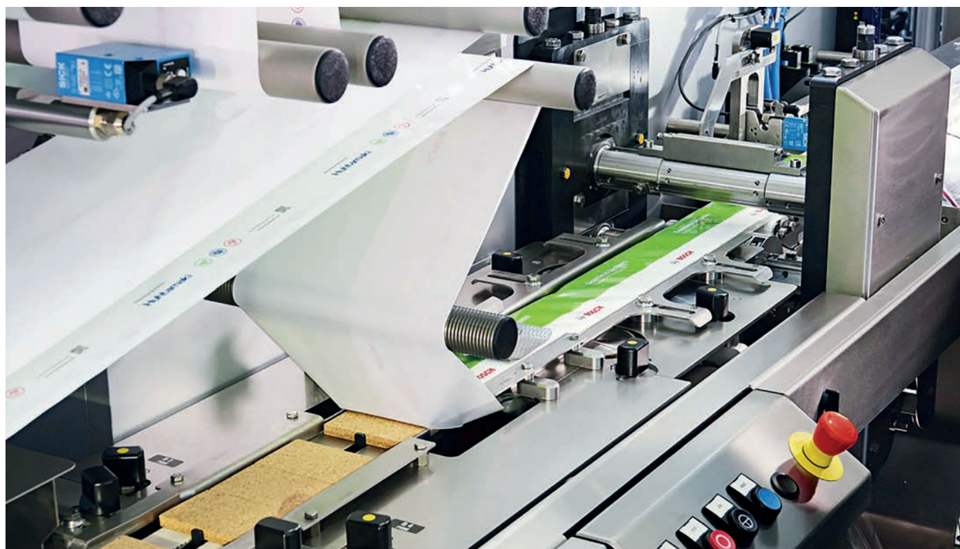
A tökéletes hegesztési varrat beállítása
