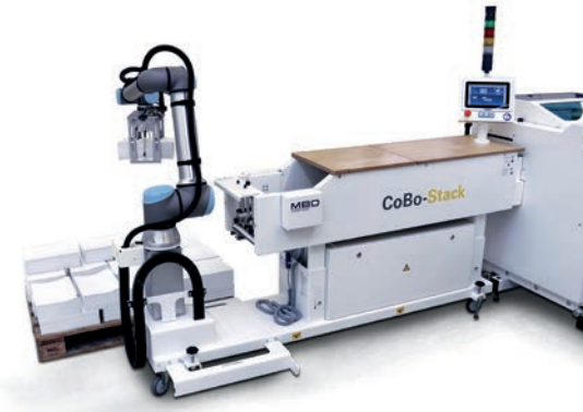
▪ Védőrács nélküli CoBo-Stack cobot
