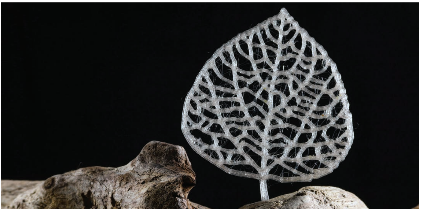
■ 3D-nyomtatott levél az új növényi alapú bioműanyagból (fotó: Alain Herzog, EPFL)
