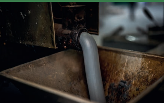
• Készül a regranulátum, mint értékes alapanyag
