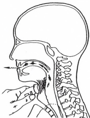
2. ábra Az elektrolarynx működési elve
