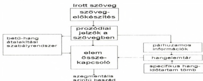
1. ábra A szintetizátor előkészítő részegységei
