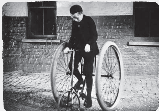
John Boyd Dunlop gumikerékkel felszerelt triciklije 1888-ból
