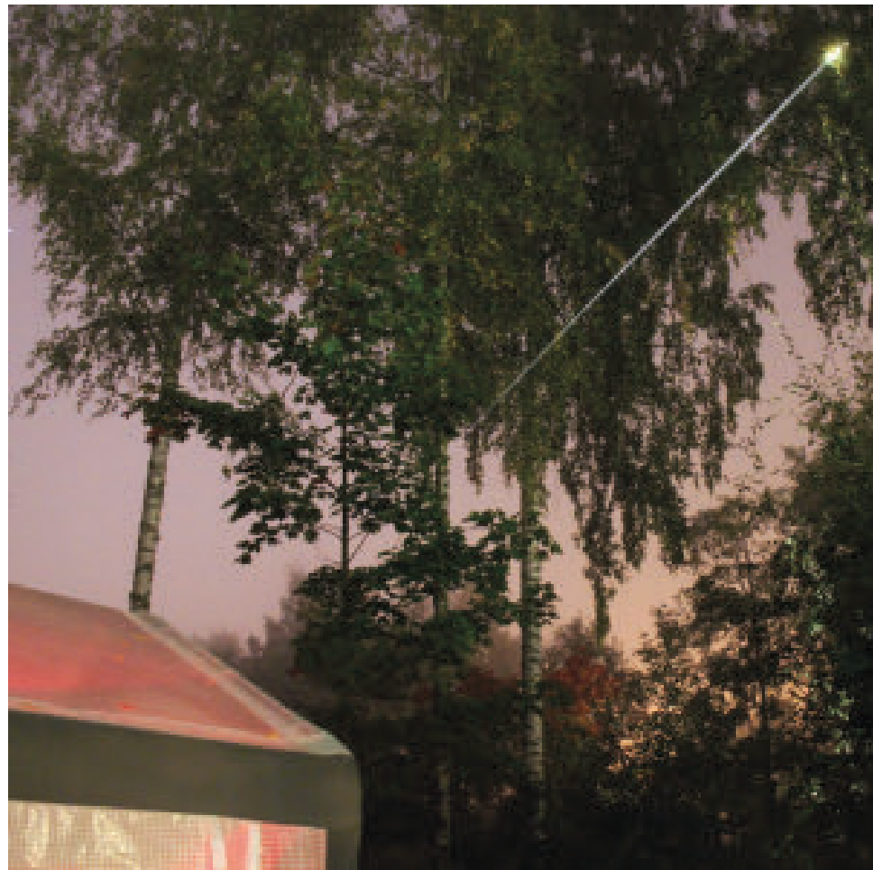
Hosszú expozíciós idővel készült felvétel a finnországi fa felméréséről. A kép bal alsó sarkában a lézerszkennerek védelmére emelt sátor látható, innen jön ki a fényes lézersugár, amely jobboldalt fent egy pontot világít meg a vizsgált fa koronáján. A hosszú záridő kiemeli a műszer fényét, a háttér is emiatt világosabb, mint a valóságban. FOTÓ | MIKA KARJALAINEN, FGI
