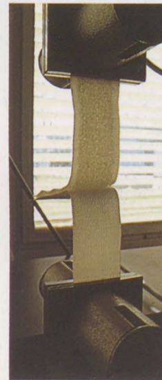
A tépőzár szakítószilárdságának vizsgálata SZALAY LÁSZLÓ felvételei
