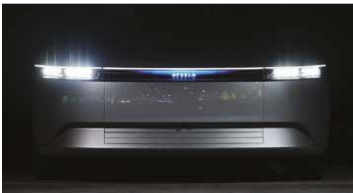
AZ „AFEELA” FELIRAT A CSÍKSZERŰ KIJELZŐNEK CSAK AZ EGYIK, STATIKUS ÁLLAPOTA; ITT AKÁR REKLÁMFILM IS FUTHAT
