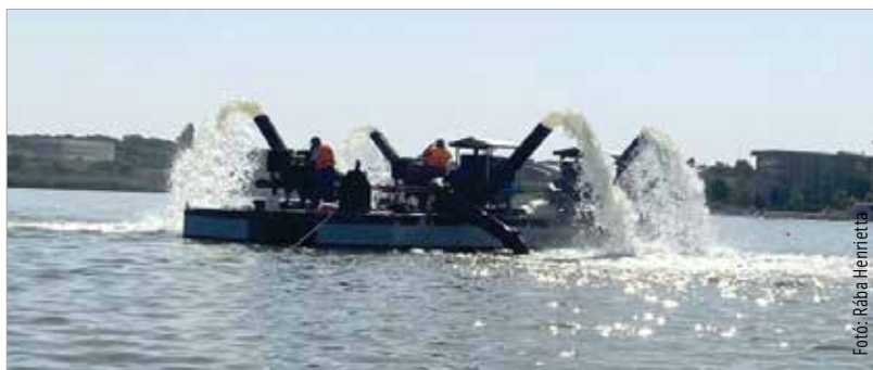
A négy szivattyú egy köbméter vizet forgat át másodpercenként
