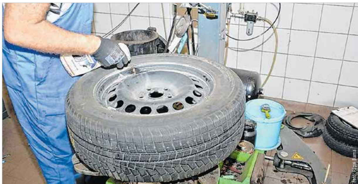
A téli gumi barázdáinak optimális esetben négy-öt milliméter mélynek kell lenniük, de semmiképpen nem lehetnek kisebbek 1,6 milliméternél
