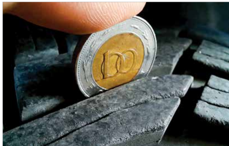
A százforintos érme ezüst karimája négy milliméter. Ezt a téli gumik profilmélységének gyors ellenőrzésére használhatjuk.
