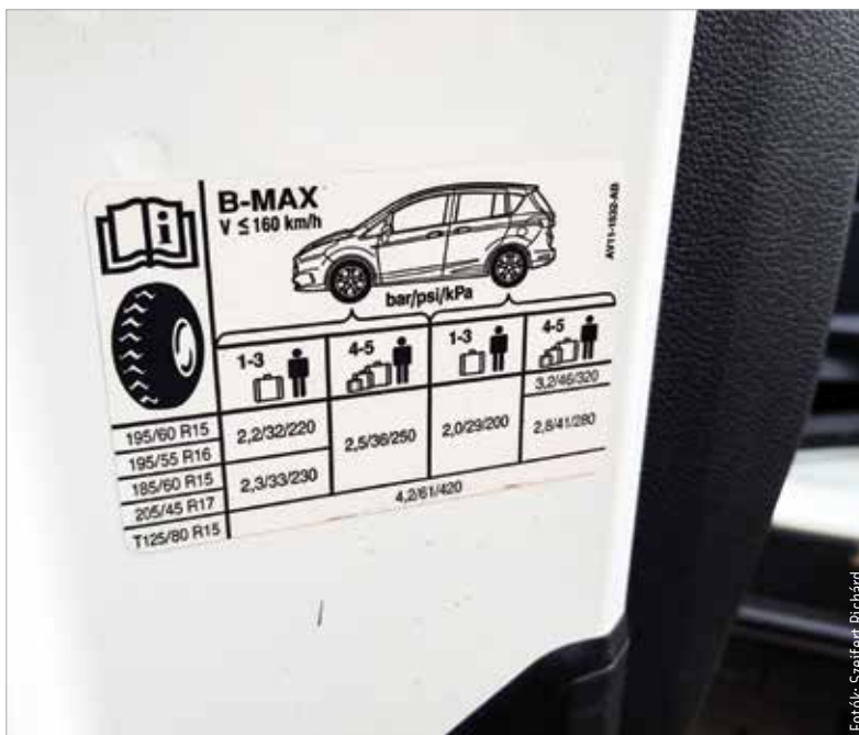
Az általában a vezető felőli első ajtó környékére vagy a tanksapka ajtajának belső oldalára ragasztott matricáról is olvashatjuk a megfelelő guminyomás értékét
