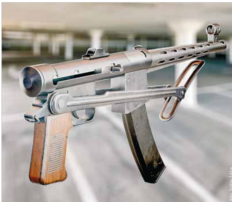
A Kucher József által tervezett K1 nevű géppisztoly nem sokban tért el a szovjet társától, elsősorban a visszahajtható válltámaszban különbözött
