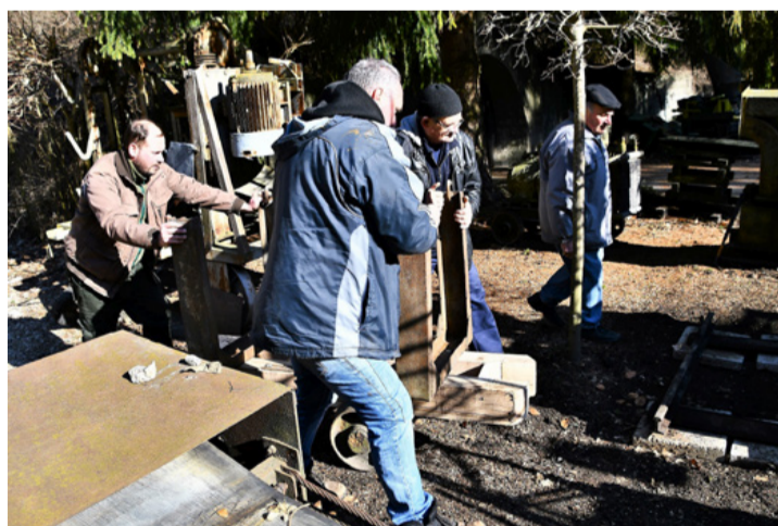
Nem könnyű a „nevelőszülők” sorsa. Egyre többen vállalkoznak a feladatra. Bencsai Antal (képünkön balra) kérdésünkre elmondta, hogy az elkorhadt faszervezet helyére jó minőségű tölgyfát tett, majd alaposan letisztította a vas részeket, a kerekeket. A csillére egykor rátették a fa vagy vas elemeket, a láncsal rögzítették, majd a felhasználás helyére tolták. Ma már a múzeum egyik régi kiállítási tárgya. (Fotó: Györkös)
