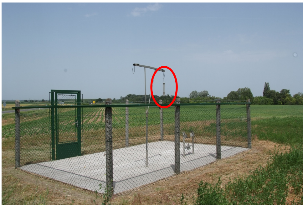
9. ábra. A C típusú állomás, a piros karikában a PorTL patron védőcsőben
