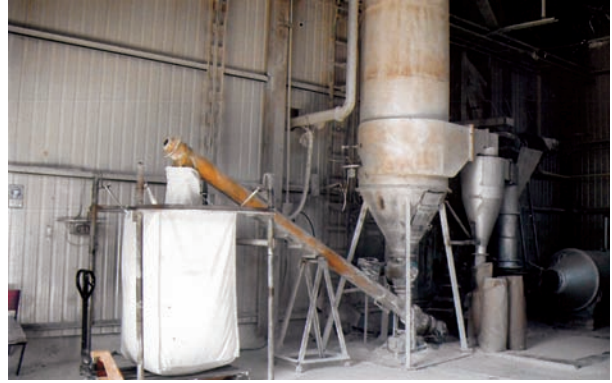
Feldolgozóüzem késztermékek kiserelése Big-Bag konténerbe
