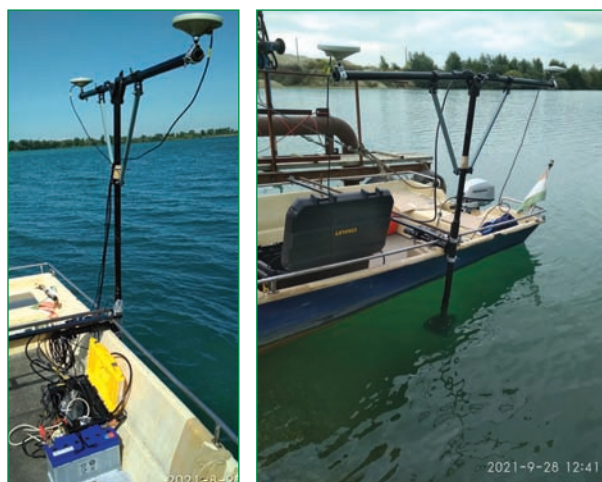
2. ábra: A mederfelérésre összeállított többsugaras ultrahangos mérőrendszer
