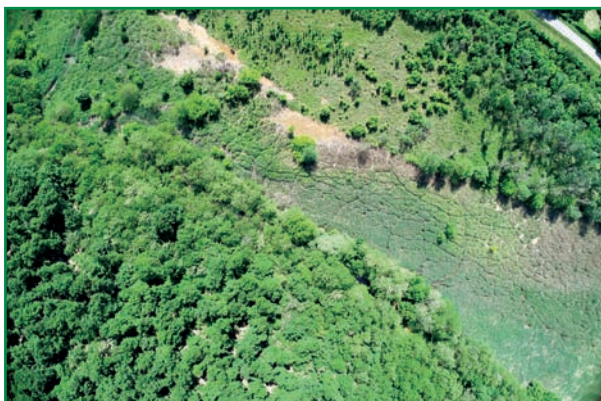
2. ábra: Felszíni erózió megjelenése a Recsk-I. bányatelek H11 jelű meddőhányó területén (Mályinkó Z. megfigyelése alapján)
