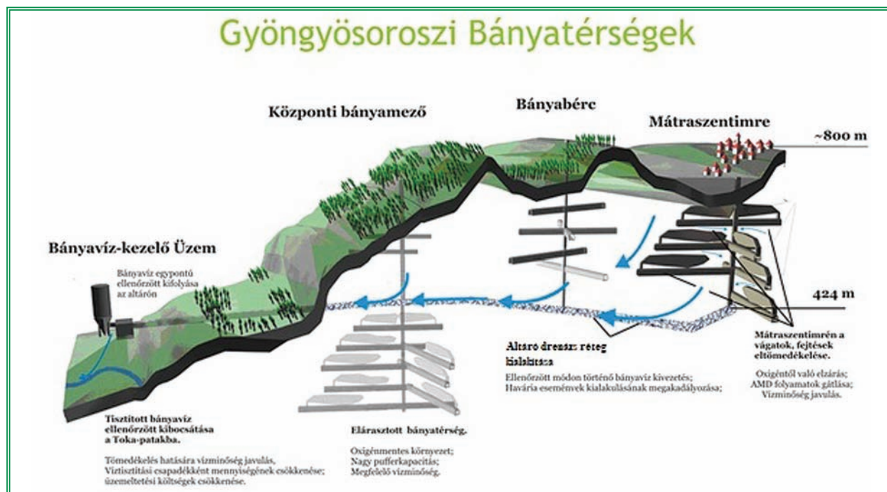
4. ábra: Gyöngyösorsoszi ércbánya végleges bezárási elvi koncepciója
