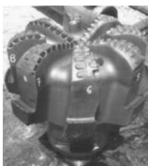
19. ábra: 18 1/2" FT816 fűró állapota kiépítés után
