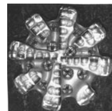
23. ábra: 8 1/2" FT813 fűró állapota kiépítés után
