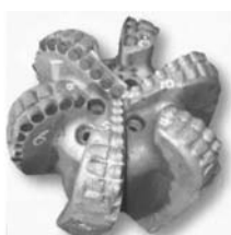
20. ábra: 13 1/8" FT616 fűró állapota kiépítés után
