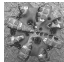
21. ábra: 8 1/2" FT813 fűró állapota kiépítés után
