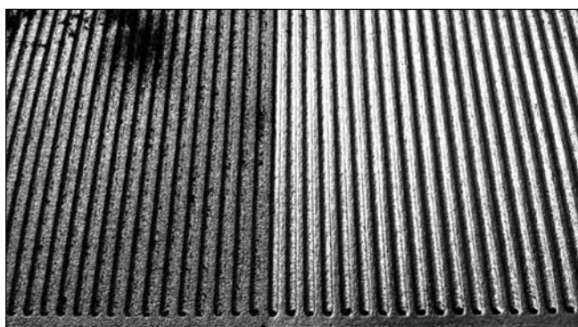
■ 5. ábra. VOXELJET 3D nyomtatási technológiával készített homokformába öntött öntvény felületi minősége a forma grafitos fekecslése nélkül (balra) és fekecslése
