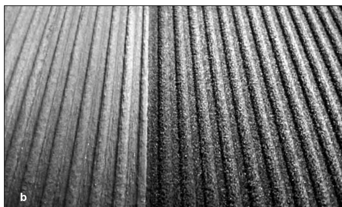
■ 4b ábra. VOXELJET 3D nyomtatási technológiával készített homokforma felületi minősége grafitos fekecslése (balra) és fekecslés nélkül
