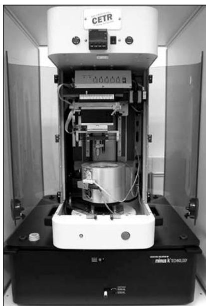
10. ábra. CETR UNMT-1 moduláris mikro-nano felületvizsgáló berendezés
