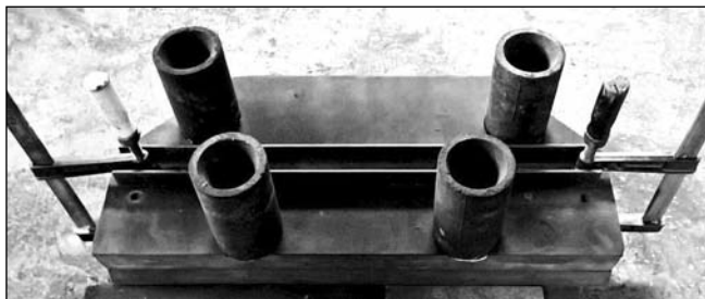
■ 6. ábra. VOXELJET 3D homoknyomatási technológiával és 4 szekciós beömlőrendszerrel gyártott homokforma öntésre előkészítve
